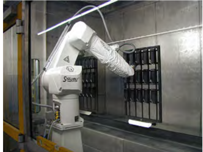
Abb. 9: Nassabscheidung mit Roboterapplikation
