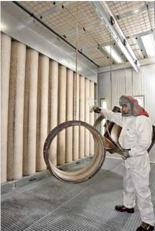
Abb. 8: Trockenabscheidung mit Rotationsbürsten
