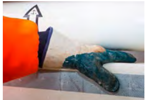
Abb. 24 Quetschstelle zwischen Zylinder und Rahmen
