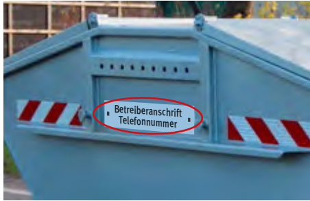
Abb. 26 Absetzbehälter mit Sicherheits- kennzeichnung
