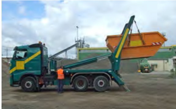
Abb. 32 Aufnehmen eines leeren Behälters
