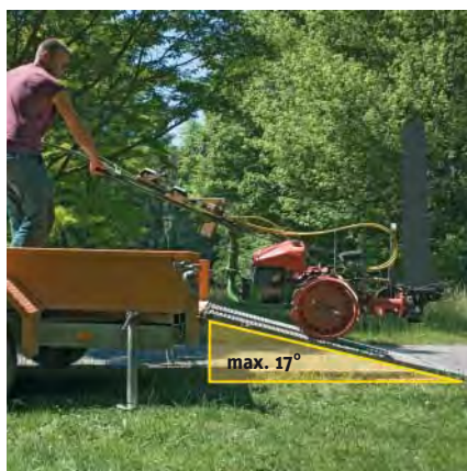
Neigungswinkel der Ladeschiene maximal 17^\circ
