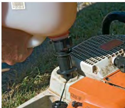
Betanken mit Sicherheits-Einfüllstutzen
