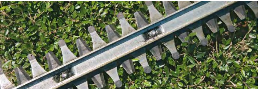
Stumpfe Messerüberstände verhindern schwere Verletzungen im Beinbereich
