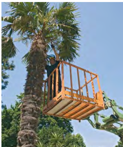
Arbeitsplattform am Frontlader
