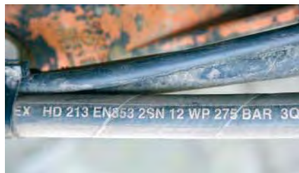
Beschriftung auf der Schlauchleitung
