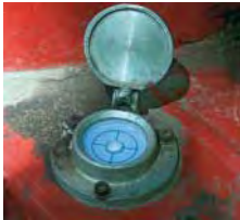
Libelle zur Überprüfung der waagrechten Aufstellung
