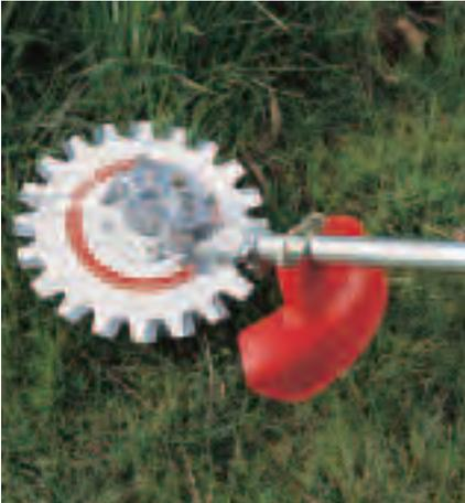
*Mehr Sicherheit bietet ein Freischneider, der nach dem Heckenscherenprinzip arbeitet. Durch die gegenläufig schneidenden Messer werden Schnittgut oder Fremdkörper nicht fortgeschleudert.*
