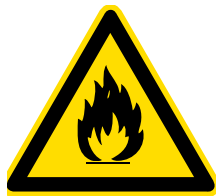
Warnzeichen W 1 Warnung vor feuergefährlichen Stoffen
