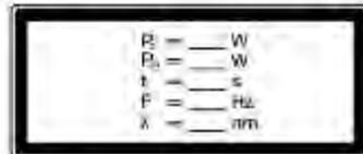
7 Beispiele einer Kennzeichnung eines Lasers der Klasse 4
