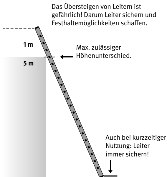
Abb. 9 Anlegeleiter als Verkehrsweg
