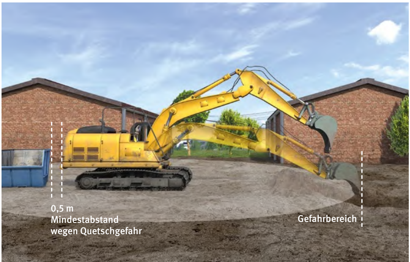
Abb. 72 Gefahrbereich und Quetschstelle beim Betrieb von Erdbaumaschinen
