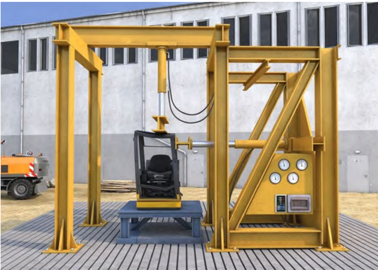
Abb. 81 Baumusterprüfung ROPS (Überrollschutzkonstruktion)
