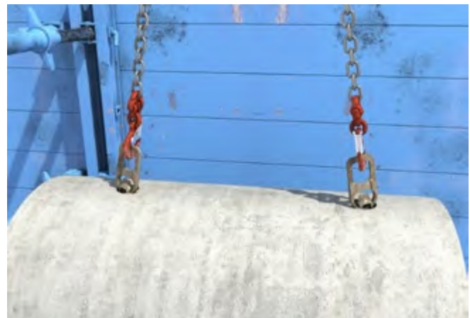
Abb. 86 Formschlüssig wirkende Lastaufnahmemittel (Kugelkopfanker)
