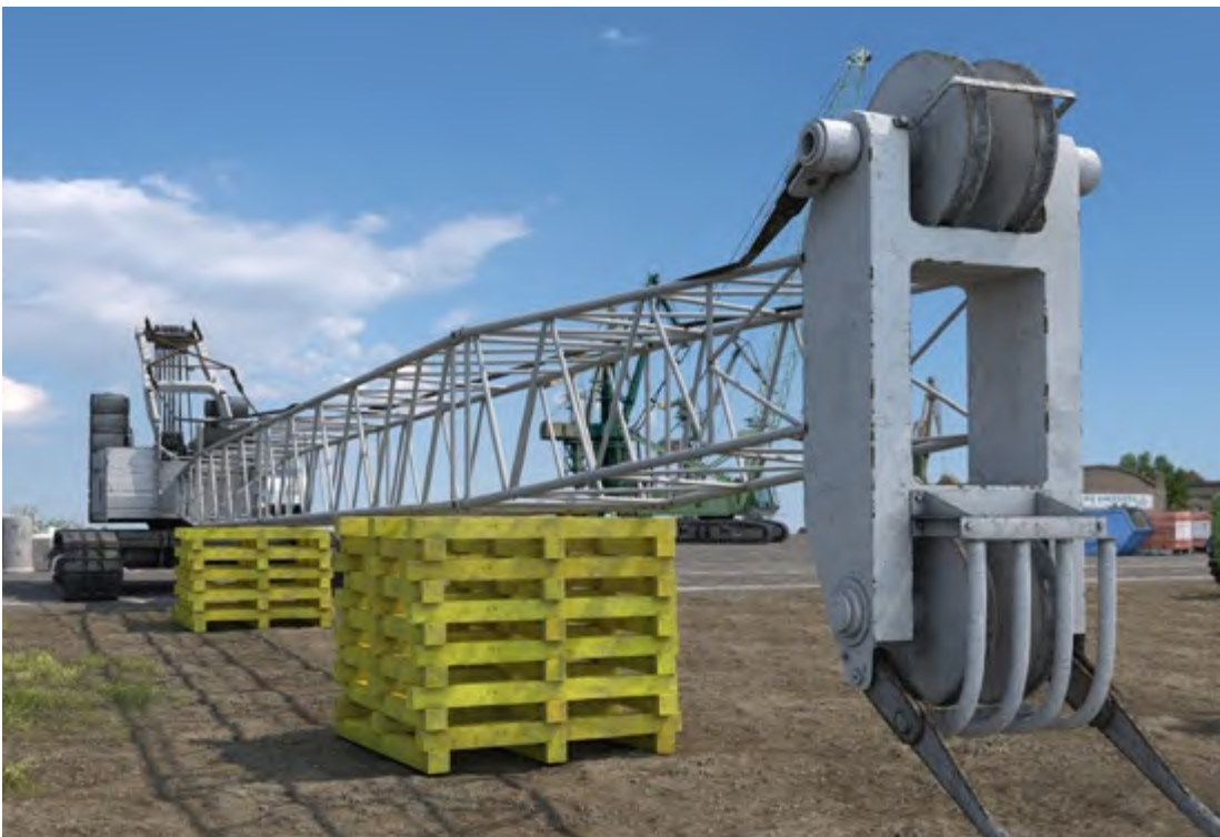
Abb. 133 Auf Pallungen abgelegter Ausleger eines Seilbaggers
