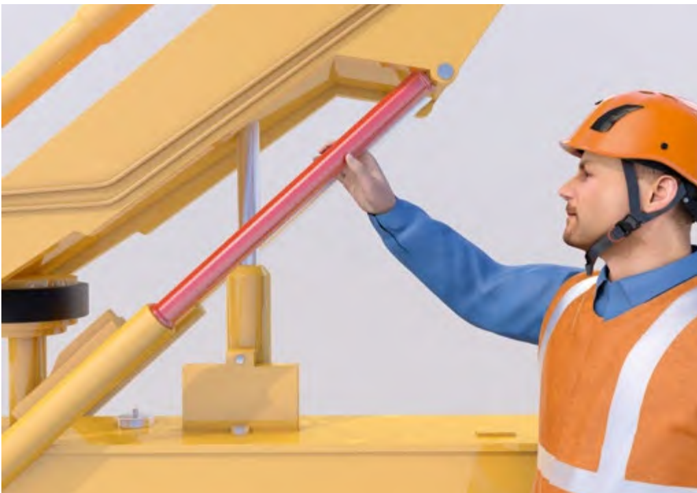
Abb. 95 Formschlüssige Sicherung des Hubgerüsts durch Abstützmanschette
