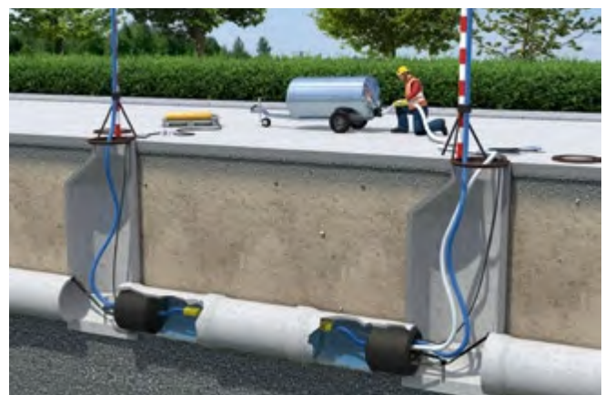
Abb. 120 Durchführung einer Wasserdruckprüfung
