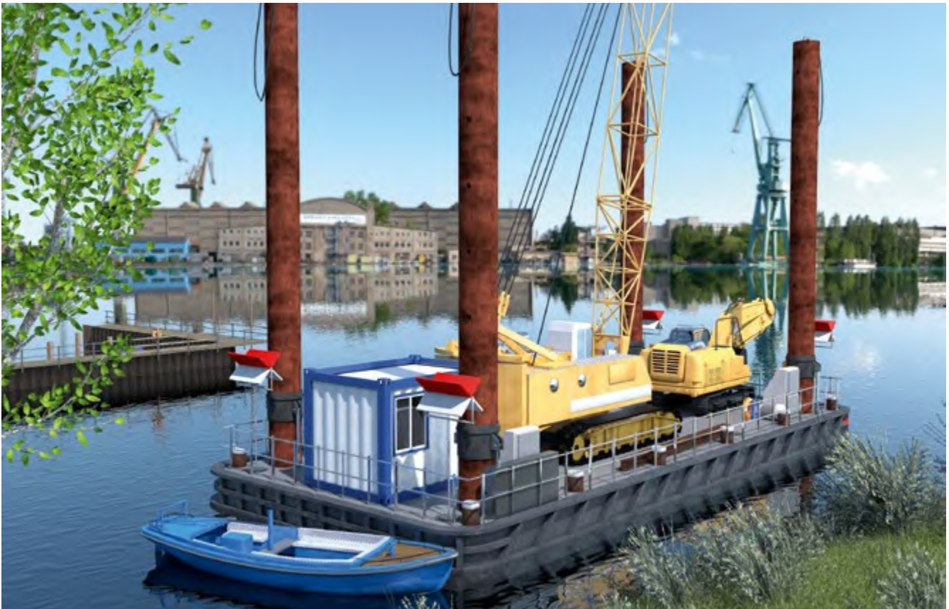
Abb. 146 Schwimmendes Gerät mit Seilbagger an Bord
