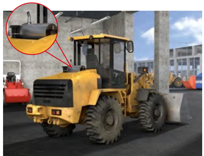
Abb. 96 Nachträglich montierter DPF ohne Beeinträchtigung der Sicht
