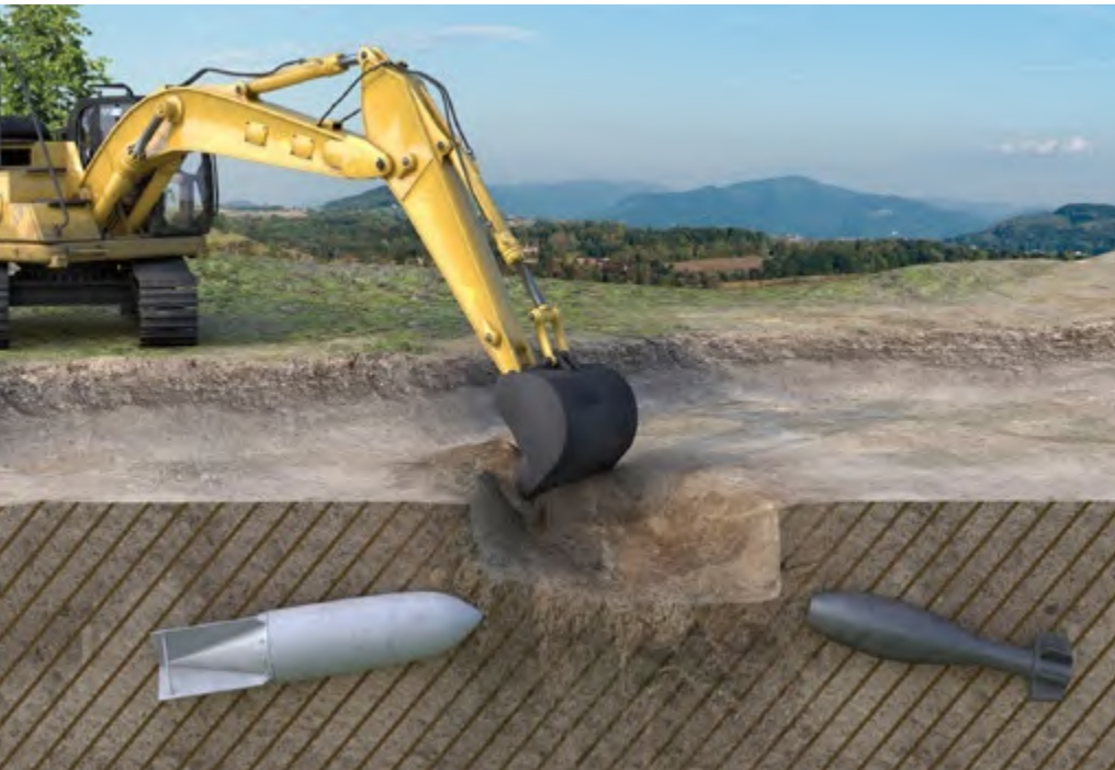
Abb. 22 Kampfmittel im Baugrund
