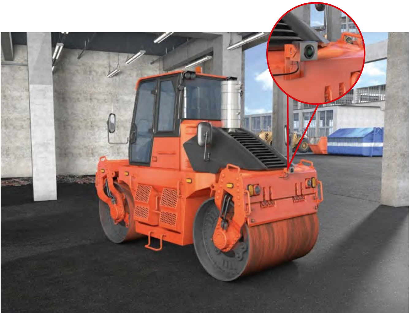
Abb. 97 Sichteinschränkung durch nachgerüsteten DPF wird durch technisches Hilfsmittel ausgeglichen, hier durch Kamera-/Monitorsystem.
