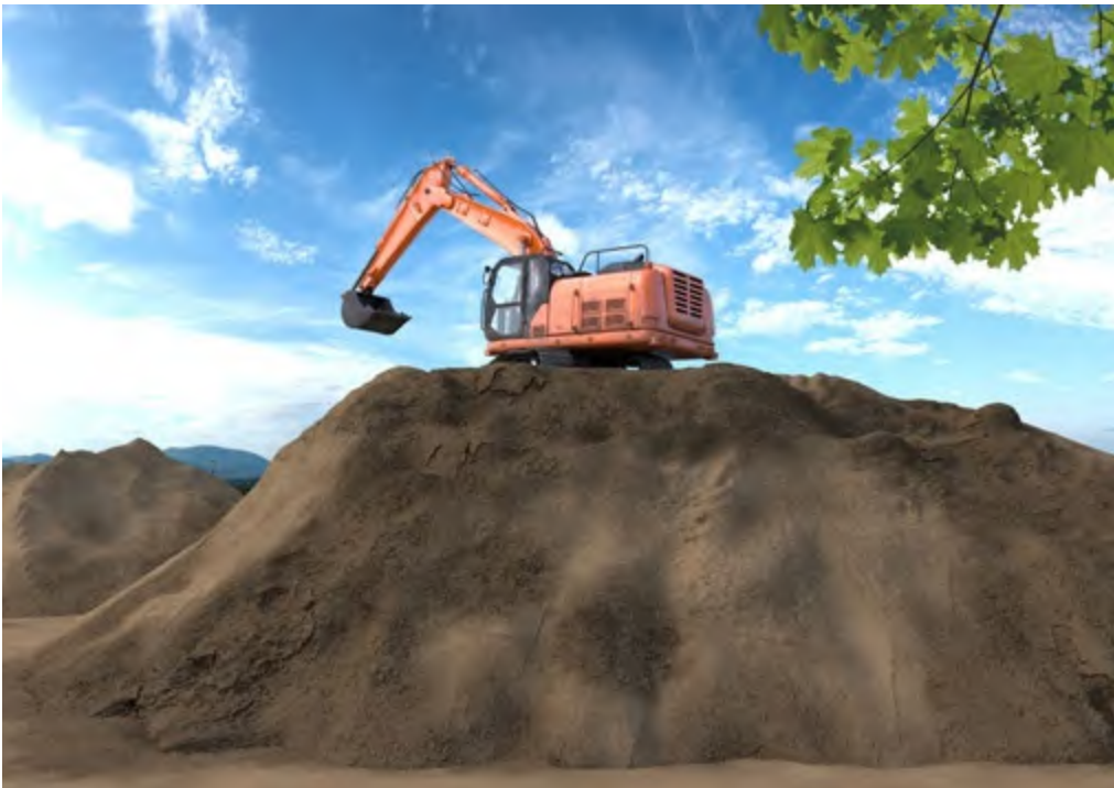
Abb. 79 Kettenbagger sind für den Einsatz auf Dämmen oder Bodenmieten geeignet
