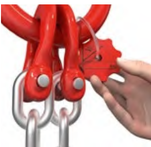
Abb. 57 Kennzeichnung eines Kettengehänges
