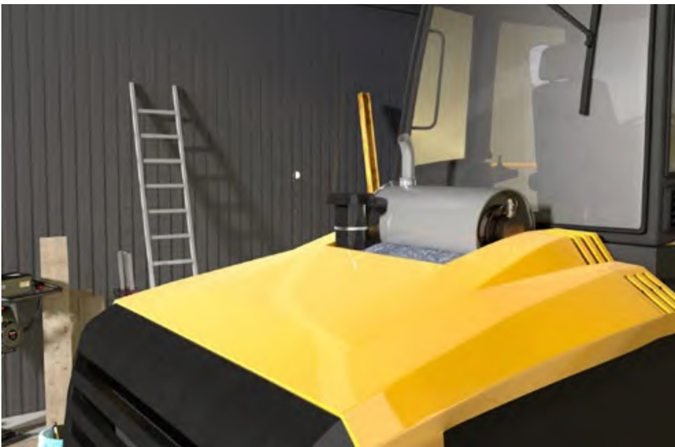
Abb. 93 Radlader mit Dieselpartikelfilter
