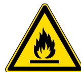
Abb. 40 Warnung vor feuergefährlichen Stoffen Warnzeichen W021
