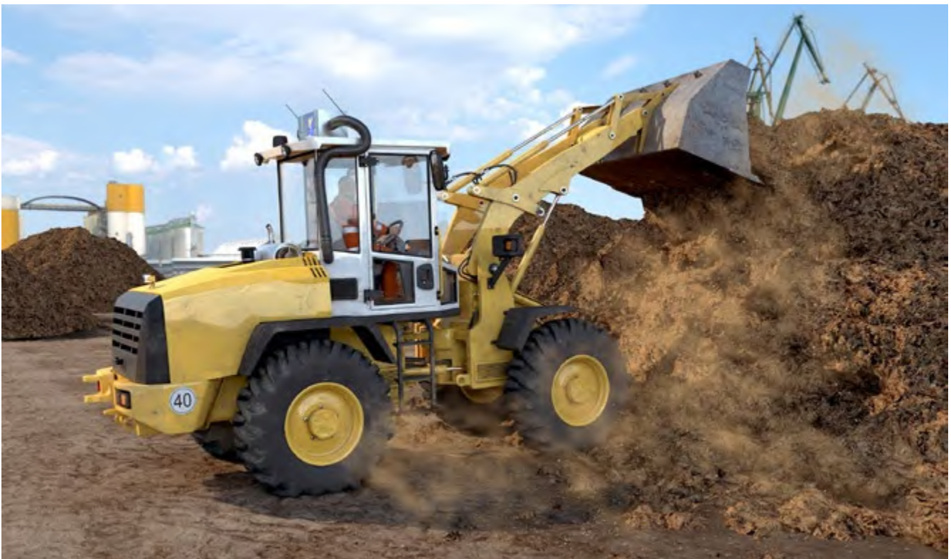
Abb. 91 Radlader mit Filteranlage
