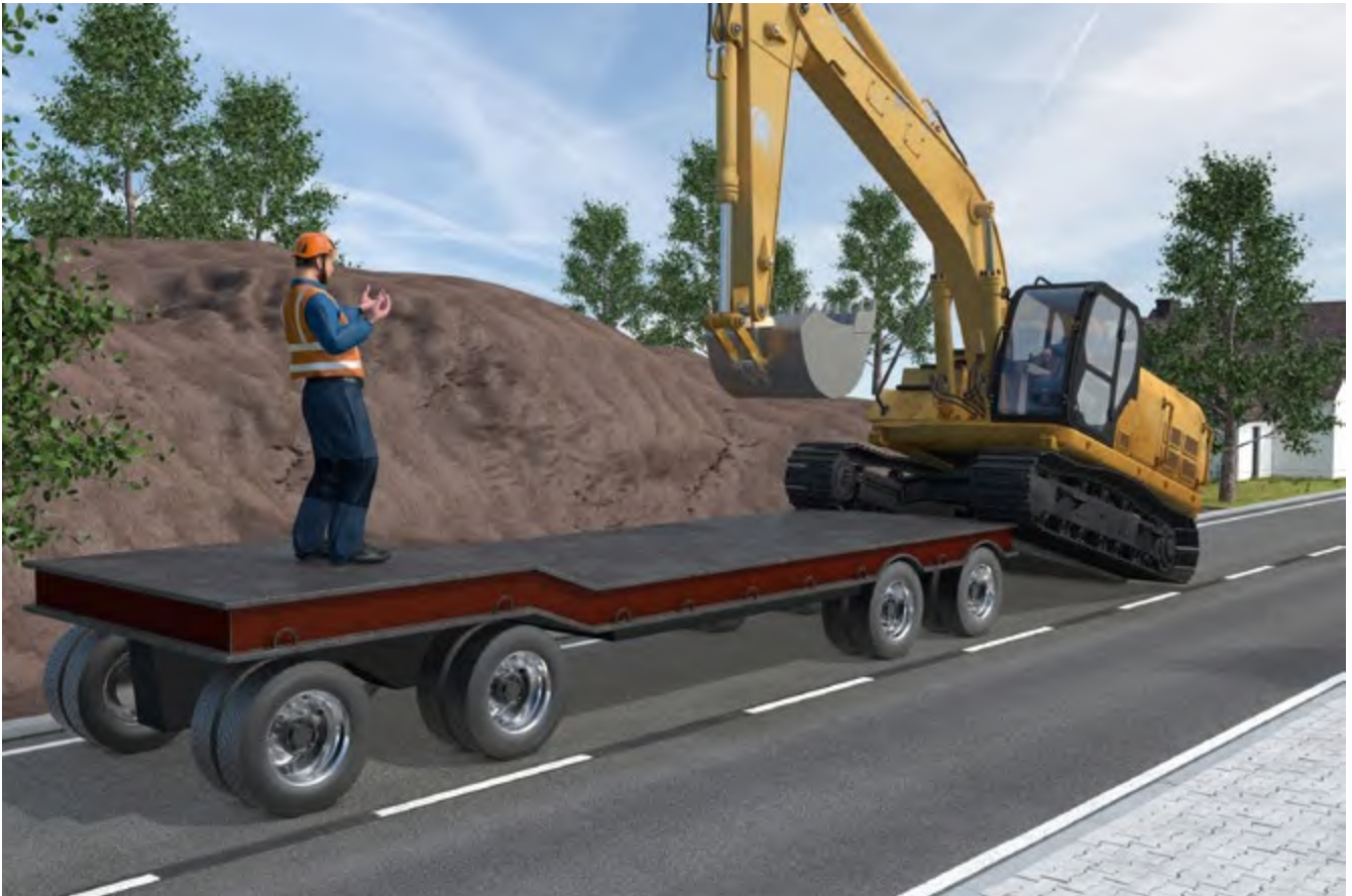
Abb. 82 Verladen eines Baggers
