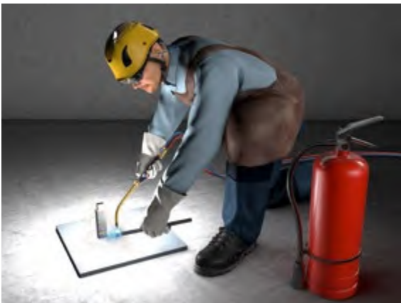
Abb. 67 Schutzausrüstung beim Gasschweißen
