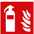
Abb. 39 Brandschutzzeichen F001 Feuerlöscher
