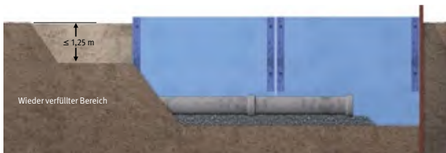
Abb. 112 Sicherung der Stirnseite des Verbaus
