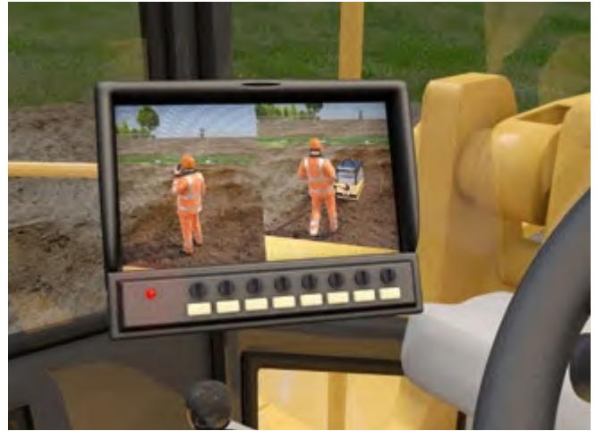
Abb. 74 Splitscreen-Monitor für Rückraum- und Seitenkamera
