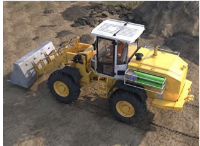
Abb. 92 Radlader mit Atem-Druckluft-Anlage
