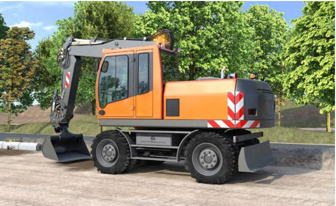
Abb. 68 Sicherheitskennzeichnung und gelbe Rundumleuchte an mobilen Baumaschinen
