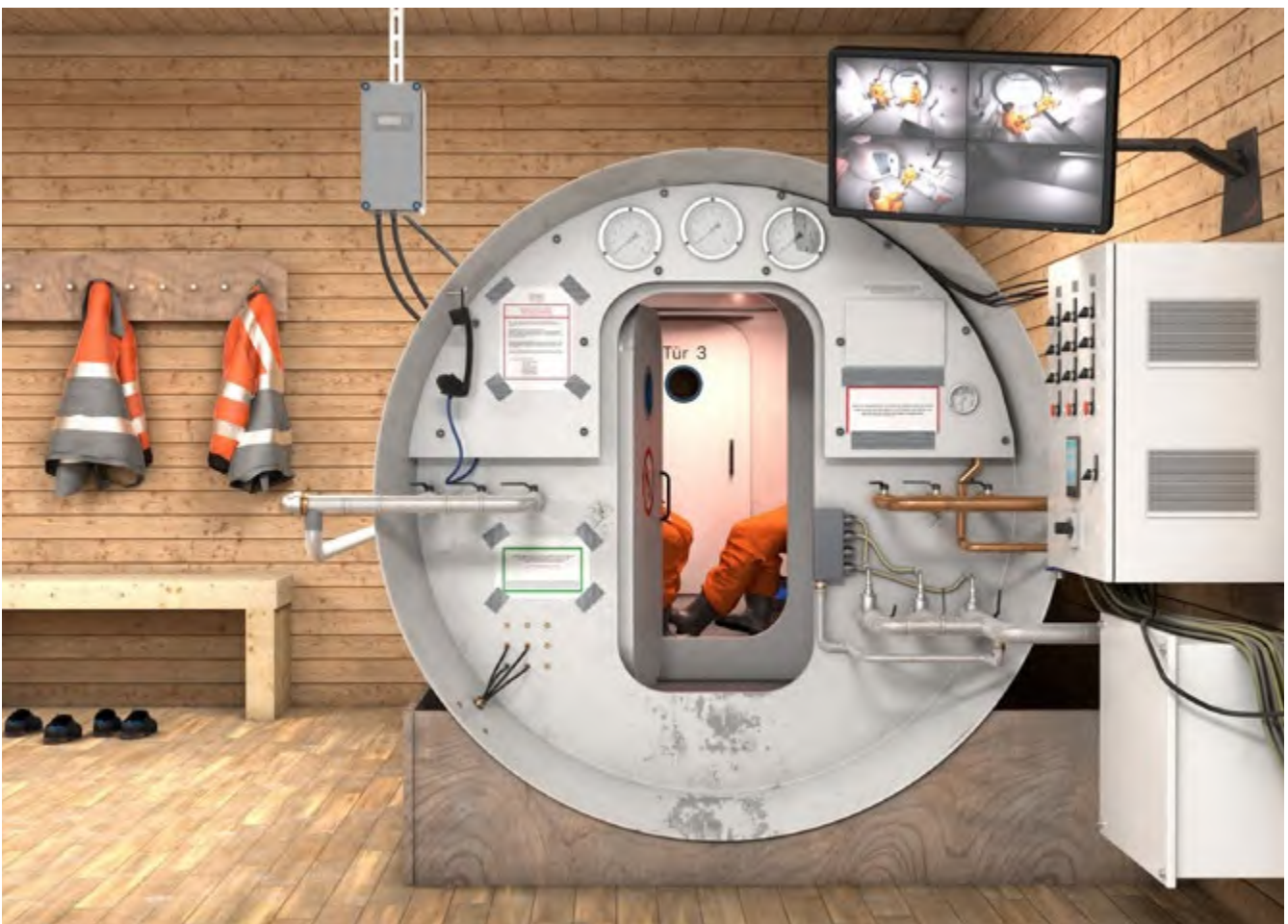
Abb. 144 Personenschleuse bei Arbeiten in Druckluft
