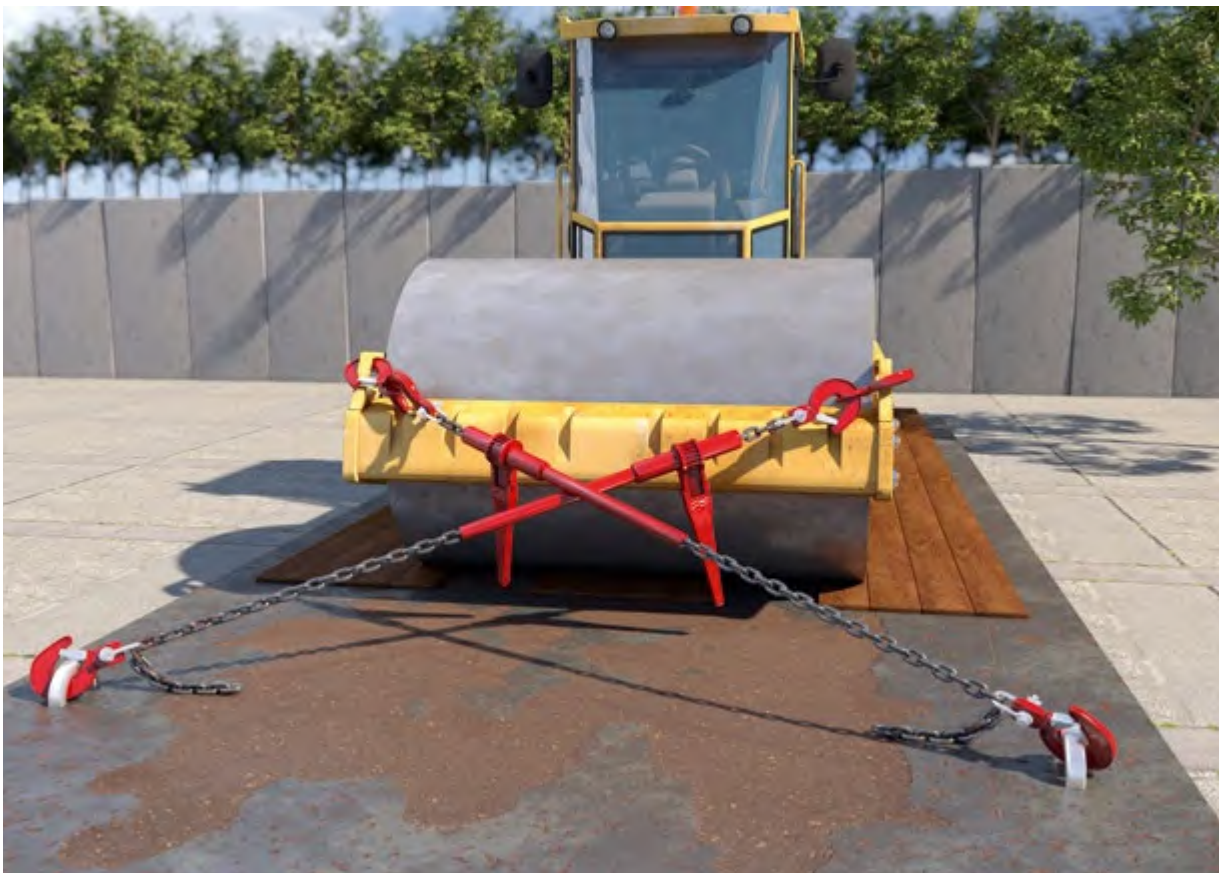
Abb. 84 Mittels Diagonalzurrung gesicherter Walzenzug
