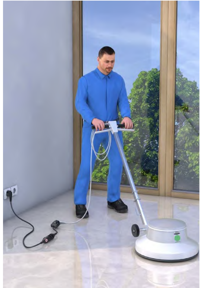
Abb. 70 Einscheibenmaschine mit PRCD-S
