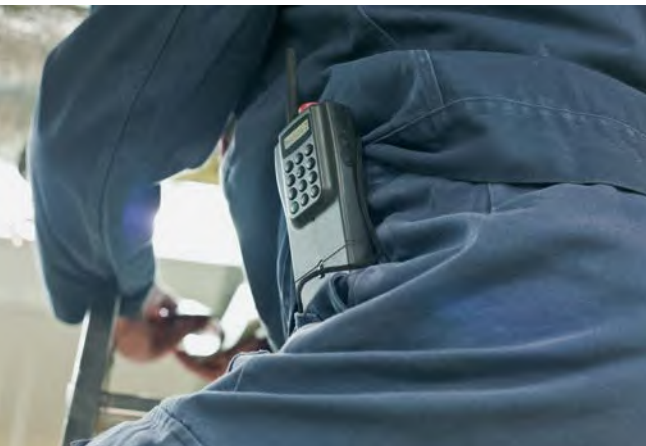
Abb. 74 Bei Alleinarbeiten können Personen-Notruf-Anlagen im Notfall rechtzeitige Rettung und Erste Hilfe sicherstellen.
