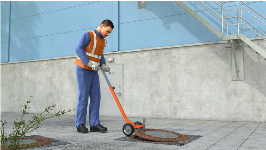
Abb. 13 Dank des Schachtdeckelhebers vervielfacht sich die eingesetzte Muskelkraft.
