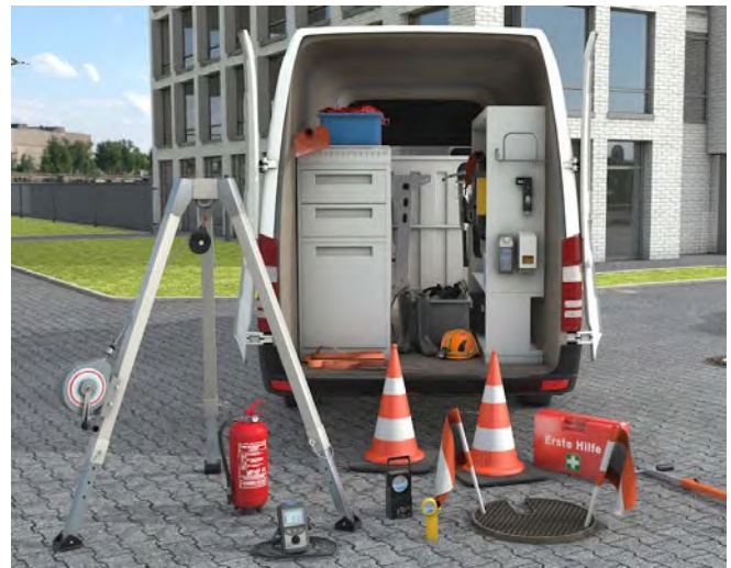
Abb. 27 Gut ausgerüstet für den Einstieg in Schächte.
