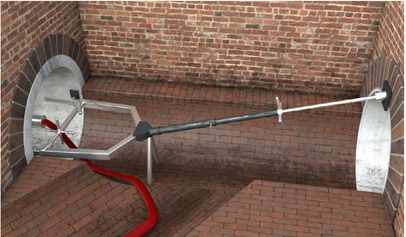
Abb. 32 Die Ausschubsicherung verhindert das Verrutschen der Kanalblase.
