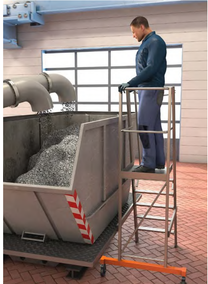
Abb. 11 Sicherer Standplatz am Container auf einer Podestleiter
