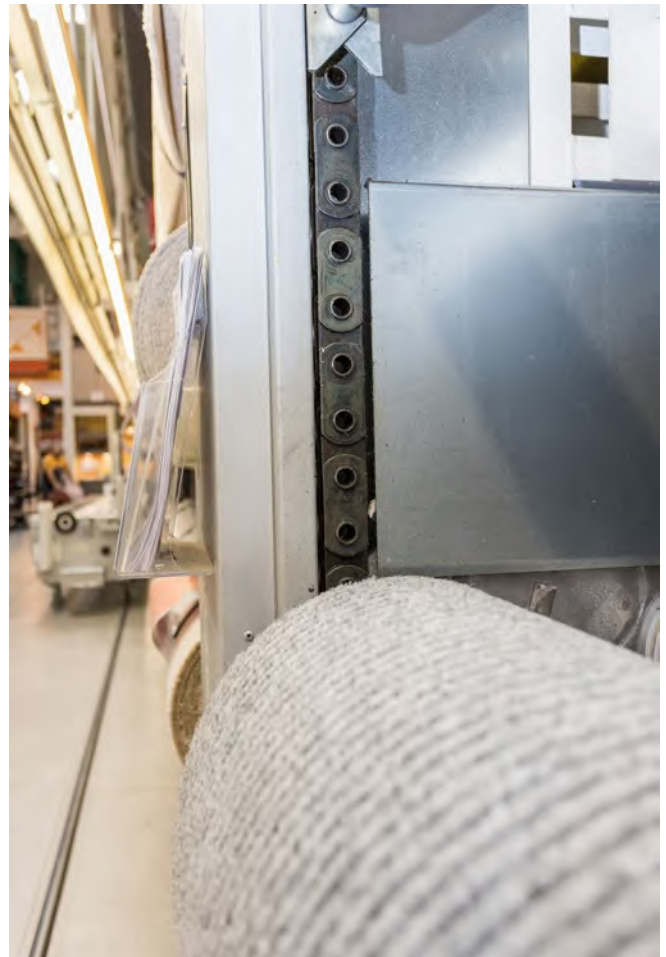
Abb. 90 Die Einlaufstellen zwischen Zahnrädern und Transportketten müssen z. B. durch Bleche abgedeckt sein.
