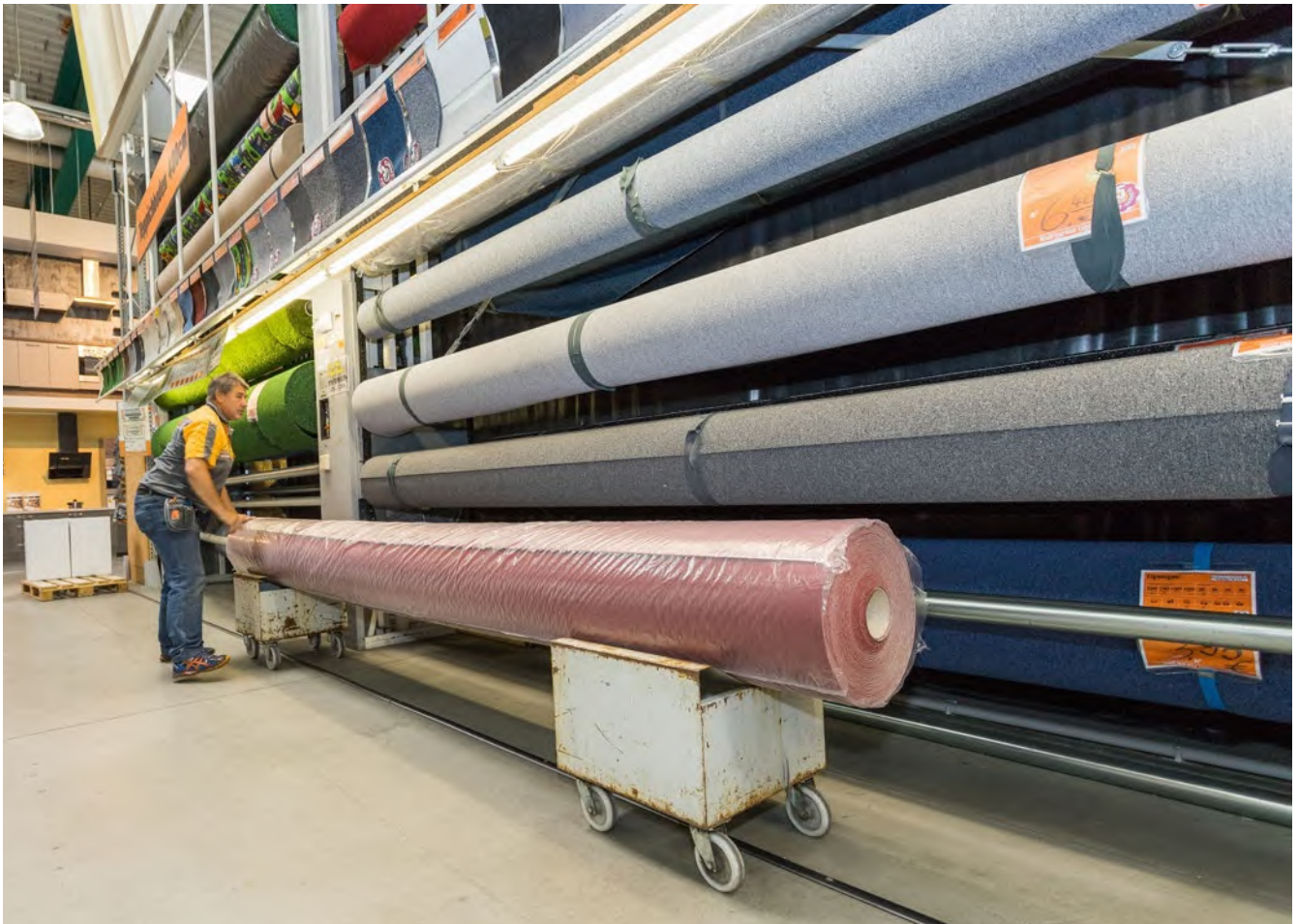
Abb. 91 Reduzieren Sie die physischen Belastungen beim Be- und Entladen des Paternosters, indem Sie Hilfsmittel wie Belade- oder Muldenwagen bereitstellen.
