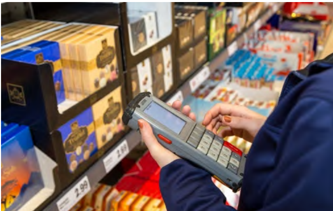
Abb. 35 Es werden zwei Scan-Verfahren unterschieden: 1 via Laserstrahl (z. B.: mit Barcodelesestiften, Handbarcode-Scannern, omni-direktionalen Barcodescannern in modernen Kassen-Systemen) 2 via Kamera (mittels CCD-Sensoren, kurz für: charge-coupled device (ladungsgekoppeltes Bauteil) = Lichtempfindliches elektronisches Bauelement/ CMOS-Sensoren, z. B. in Smart-Devices)
