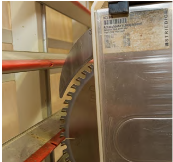
Abb. 87 Der Spaltkeil verhindert ein Schließen der Schnittfuge, sodass beim Horizontalschnitt keine Abschnitte weggeschleudert werden.
