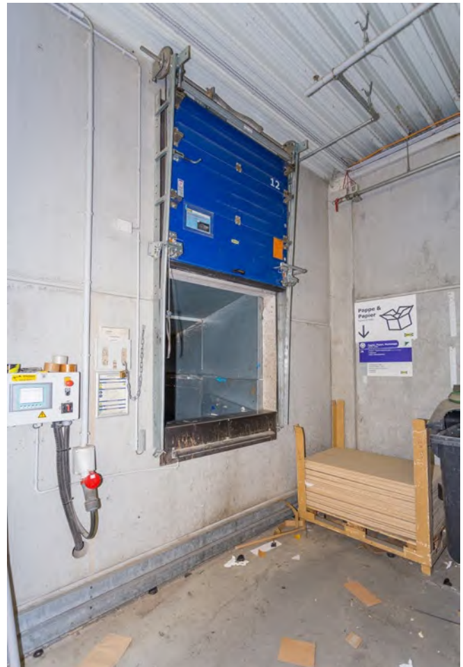
Abb. 65 Die Einfüllöffnung muss mind. 1m oberhalb der Standfläche für Personen an Pressen liegen.
