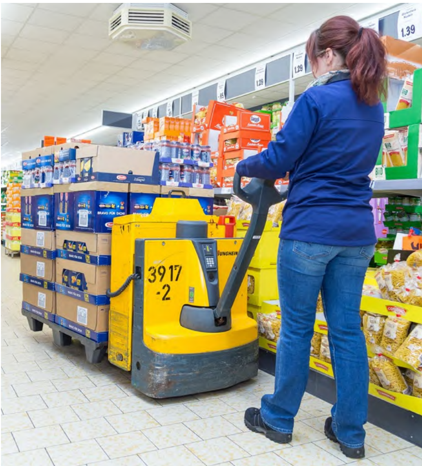
Abb. 7 Bei Verwendung von kraftbetriebenen Flurförderzeugen (Mitgängerflurförderzeugen oder Gabelstaplern) ist der Einsatz von entsprechenden persönlichen Schutzausrüstungen (PSA), insbesondere von Sicherheitsschuhen, mindestens der Kategorie S1, vorgeschrieben.
