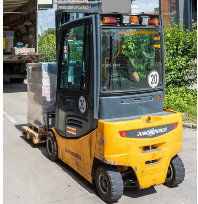
Abb. 5 Maschinen oder Flurförderzeuge mit geschlossener Kabine zum Schutz vor Witterungseinflüssen einsetzen
