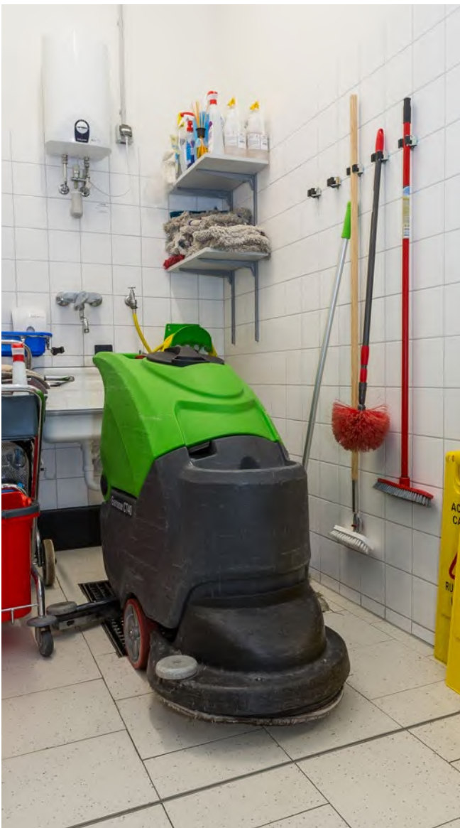
Abb. 102 Für die Bodenreinigung im Innenbereich bewährt sind Scheuersaugmaschinen mit der Möglichkeit des Batteriebetriebes.
