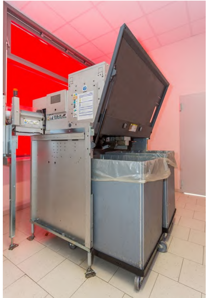
Abb. 85 Die Auffangbehälter sind auf Rollen und aufklappbar, sodass Säcke nicht gehoben werden müssen.
