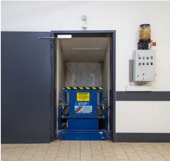
Abb. 67 Bedienelemente von Pressen müssen leicht erreichbar und die Funktion eindeutig erkennbar sein.
