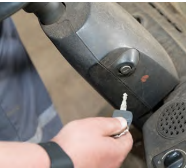
Abb. 35 Verhinderung einer unbefugten Benutzung
