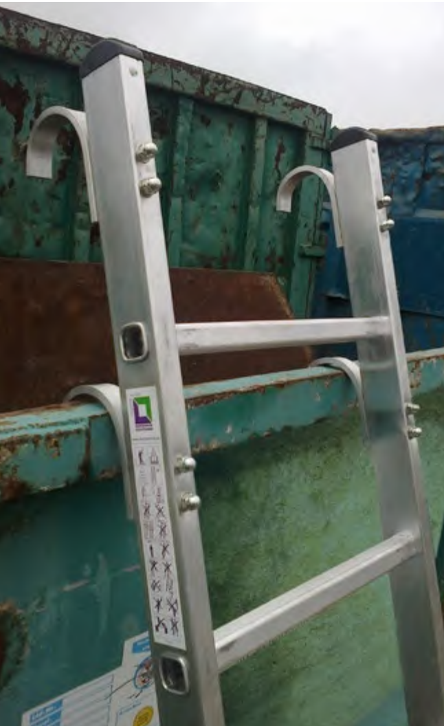
Abb. 9 Absetzbehälter mit Anlegeleiter zum Einhaken an unterschiedlichen Behältern
