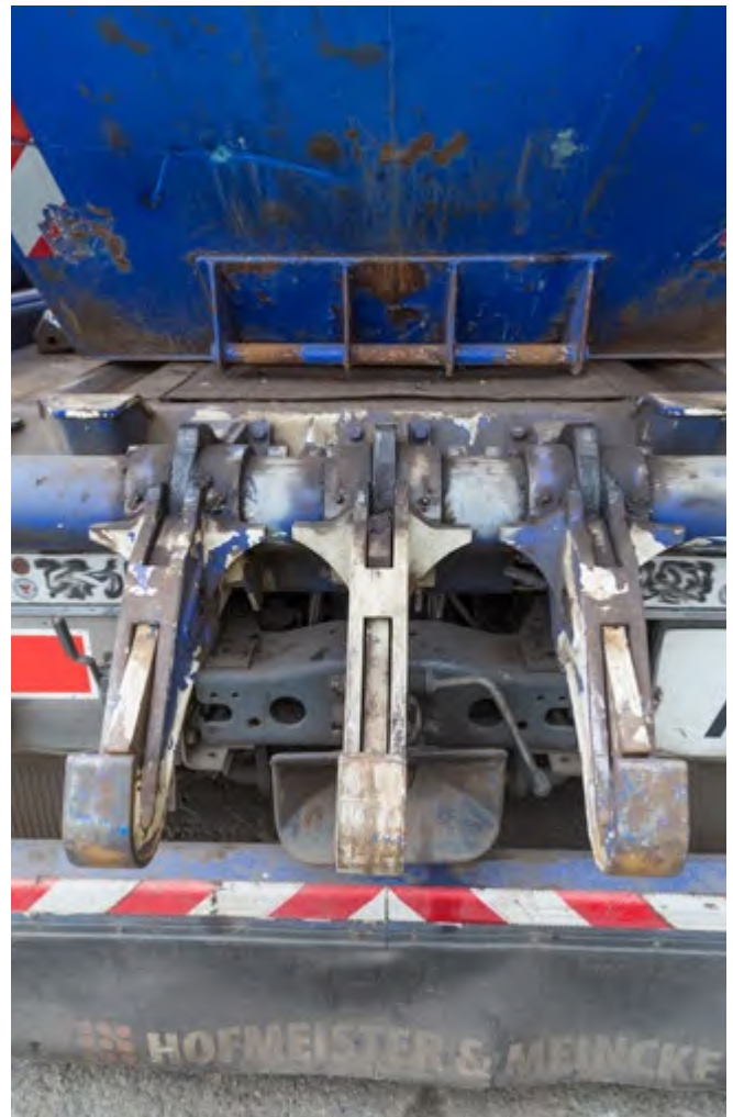
Abb. 3 Dieser Behälter benötigt ein Fahrzeug mit 3 Fanghaken.
