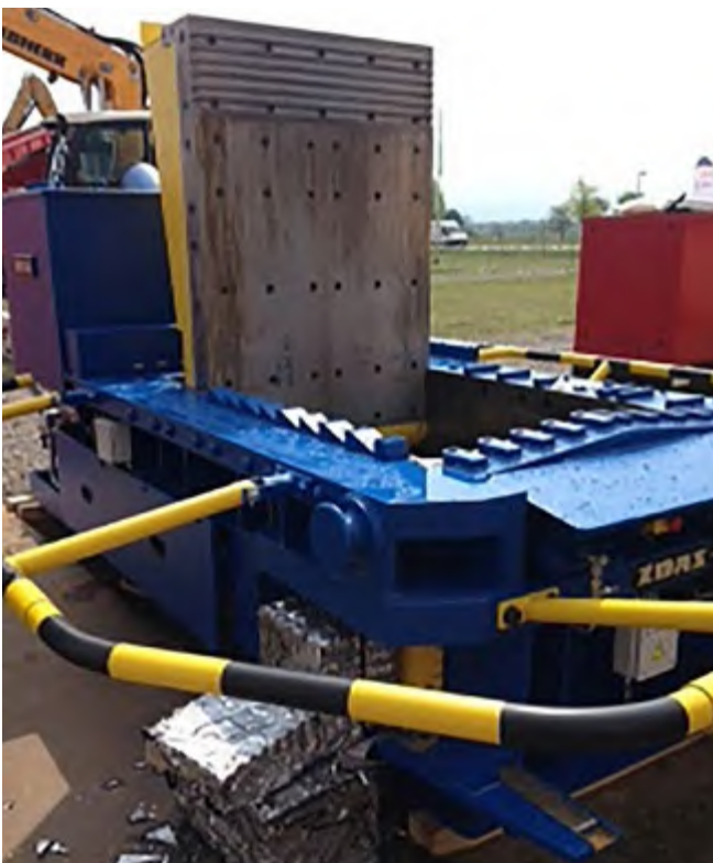
Abb. 59 Mobile Deckelpresse mit Abweisbügel
