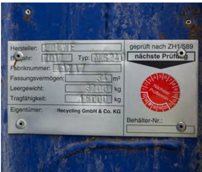
Abb. 6 Angaben über das Fassungsvermögen, das Leergewicht und das zulässige Füllgewicht (Tragfähigkeit) sind dem Typenschild des jeweiligen Behälters zu entnehmen.
