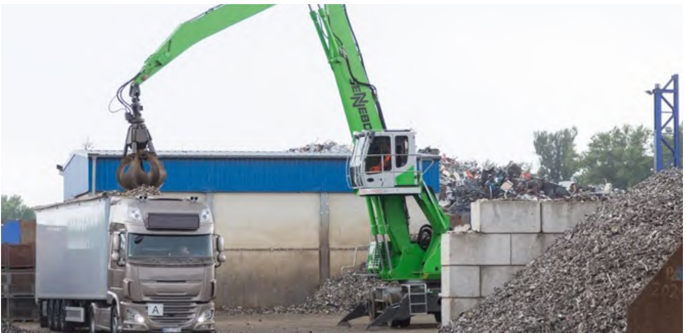
Abb. 32 Mobilbagger mit hebbarem Führerhaus für bessere Übersicht.
