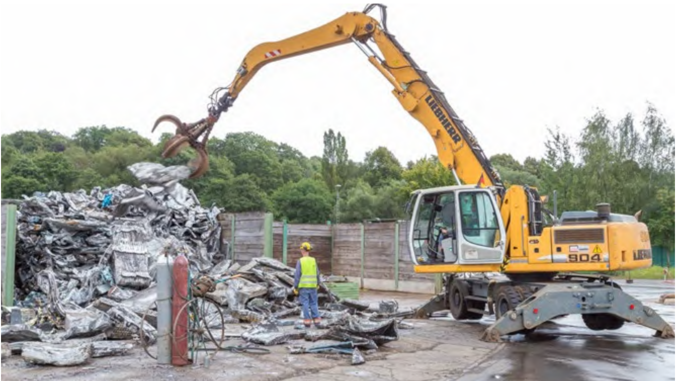
Abb. 27 Die Person vor dem Bagger trägt zwar Warnkleidung und Kopfschutz, ist aber durch ihren Aufenthalt im Gefahrenbereich durch herausfallende/herausgeschleuderte Teile aus dem Greifer gefährdet. Hinzu kommt noch die Gefährdung durch den fehlenden mechanischen Schutz der Gasflaschen (siehe auch Kapitel 3.3.4 Brennschneiden)
