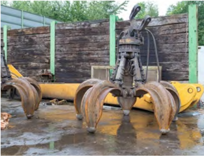
Abb. 26 Mehrschalengreifer kippständer für die Montage aufgestellt
