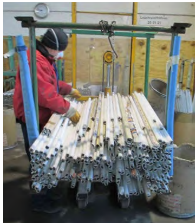
Abb. 94 Einsatz von Atemschutz
