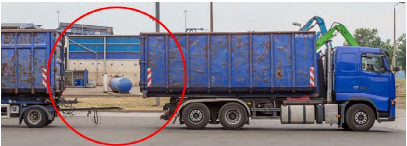
Abb. 2 Zwischen Fahrzeug und Hänger darf sich niemand aufhalten. Das Kupplungsmaul am Fahrzeug und die Deichsel des Anhängers müssen genau fluchten.
