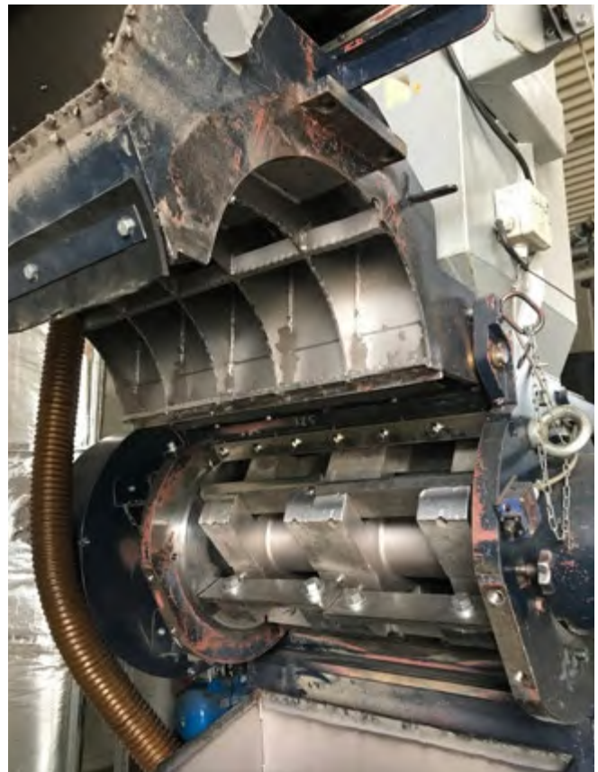
Abb. 104 Zusätzliche mechanische Sicherung am Gehäuse des Kabelgranulierers gegen unbeabsichtigtes Absenken des Deckels
