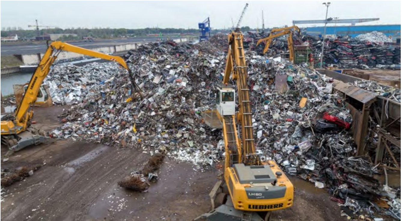
Abb. 25 Im Gefahrenbereich des Baggers darf sich keine Person aufhalten. Ist der Aufenthalt aus betrieblichen Gründen unvermeidlich, müssen die Maßnahmen in einer Gefährdungsbeurteilung festgelegt werden.
