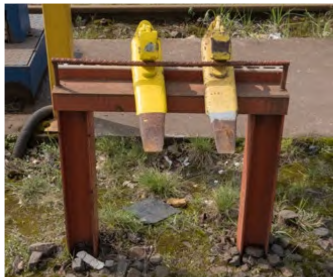
Abb. 13 Hemmschuhbank zur sicheren Aufbewahrung
