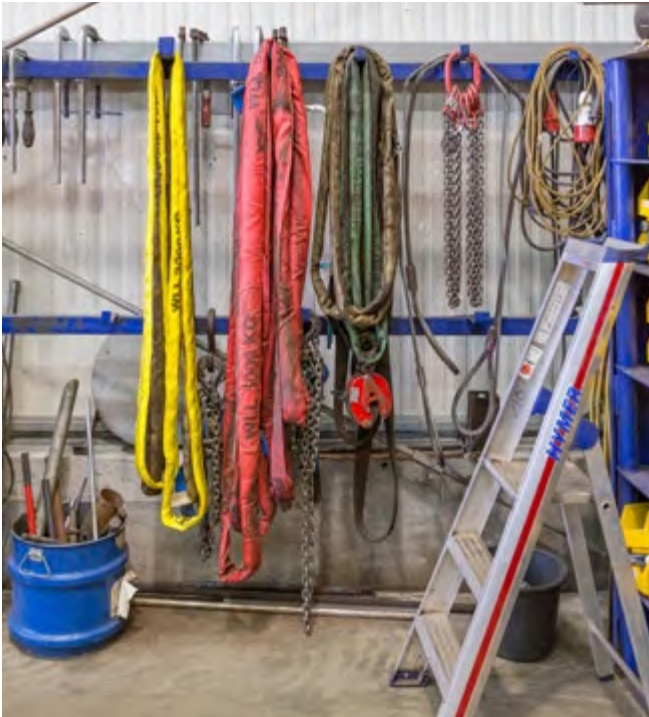
Abb. 111 Geschützte und übersichtliche Aufbewahrung von Anschlagmitteln
