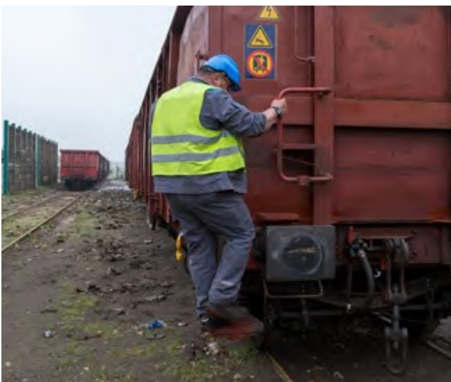
Abb. 14 Sicherer Aufstieg mit Haltegriffen
