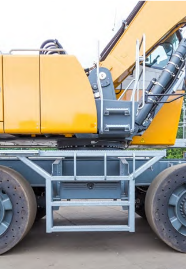
Abb. 33 Viele Hersteller dimensionieren Aufstiege und Haltegriffe großzügig.
