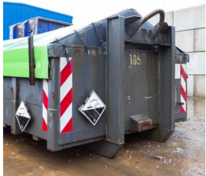
Abb. 102 Behälter für das Sammeln von Fahrzeugbatterien
