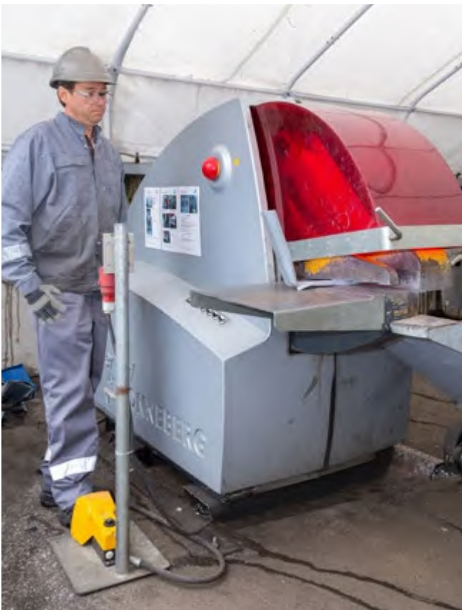
Abb. 80 Fixierung des Schneidgutes durch den Niederhalter
