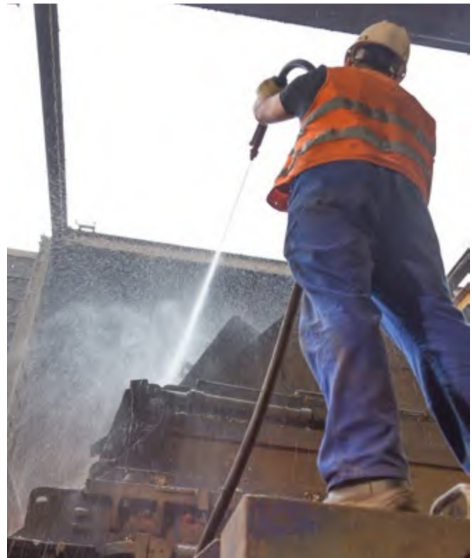
Abb. 72 Abkühlen der heißen Hämmer vor dem Wechsel mit Wasser
