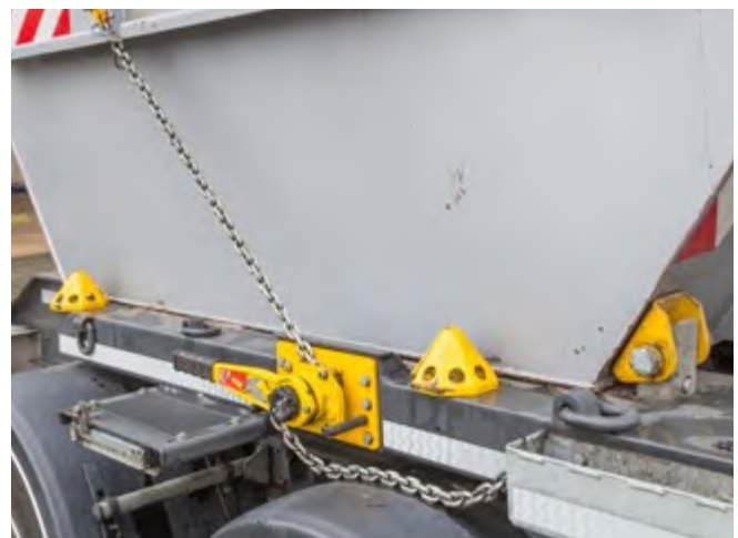
Abb. 7 Dieser Behälter ist formschlüssig nach allen Seiten gesichert.
