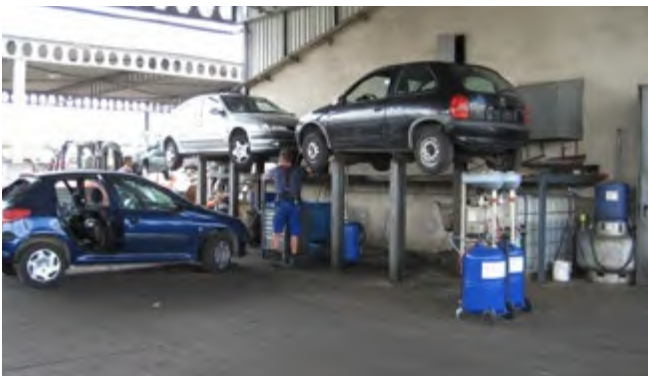
Abb. 89 Trockenlegung in geschütztem Hallenbereich
