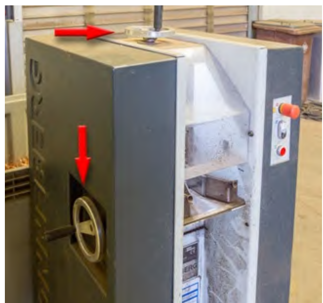
Abb. 103 Mit den Handrädern oben und links an der Maschine lässt sich die Einstellung auf den jeweiligen Kabeldurchmesser durchführen
