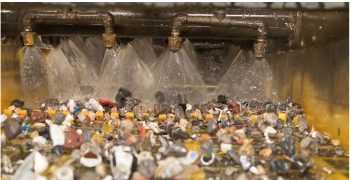
Abb. 85 Staubbinding durch Wasserbedüsung
