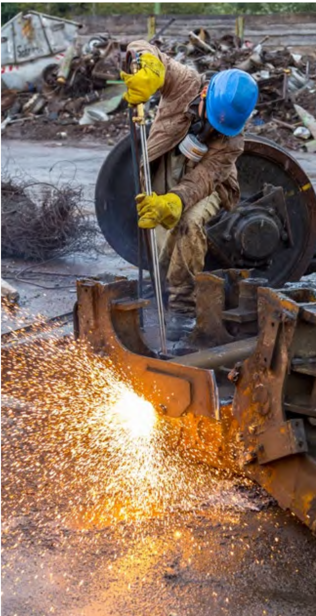
Abb. 53 Stationärer Arbeitsplatz für Brennschneidearbeiten auf einem Schrottplatz
