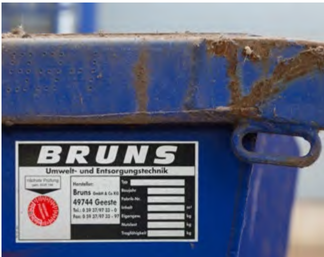
Abb. 11 Herstellerangaben und Prüfplakette an einem Behälter. Dazu erforderlich ist ein schriftlicher Prüfnachweis.
