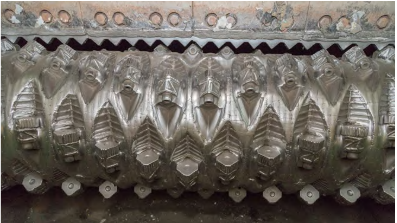
Abb. 63 Rotor- und Statormesser mit auswechselbaren Schneidwerkzeugen
