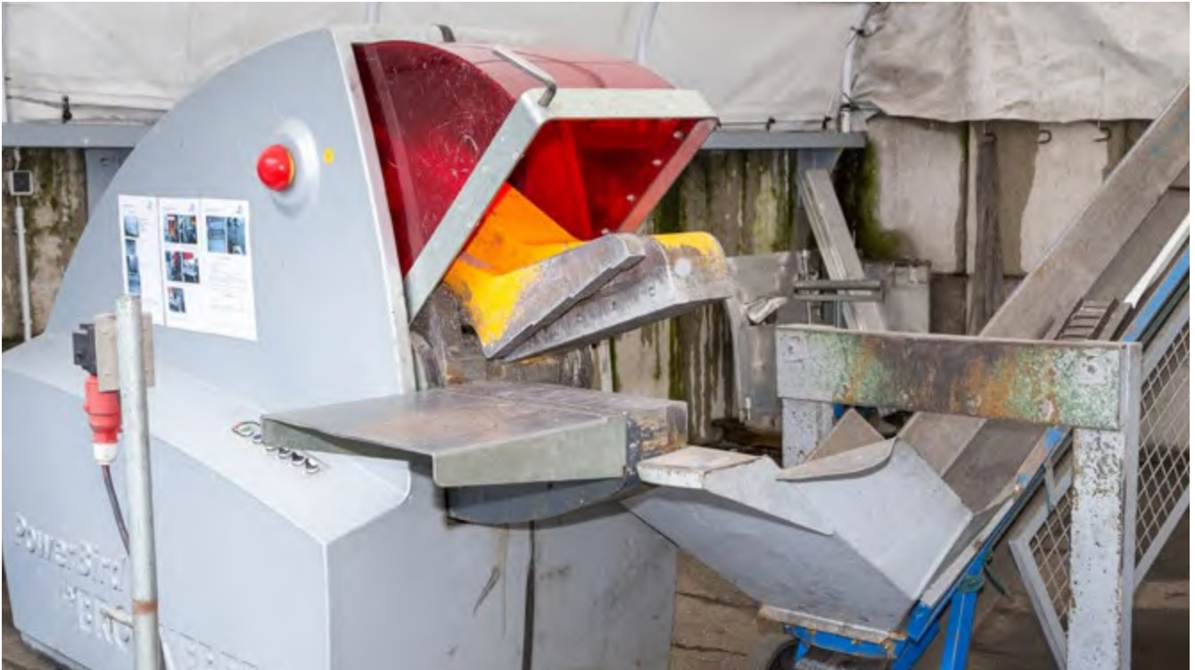
Abb. 82 Gut erreichbarer NOT-Halt-Taster und durchsichtiger Sicherheitskorb, die geschnittenen Teile werden hier über ein Förderband abtransportiert.
