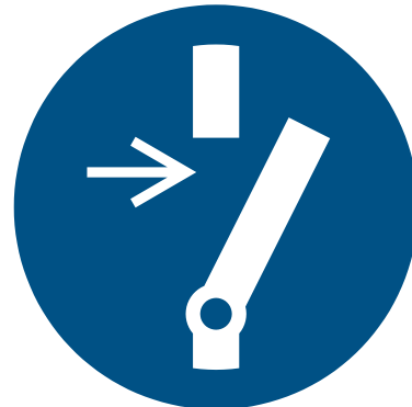
Bild 18 Gebotszeichen „Vor Wartung oder Reparatur freischalten“
