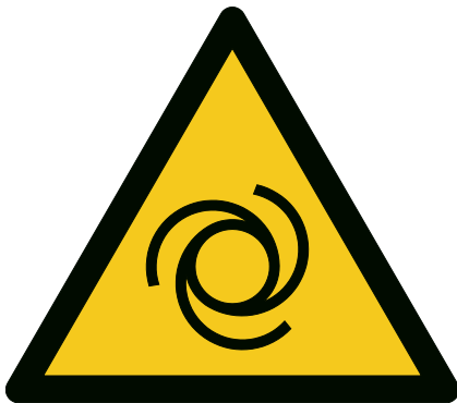
Bild 17 Warnzeichen „Warnung vor automatischem Anlauf“
