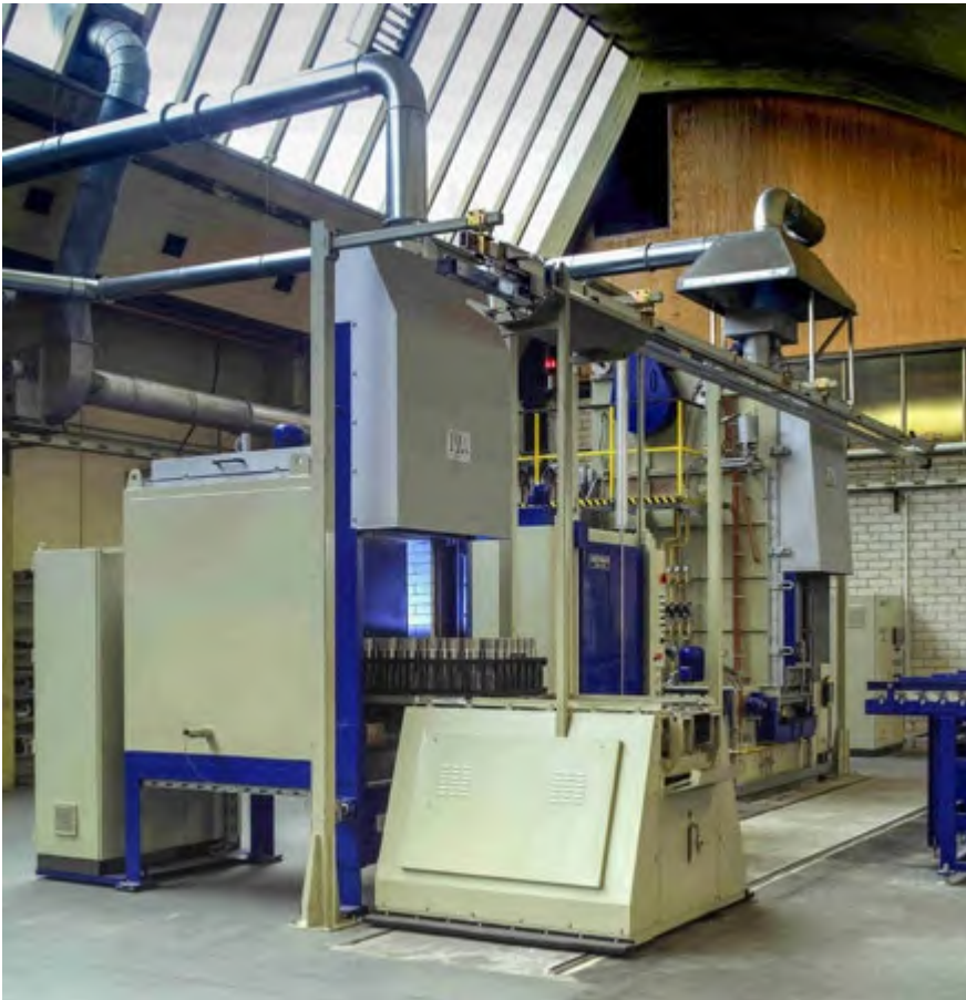
Abb. 36 Mehrzweckkammerofenlinie mit Anlassofen, Waschanlage und Mehrzweckkammerofen
