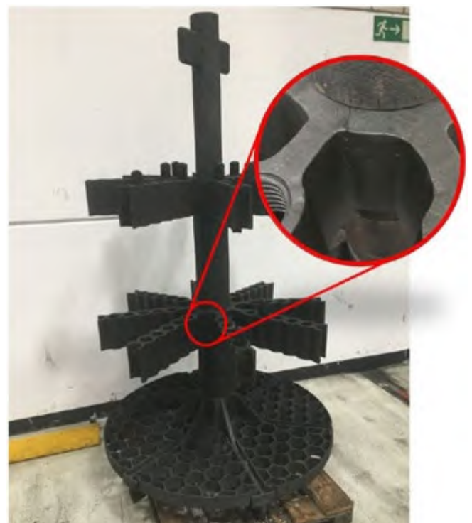
Abb. 38 Rissbildung an Chargengestell
