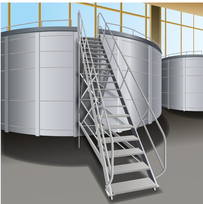
Abb. 19 Zugang auf Ofendach als Treppe
