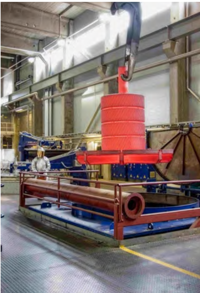
Abb. 11 Rotglühende Charge am Kran (vor Abschrecken)
