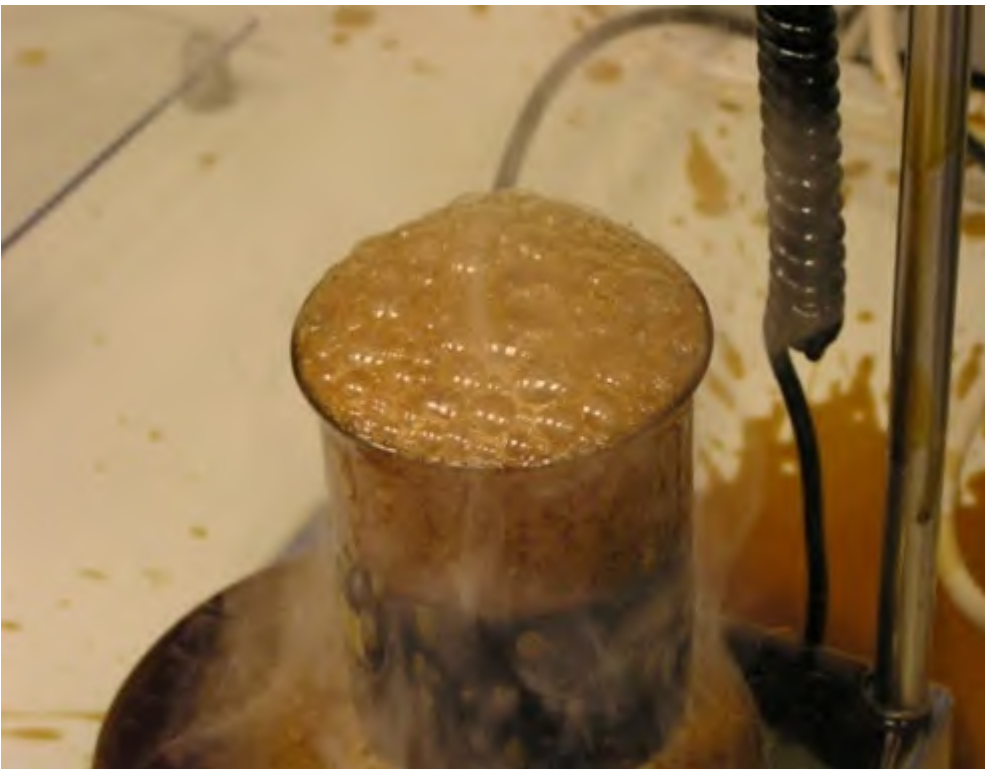
Abb. 33 Ölschaumbildung (im Labor nachgestellt) bei wasserkontaminiertem Härteöl
