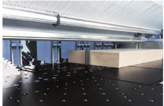
Abb. 3.1.3-02 Hohes Plattenpaket mit Winkelandrückvorrichtung
