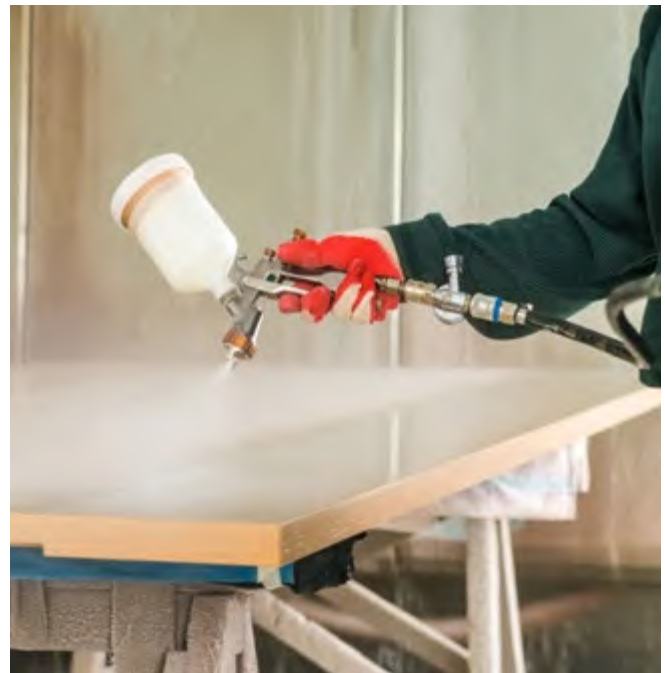
Abb. 3.6.1-03 Schutzhandschuhe bei Lackierarbeiten
