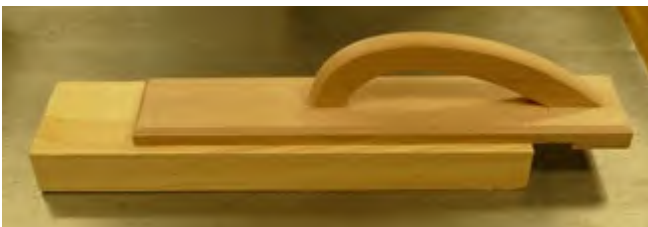
Abb. 3.1.9-05 Zuführlade und Schiebehholz für kurze Werkstücke
