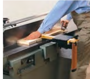
Abb. 3.1.9-07 Schwenkbarer Hilfsanschlag (Abrichten schmaler Leisten)
