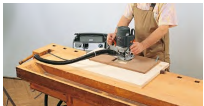
Abb. 3.1.8-06 Handvorschub = Arbeiten mit Handmaschinen
