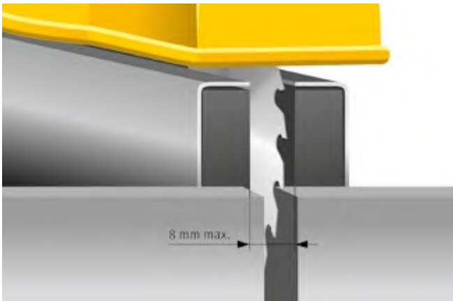
Abb. 3.1.5-03 Durchtrittsöffnung für das Sägeblatt am Werkstückanschlag
