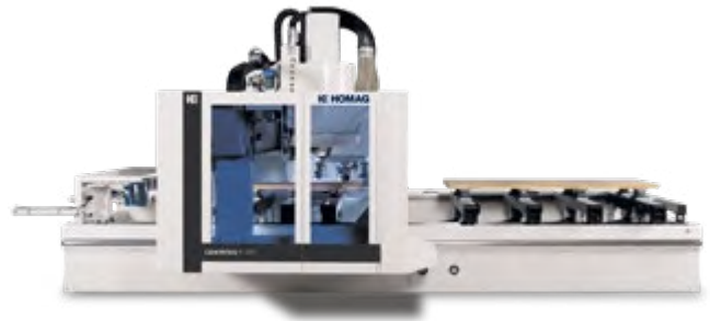
Abb. 3.1.11-04 CNC-Bearbeitungszentrum mit Sicherung durch Bumper
