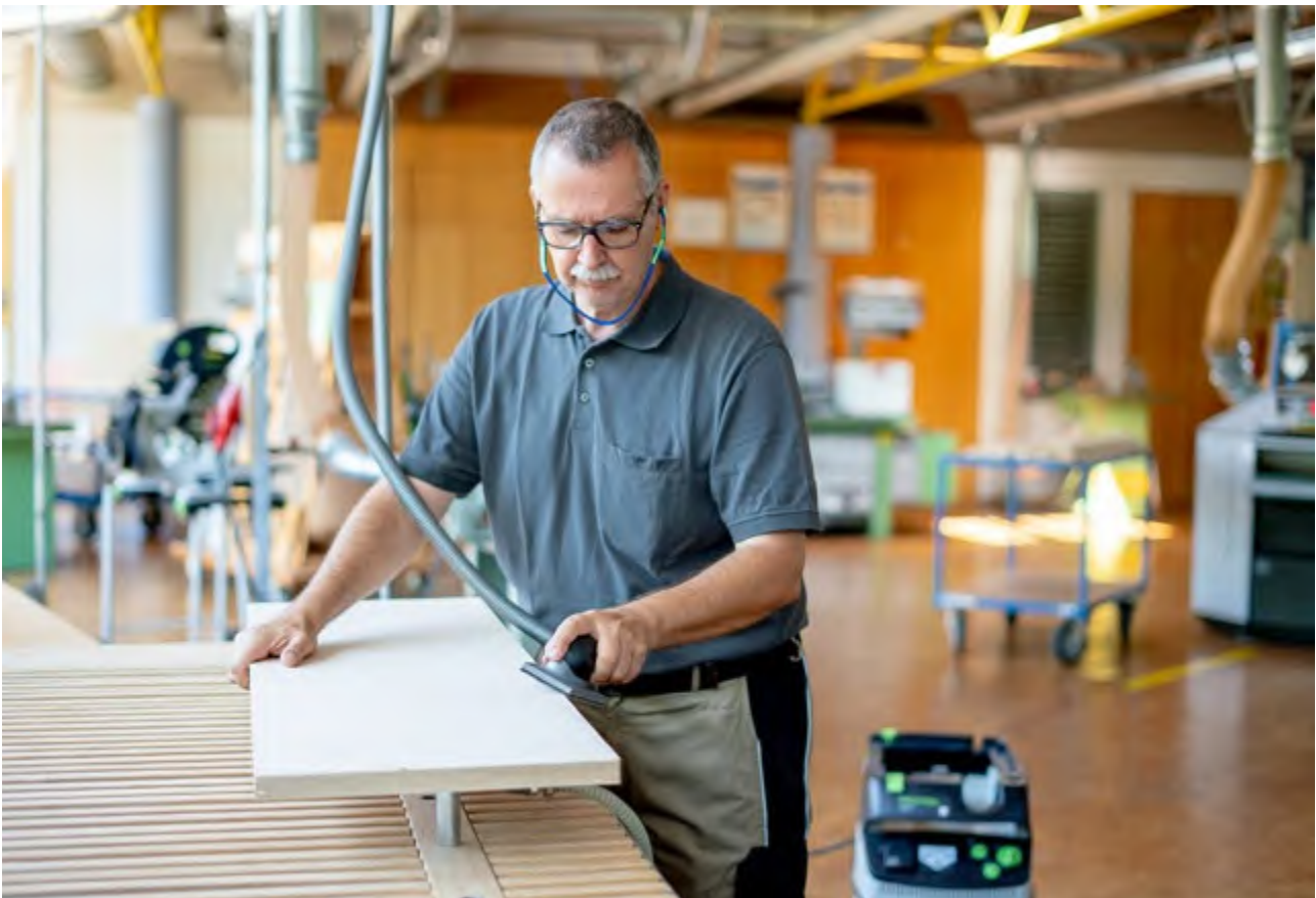
Abb. 3.3.6-01 Handschleifarbeiten mit abgesaugtem Handschleifklotz
