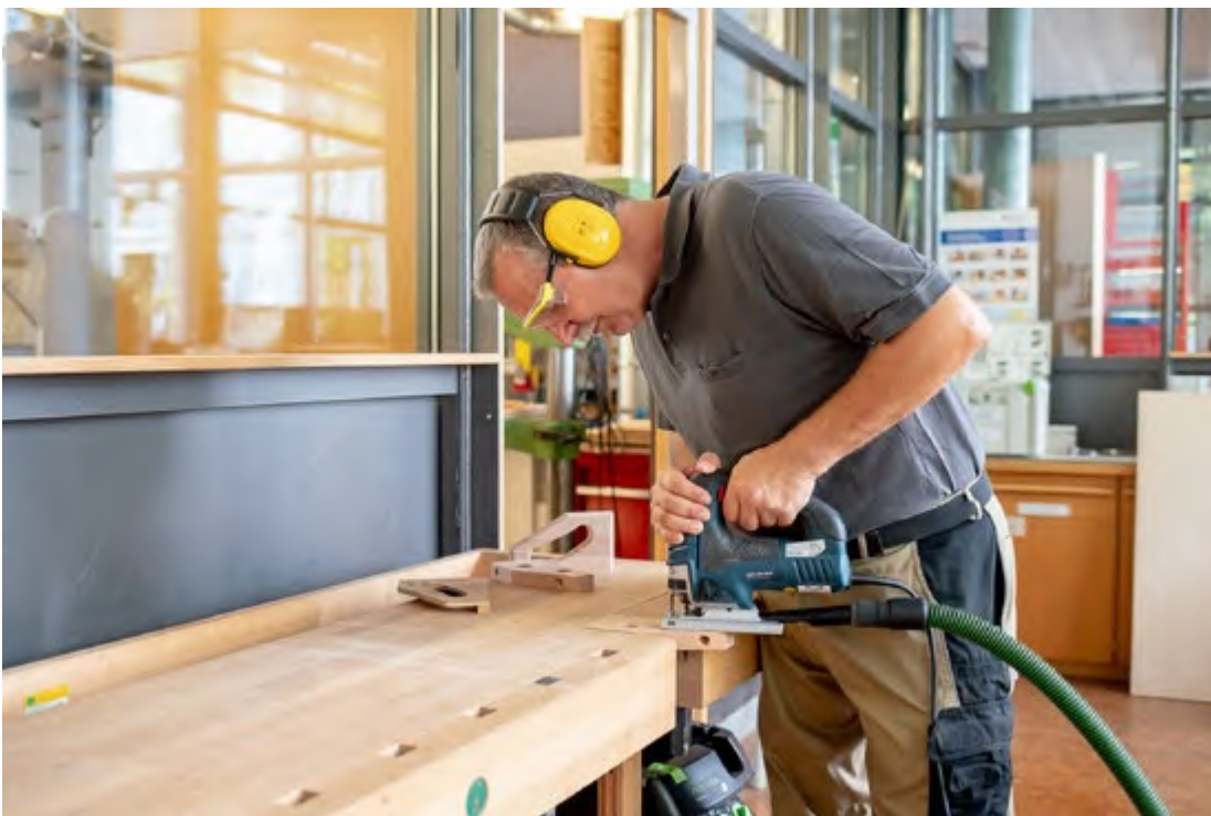
Abb. 3.3.4-02 Werkstücke sicher aufliegen und fixieren
