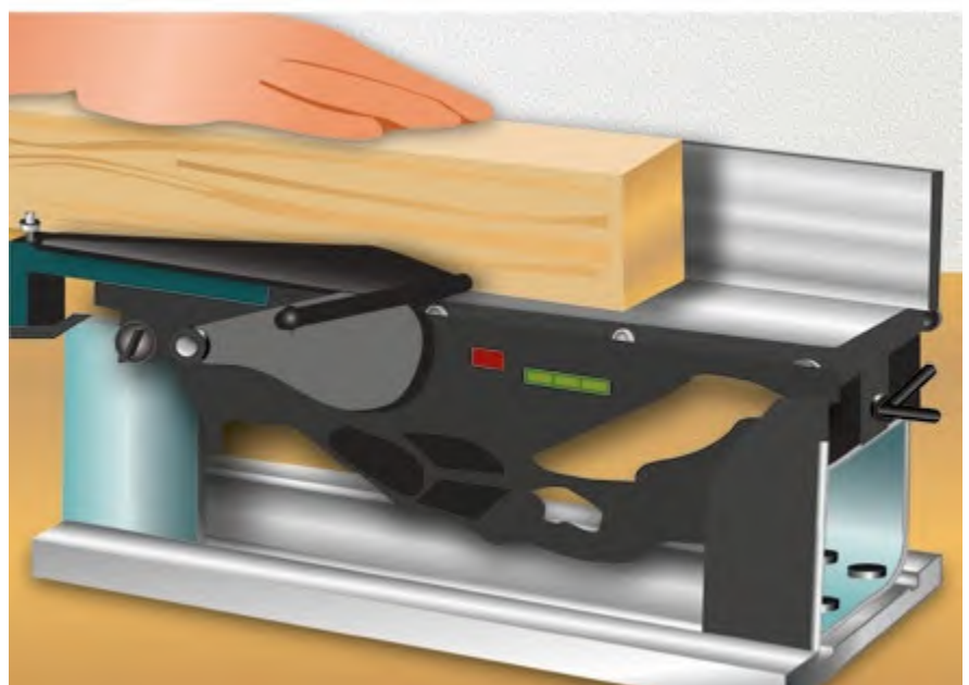
Abb. 3.3.3-02 Elektrohandhobel in stationärer Aufnahme
