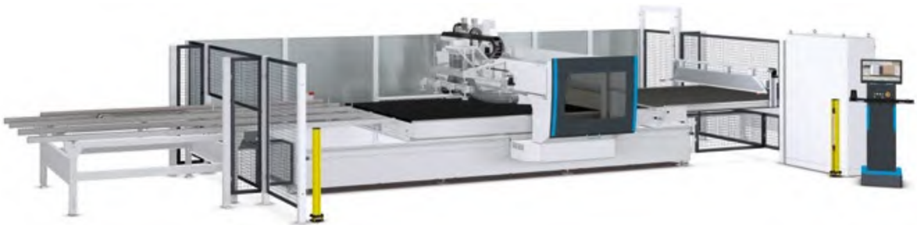
Abb. 3.1.11-01 CNC-Bearbeitungszentrum mit Schutzzaun und Kontakttrittmatte
