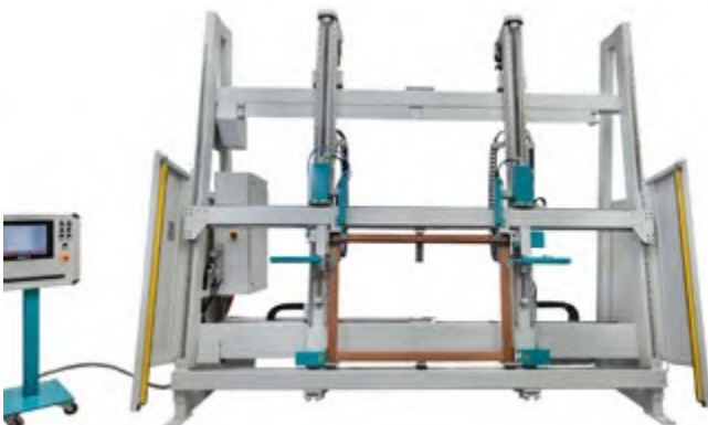
Abb. 3.1.15-04 Rahmenpresse mit Lichtvorhang
