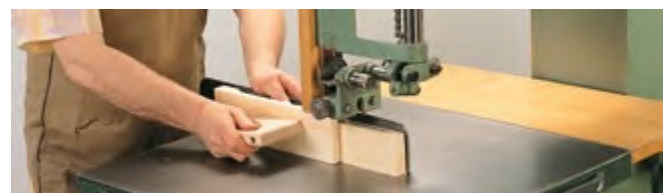
Abb. 3.1.6-10 Sägen kurzer Werkstücke mit Zuführhilfe
