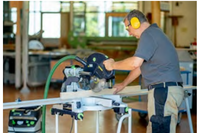
Abb. 3.1.4-02 Mobile Kapp-/Gehrungskreissägemaschine mit zusätzlicher Werkstückauflage
