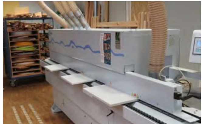
Abb. 3.1.12-04 Kantenanleimmaschine mit Absauganschlüssen
