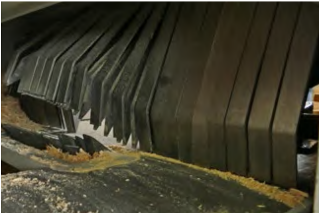
Abb. 3.1.14-05 Rückschlaggreifer und Splitterfänger (Innenansicht der Maschine, zum besseren Erkennen von außen angehoben)
