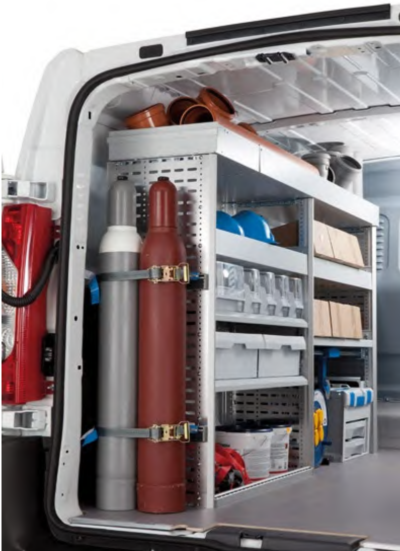
Abb. 3.5.6-01 Fahrzeug mit Einrichtungen zur Ladungssicherung
