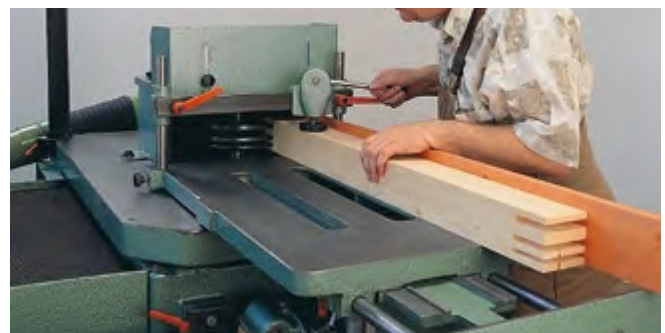
Abb. 3.1.8-05 Handvorschub = Arbeiten mit dem Schiebeschlitten
