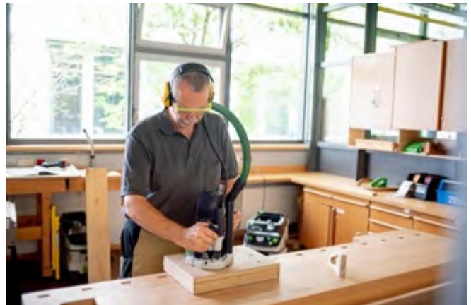
Abb. 3.3.2-02 Maschine an Absaugeinrichtung anschließen
