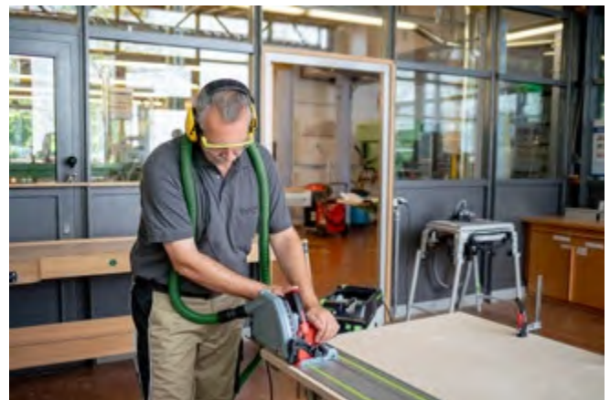
Abb. 3.3.1-11 Sägen mit Führungsschiene
