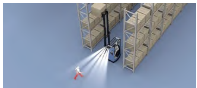
Abb. 3.4.4-04 Personenerkennung in einem Schmalganglager
