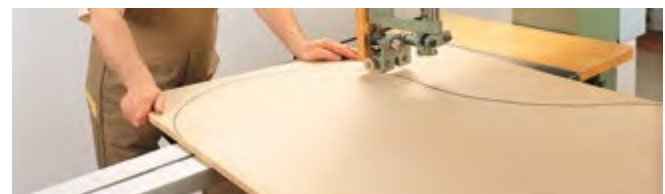
Abb. 3.1.6-09 Sägen sperriger Werkstücke mit zusätzlicher Tischverbreiterung
