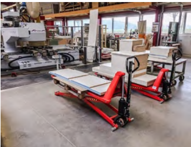
Abb. 3.2.1-04 Hubwagen mit Scherenhubfunktion
