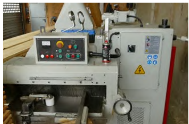
Abb. 3.1.14-04 Einschubbereich mit Splitterfänger
