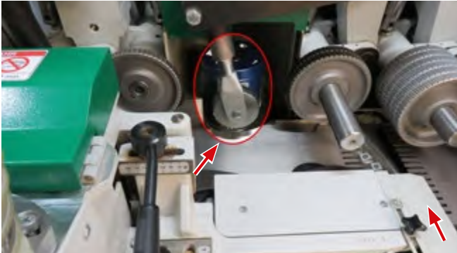
Abb. 3.1.13-03 Verdeckung einer hinteren Vertikalspindel vorge-setzter Druckrolle
