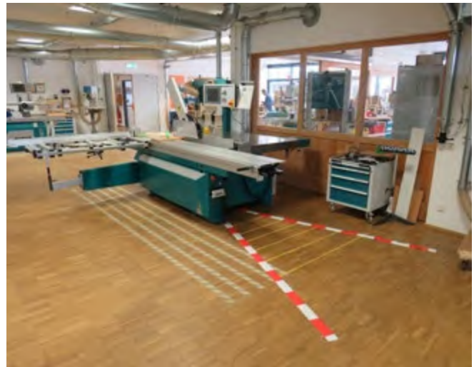
Abb. 2.2.2-02 Gefahrenbereich vor einer Formatkreissäge (hier z. B. rot-weiß gekennzeichnet)
