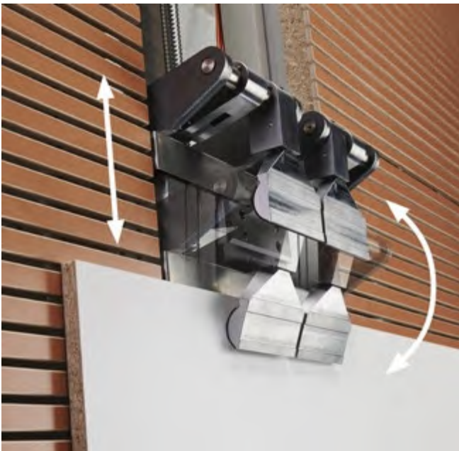
Abb. 3.1.2-04 Klemmvorrichtung für Besäumschnitt
