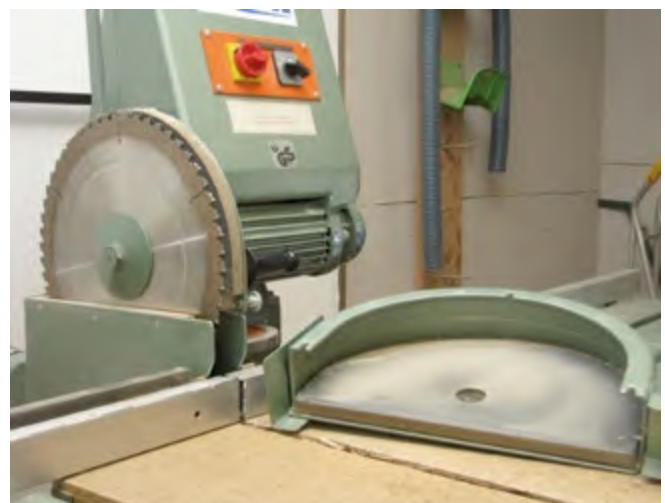
Abb. 3.1.5-07 Auskleidung an Schutzhaube zur Lärmreduzierung
