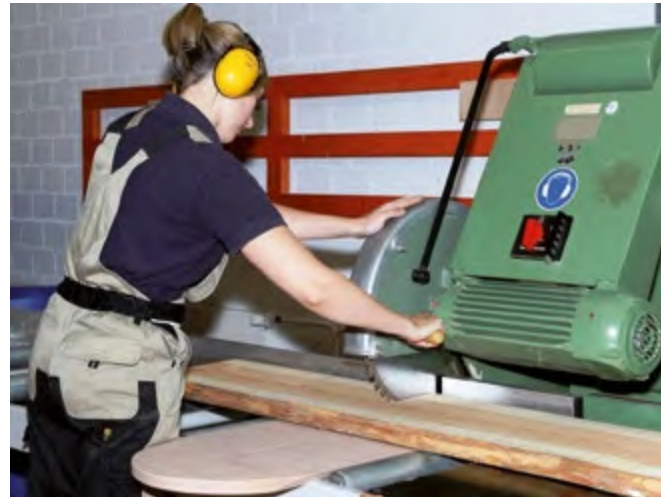
Abb. 3.1.5.06 Handhaltung beim Sägevorgang an einer Pendelkreissägemaschine
