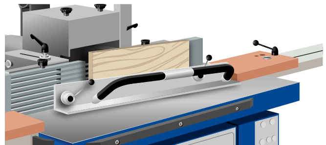
Abb. 3.1.7-06 Spannlade zum Einsetzfräsen kurzer Werkstücke
