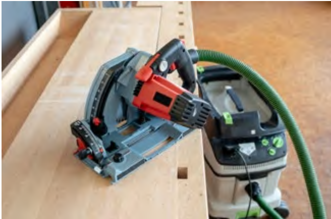
Abb. 3.3.1-09 Handkreissäge mit Absaugung
