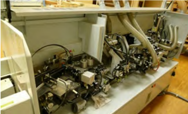
Abb. 3.1.12-02 Maschine mit geöffneter Schutzhaube (Kappsägeaggregate)
