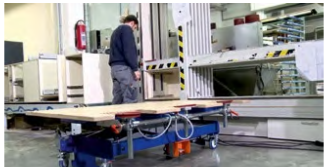
Abb. 3.1.15-07 Fahrbarer Bestücktisch zur Handhabung von großen, schweren Werkstücken
