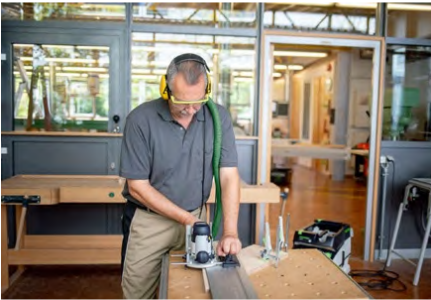
Abb. 3.3.2-03 Einfräsen von Nuten mit einer Führungsschiene
