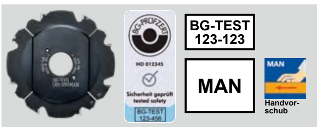
Abb. 3.1.8-03 Kennzeichnung eines Fräswerkzeugs für den Handvorschub
