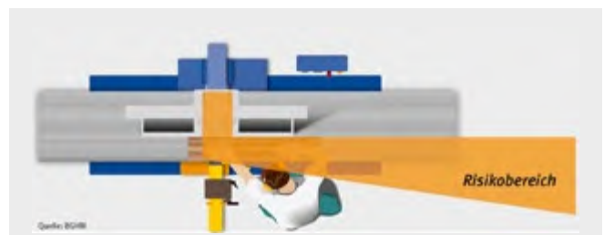
Abb. 3.1.9-02 Risikoaufenthaltsbereich an einer Abrichthobelmaschine
