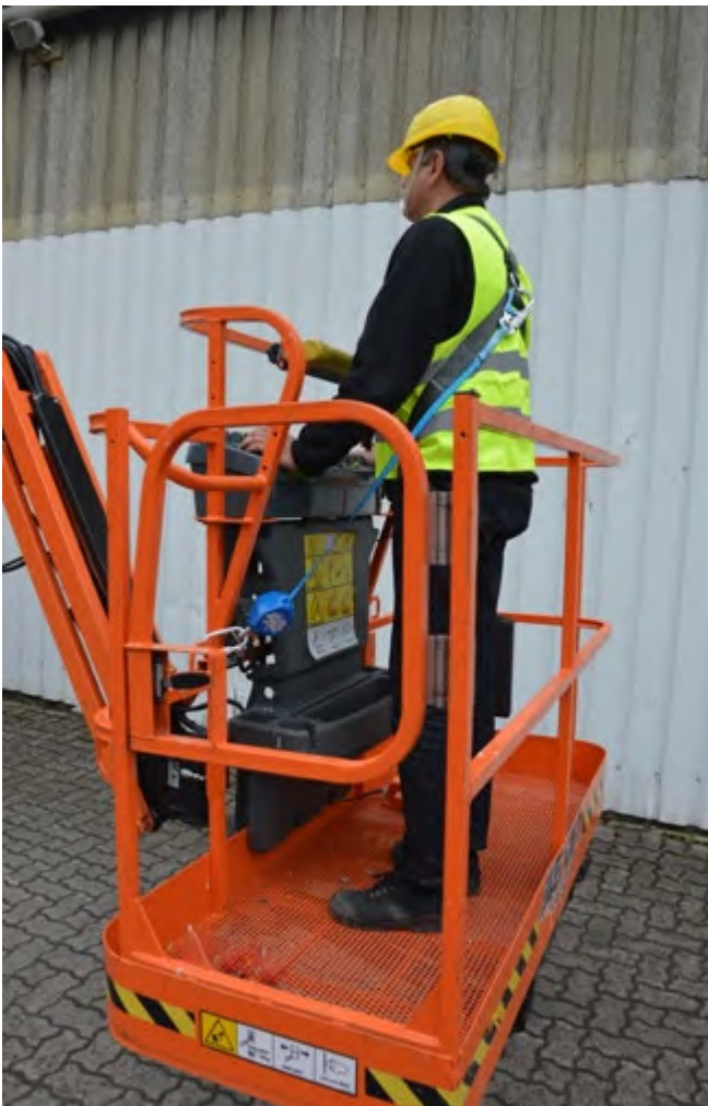
Abb. 3.5.4-02 Einsatz eines Höhensichtungsgeräts im Arbeitskorb
