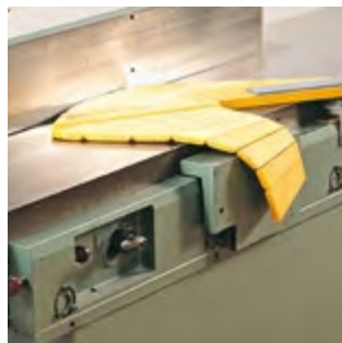
Abb. 3.1.9-04 Gliederschwingschutz für Altmaschinen
