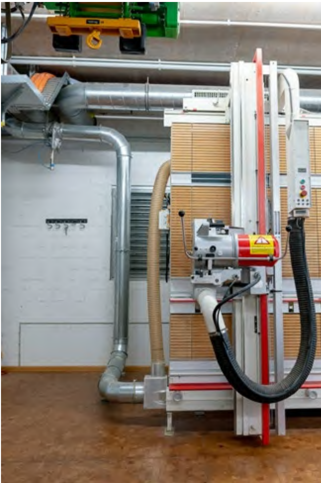
Abb. 3.1.2-07 Absauganlage an einer vertikalen Plattensäge
