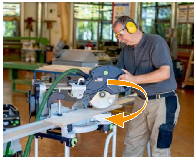
Abb. 3.1.4-05 Sägevorgang beim Einsatz der Zugfunktion
