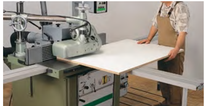
Abb. 3.1.8-04 Handvorschub = Arbeiten mit dem Vorschubapparat
