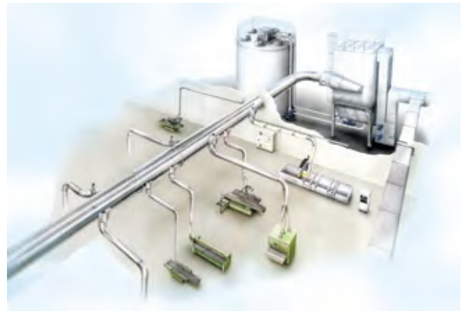
Abb. 2.2.3-02 Komponenten und prinzipieller Aufbau einer Absauganlage
