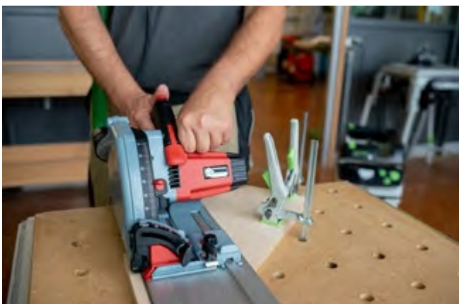
Abb. 3.3.1-10 Sägevorgang mit sicher fixiertem Werkstück
