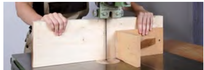
Abb. 3.1.6-08 Quersägen hochkant stehender Werkstücke
