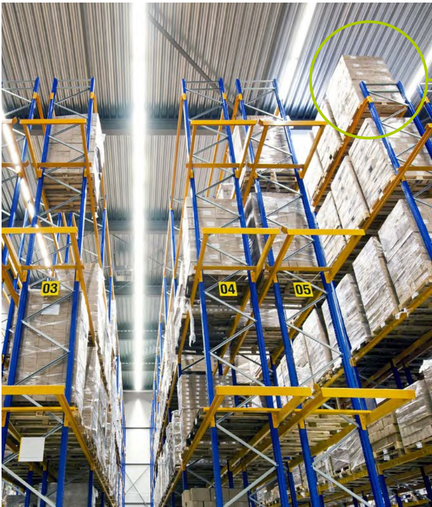
Abb. 110 Seitliche Sicherung gegen Herabfallen
