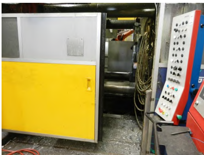
Abb. 21 Schutztür mit Schließkantensicherung
