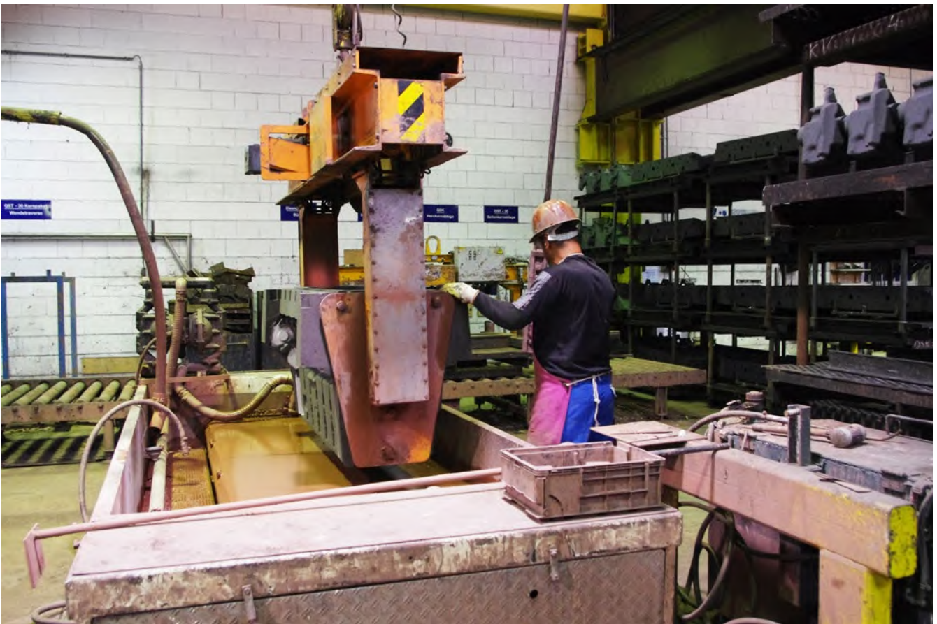
Abb. 19 Schlichten eines Kernpakets
