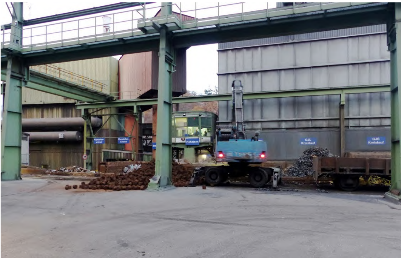
Abb. 15 Gattierung für Kupolofenschmelzbetrieb
