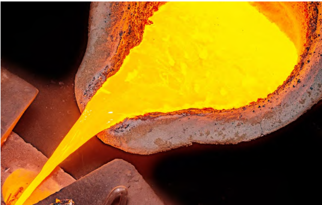
Abb. 9 Abguss einer Metallschmelze
