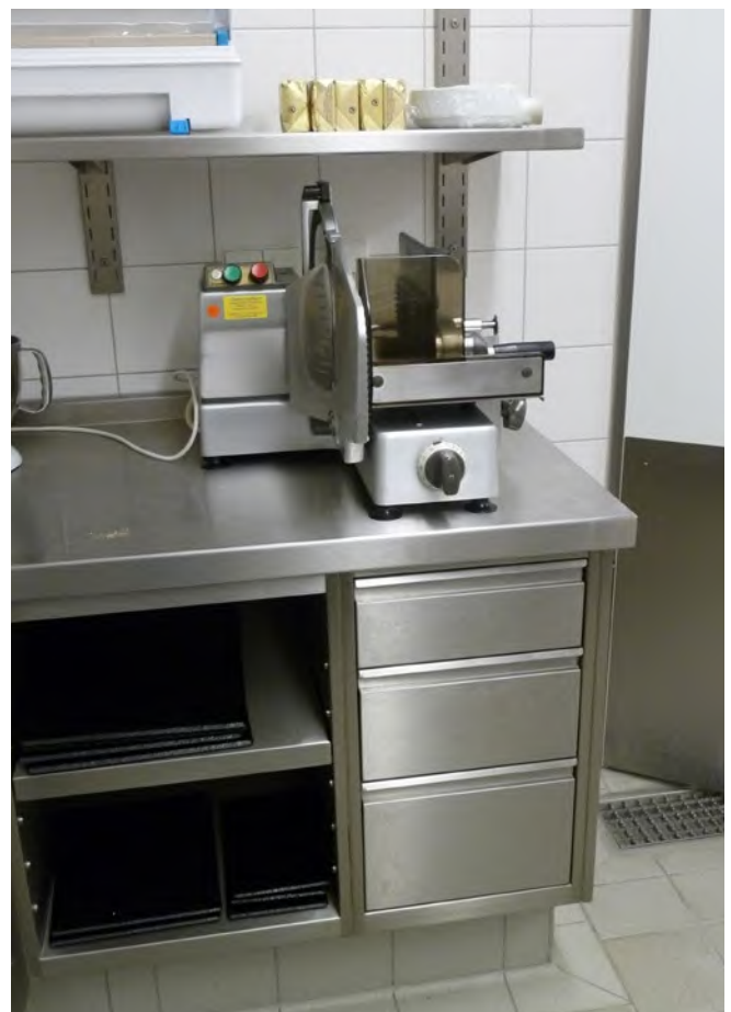
Abb. 8 Geeignete Aufstellung der Aufschnittschneidemaschine
