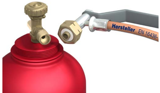
Abb. 22 Absperrventil der Großflasche und Hochdruckschlauchanschluss (PS 30 bar) mit Flachdichtung in der Sechskantmutter
