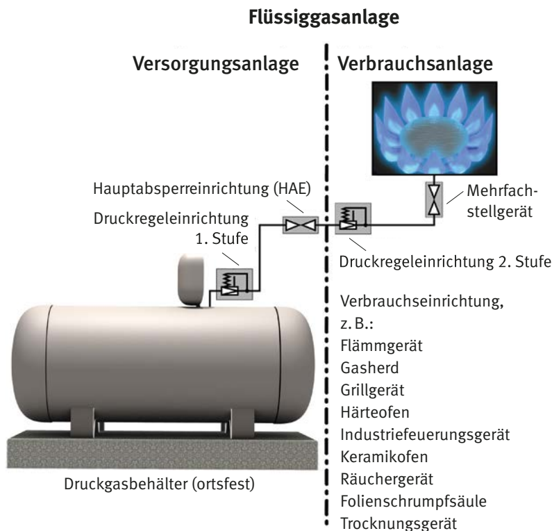
Abb. 5 Flüssiggasanlage mit Versorgung aus ortsfestem Druckgasbehälter (Flüssiggasbehälter) (Druckregleinrichtung 1. Stufe als Bestandteil der Versorgungsanlage und Druckregleinrichtung 2. Stufe als Bestandteil der Verbrauchsanlage, Verzicht auf Darstellung des Behälterabsperrentils)
