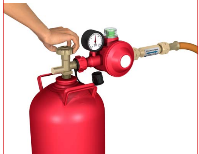
Abb. 30 Zudrehen des Flaschenventils (Flaschenventil = Hauptabsperreinrichtung, Drehrichtung rechts)
