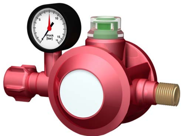
Abb. 23 Druckregleinrichtung S2SR mit TAE, Manometer und Sichtanzeige; Sichtanzeige: grün bei 50 mbar Betriebsdruck rot bei Ausgangsdruck über 80 mbar
