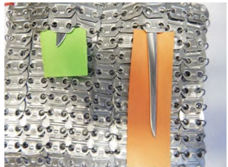
Abb. 31 Extrem spitze Messer durchdringen das Schutzgewebe (rot), spitze Messer werden durch das Schutzgewebe zurückgehalten (Grün)
