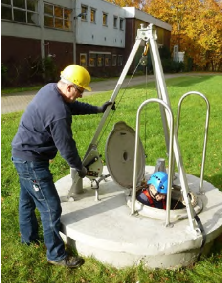
Abb. 27 Rettung mittels Hörsicherungsgerät mit Rettungshubfunktion
