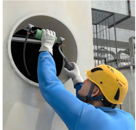
Abb. 20 Probenahme mittels Gassammelrohr
