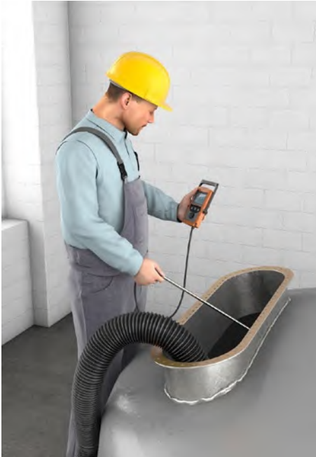
Abb. 19 Probenahme mittels Gasmessgerät
