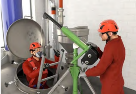
Abb. 22 Rettungswinde, hier als Schutz gegen Absturz eingesetzt
