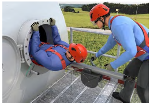
Abb. 26 Seiteneinstieg mittels spezieller Halteung des Rettungshubgerätes
