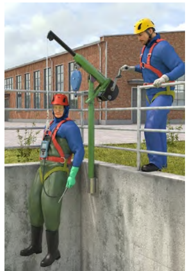
Abb. 25 Zugang mittels Winde zur Personen- beförderung und Auffanggurt
