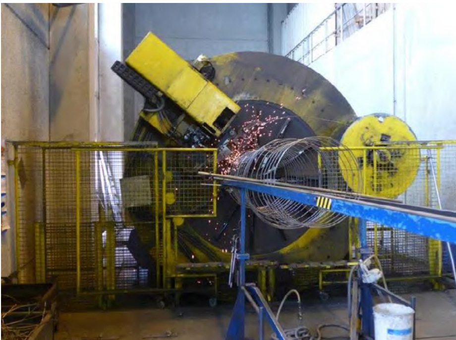
Abb. 40 Schweißautomat für die Bewehrungskörbe
