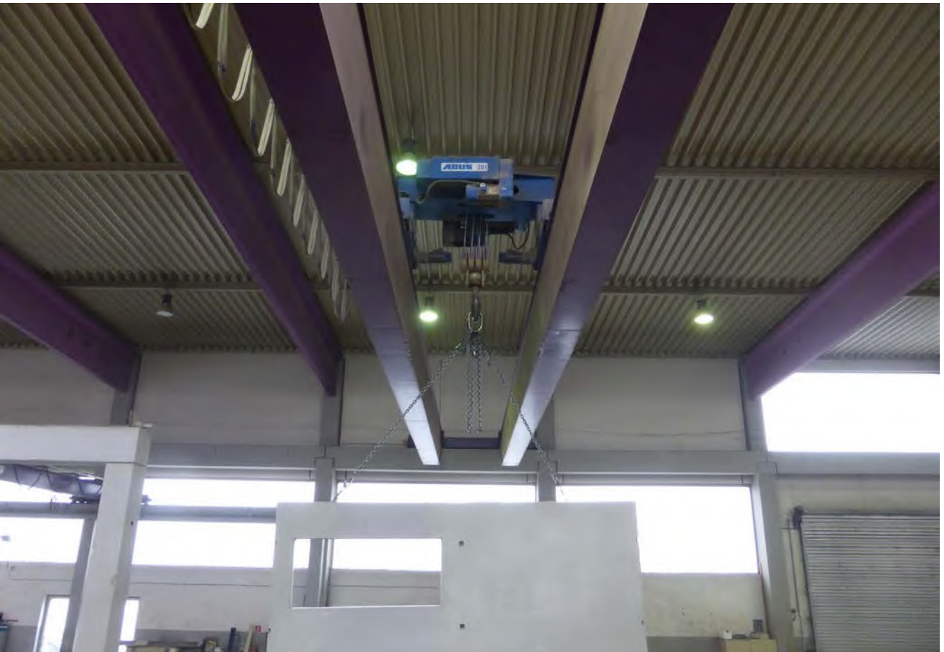
Abb. 105 Transport eines Doppelwandelementes mit Hallenkran
