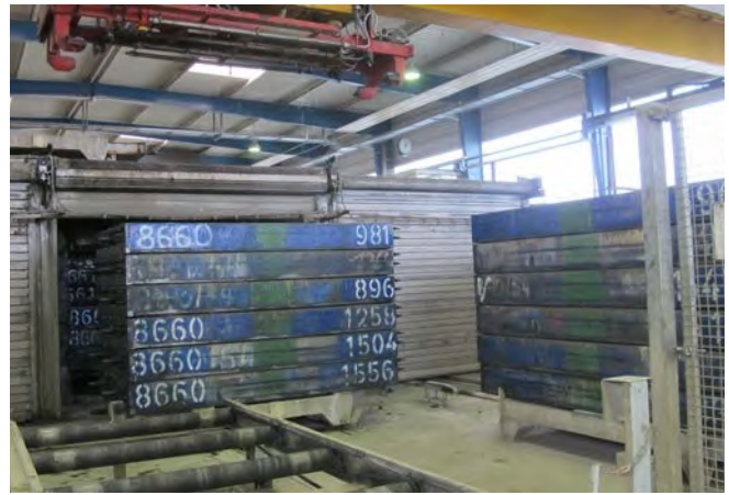
Abb. 77 Verschieben der Schalungen in die Härtekammer
