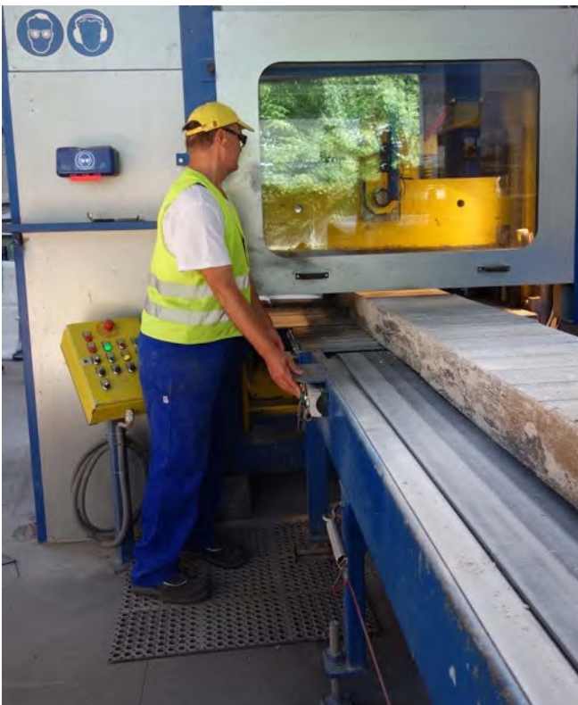
Abb. 69 Zweihandbedienung einer Spaltanlage
