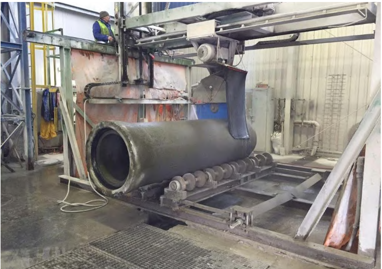
Abb. 54 Steinsäge im Einsatz
