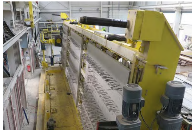
Abb. 15 Verfahren 2 – Wenden mittels Vakuumwenderahmen
