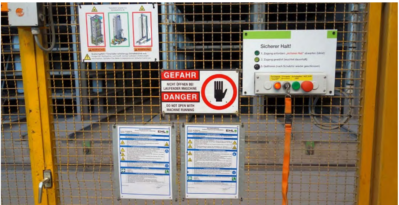
Abb. 57 Zugang zum Gefahrenbereich mit Zuhaltung und Sicherheitshinweisen
