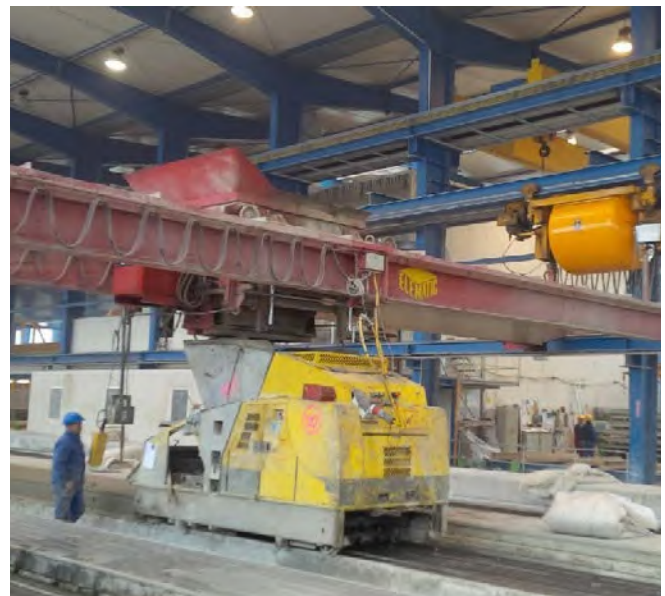
Abb. 38 Betonverteiler für Spannbetonbahn
