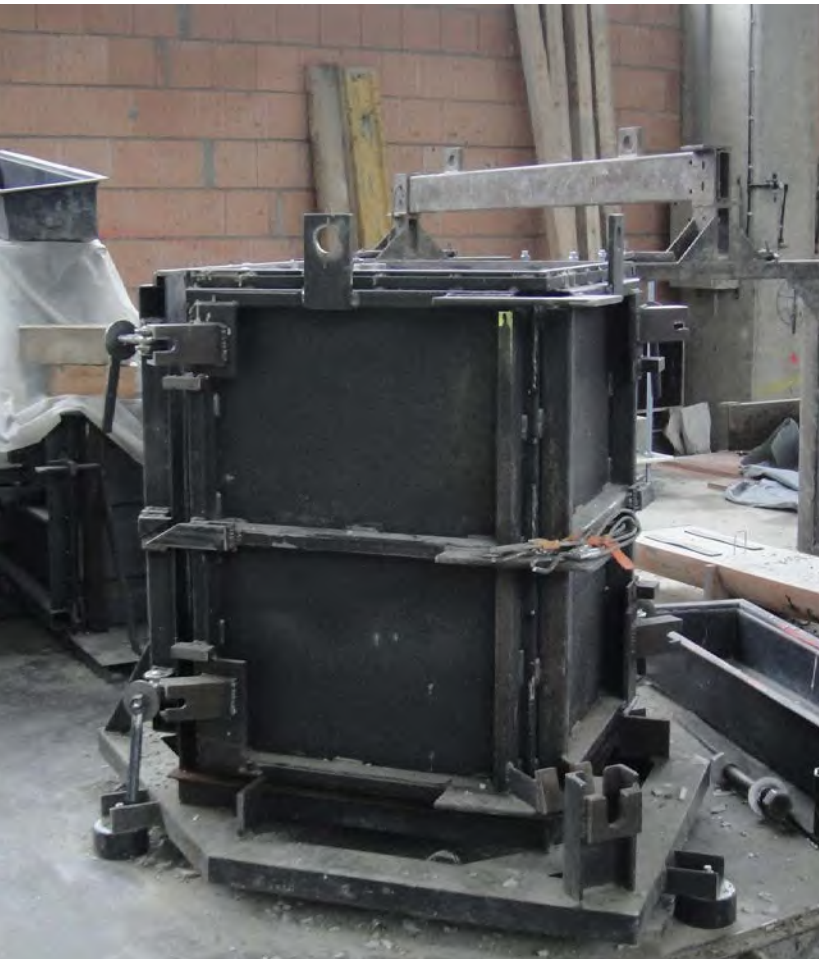
Abb. 94 Schalung für Betonsonderteil
