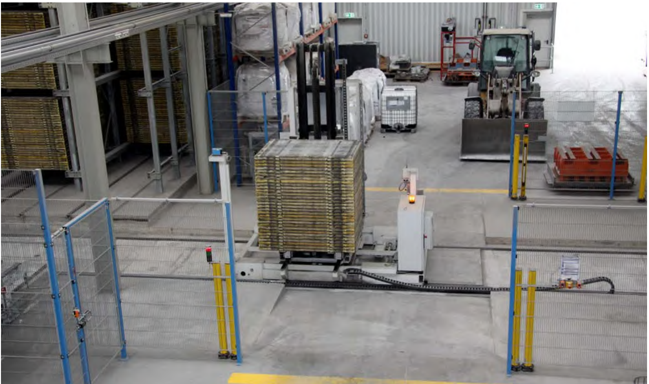
Abb. 67 abgesicherter Kreuzungsbereich beim Transport von Brettstapeln
