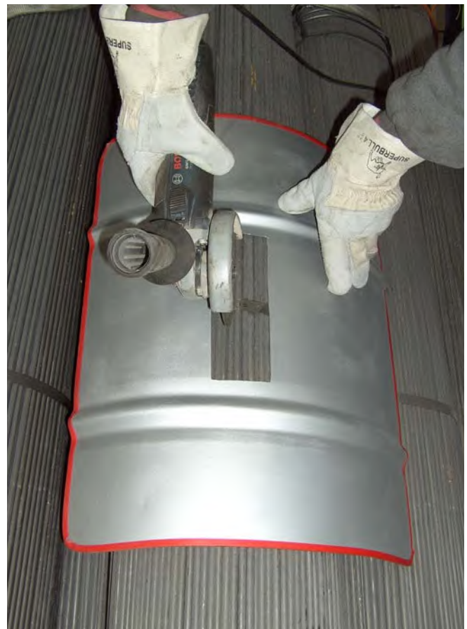
Abb. 26 sicheres Öffnen der Umreifungsbänder
