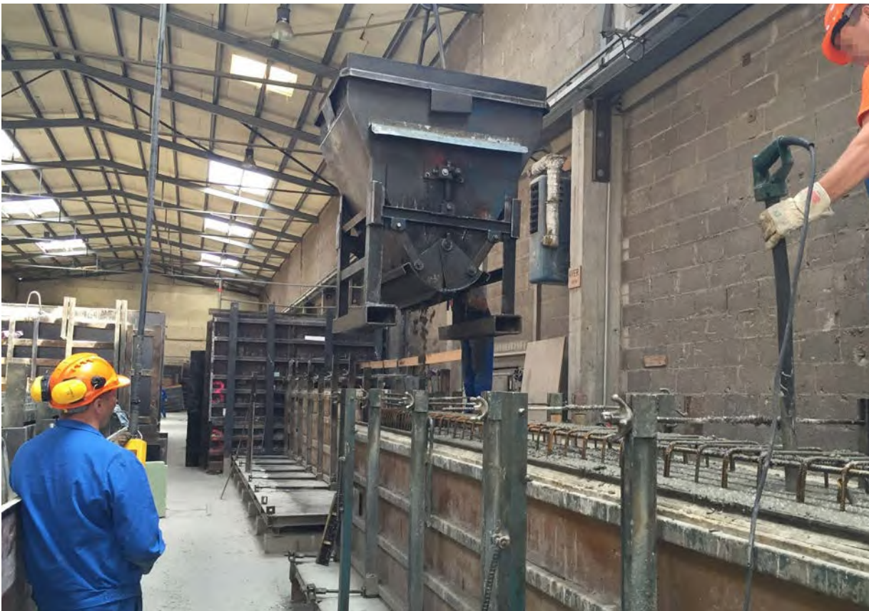
Abb. 31 Verdichtungsarbeiten mit Innenrüttler
