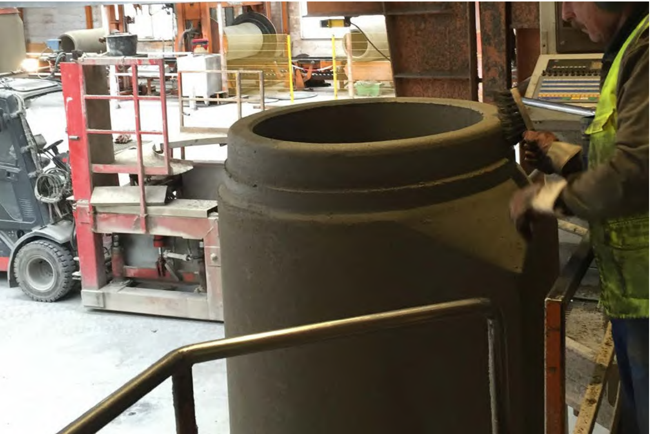
Abb. 50 Nacharbeit der Spitzenden der frisch geformten Rohre
