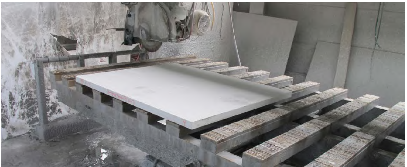
Abb. 96 Sägeeinrichtung für den Zuschnitt einer Betonwerksteinplatte
