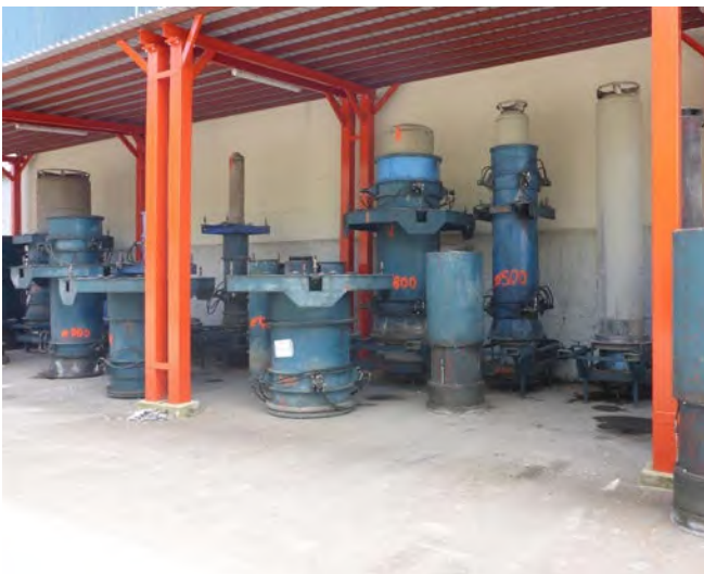
Abb. 45 Lagerung von Rohrschalungen
