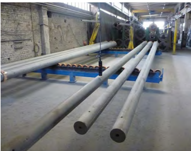
Abb. 93 sichere Lagerung von Schleuderbetonfertigteilen
