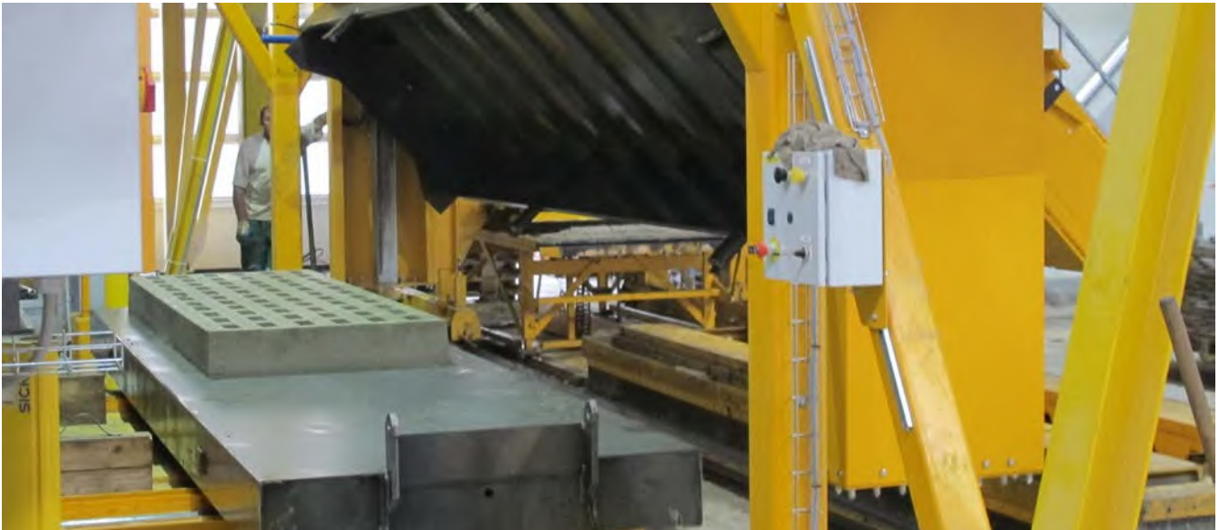
Abb. 100 Wenden des gefertigten Betonelementes
