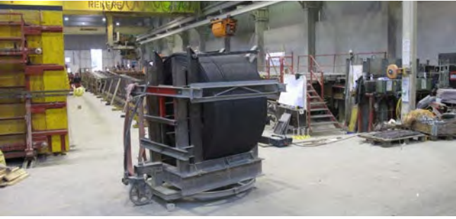
Abb. 29 Vorrichtung zum Transport und Abwickeln der Coils
