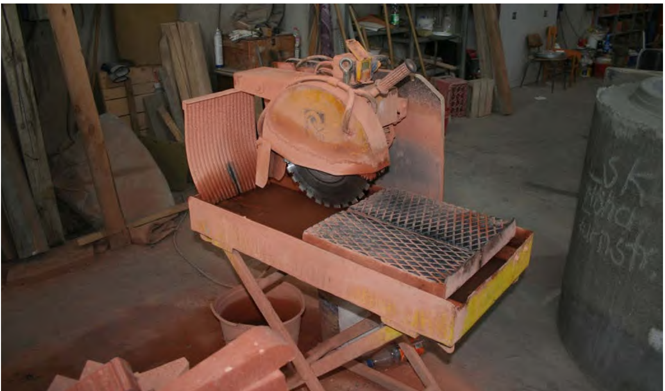
Abb. 53 Säge für Klinker (Spritzschutz)
