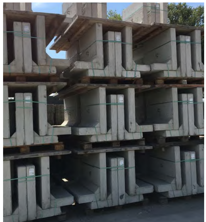
Abb. 112 Lagerung von Winkelstützen
