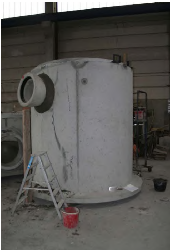
Abb. 55 Rohransatzstück mit Abstützung
