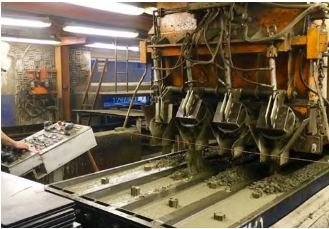
Abb. 76 Betonieren der Betonschwellen
