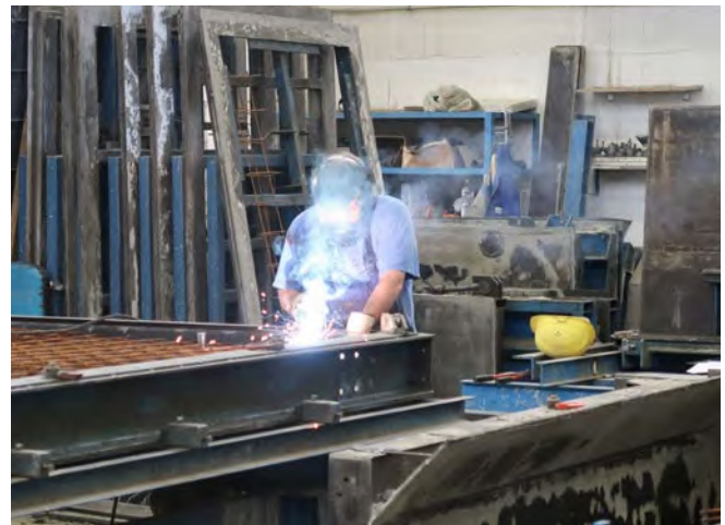
Abb. 81 NEGATIV Einwirkung von Schweißrauch und UV-Strahlung
