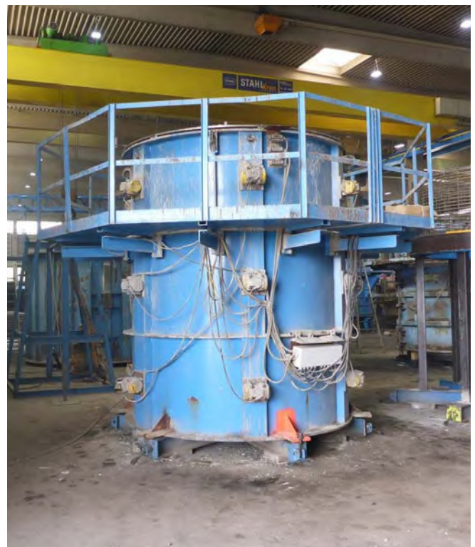
Abb. 49 hochgelegener Arbeitsplatz an Formen für Einzelfertigung
