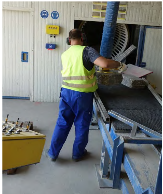
Abb. 70 Gekapselte Trommelanlage und Hebehilfe
