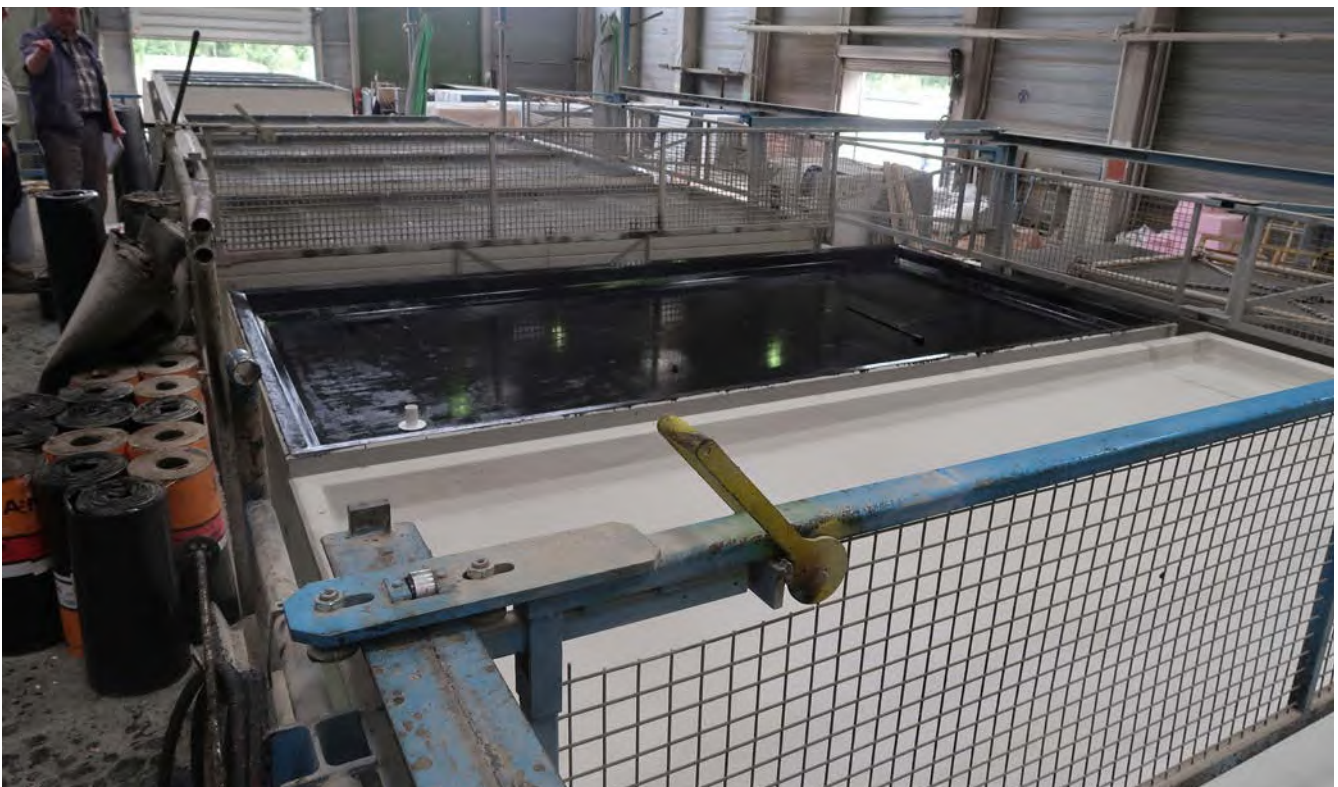
Abb. 85 bewegliche und arretierbare Schutzgitter oberhalb der Transportstrecke für Fertiggaragen
