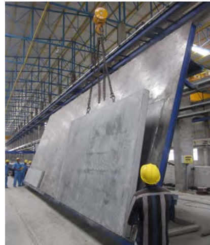
Abb.13 Kipptisch für flächige Betonfertigteile
