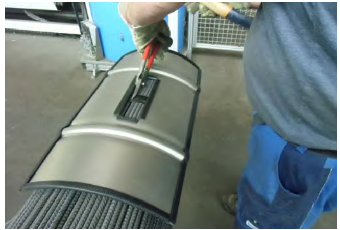
Abb. 42 Einrichtung zum sicheren Aufschneiden eines Stabstahlgebindes
