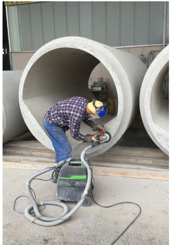
Abb. 51 Nachbearbeitung mit einem Winkelschleifer und Absaugung
