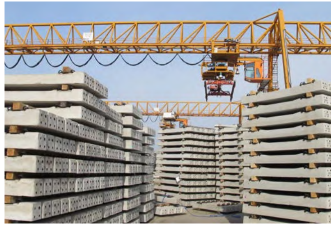
Abb. 79 Lagerplatz für die Betonschwellen
