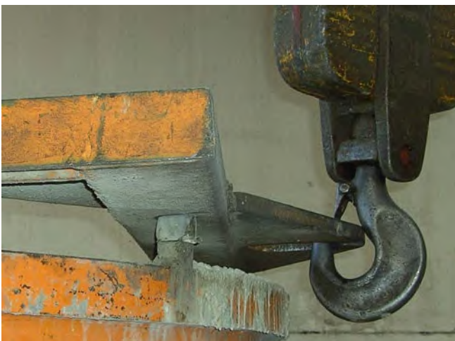
Abb. 106 Kranhaken mit Sicherung
