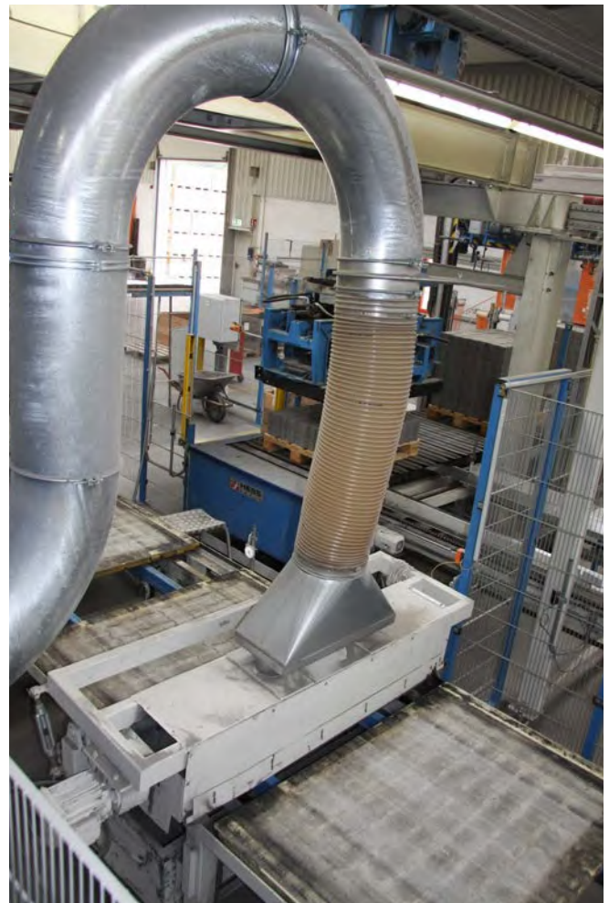
Abb. 68 Brettreinigung mit Absaugung
