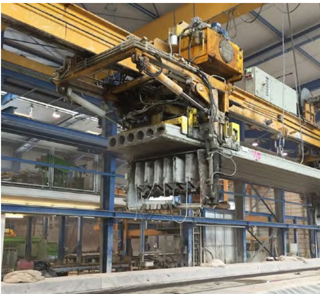
Abb. 37 automatisches Bohren der Entwässerungslöcher
