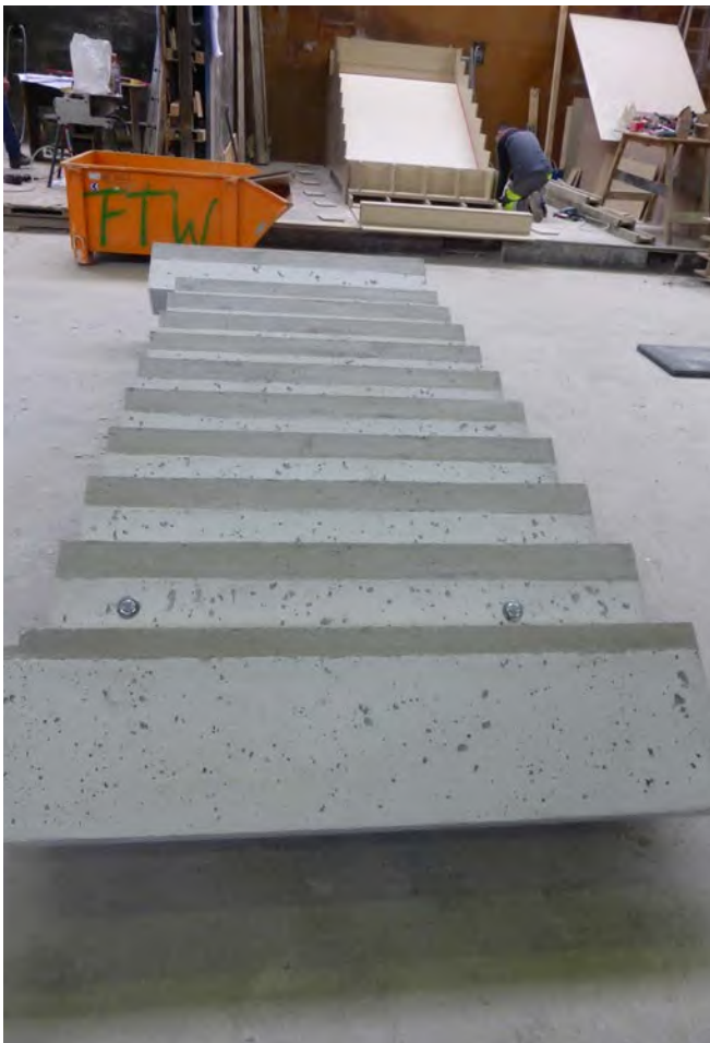
Abb. 4 Trepplauf als Betonfertigteil
