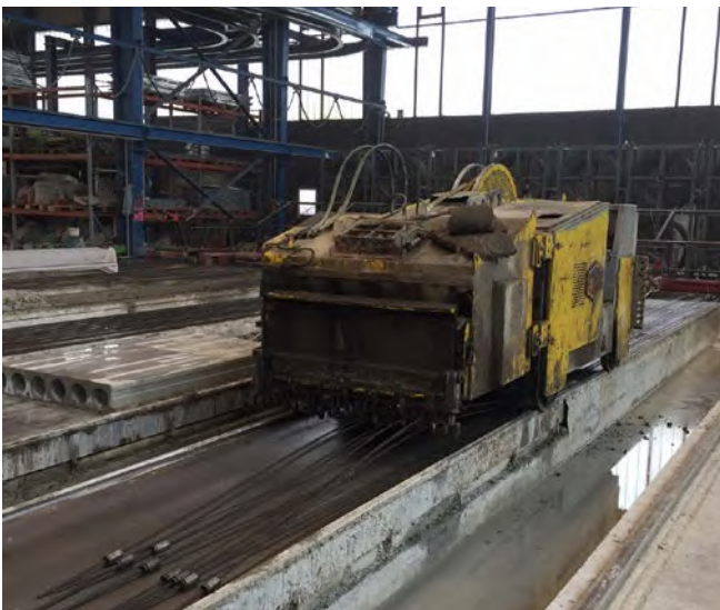
Abb. 35 Universalwagen beim Ausziehen der Spannritzten
