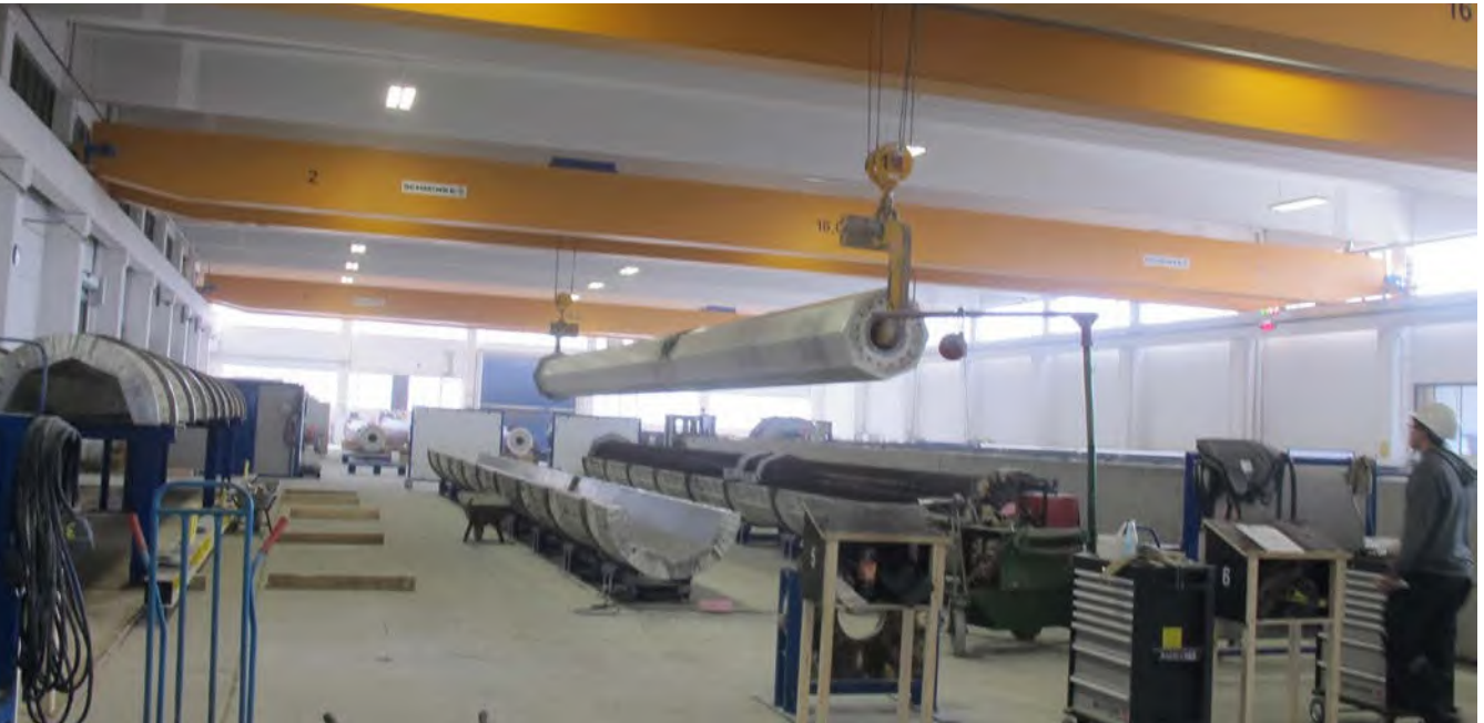
Abb. 92 Entnahme des Betonfertigteils aus der Schalung
