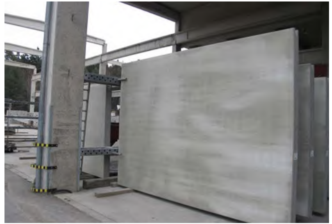
Abb. 110 sichere Lagerung von flächigen Betonfertigteilen
