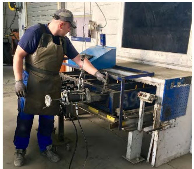
Abb. 75 Spannstahlmessung mit Schutzschürze und Prallwand
