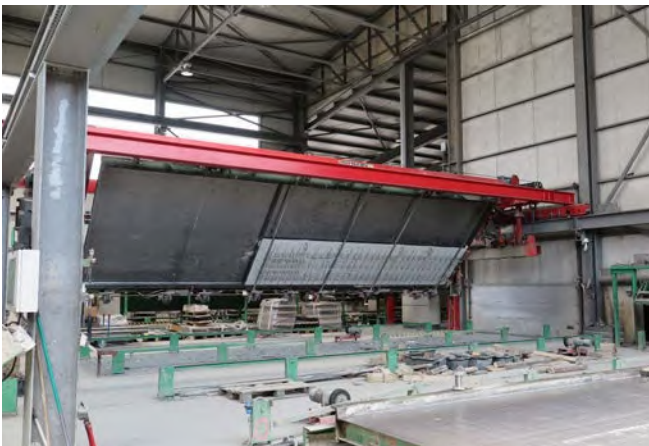
Abb. 14 Verfahren 1 – Wenden der gesamten belegten Palette
