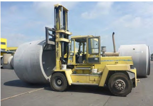
Abb. 107 Stapler mit großformatigem Rohr
