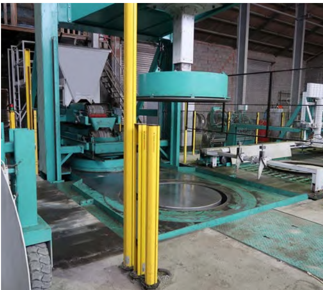
Abb. 48 regelgerechte Absicherung eines automatisierten Fertigungsprozesses
