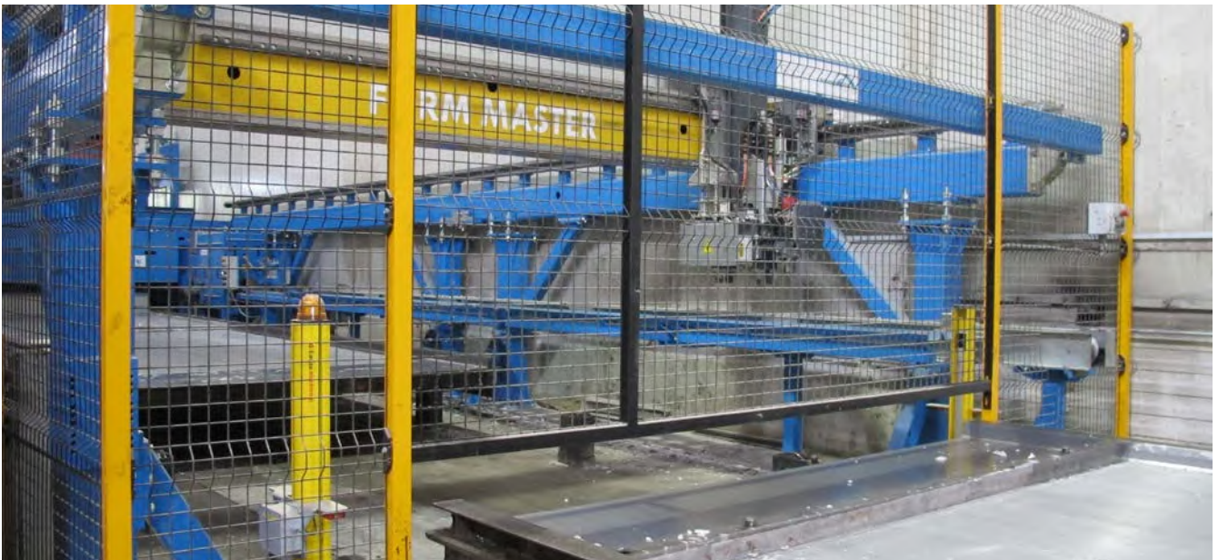
Abb. 19 abgesicherter automatischer Betrieb
