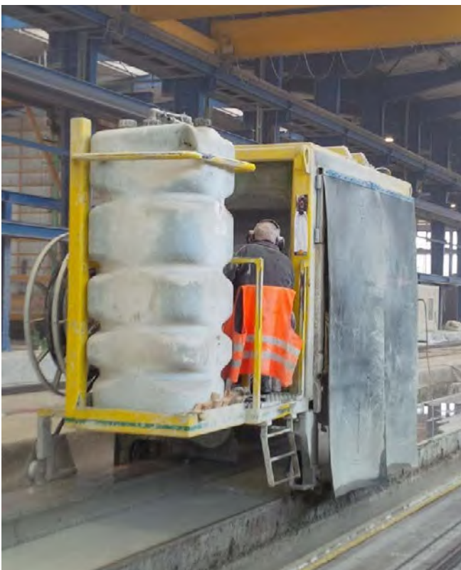
Abb. 39 Säge für Spannbetonbahn
