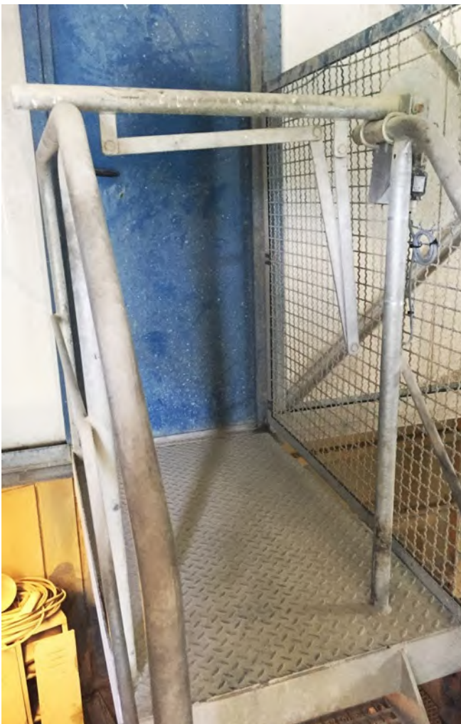
Abb. 34 NEGATIV: Leicht umgehbare Absicherung zum Schrapper
