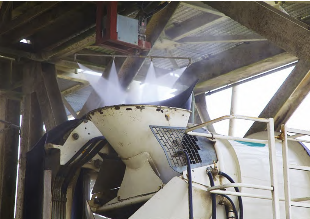
Abb. 47 Technische Lösung zur Reinigung des Einlauftrichters am Fahrmischer
