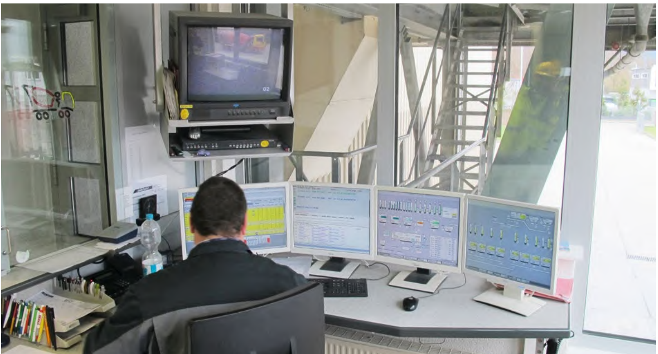
Abb. 15 Moderner Steuerstand im Frischbetonwerk
