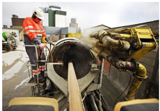
Abb. 48 Hochdruckwasserstrahlsysteme zur Fahrmischertrommel-Reinigung
