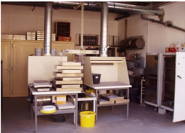
Abb. 53 Labor für Gesteinskörnungen mit Absaugung
