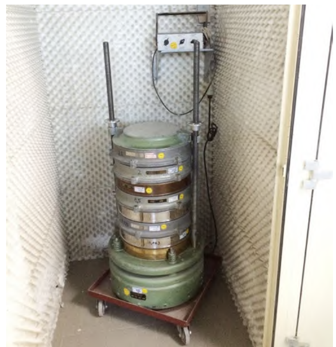
Abb. 55 Labor Siebmaschine im Schallschutzschrank
