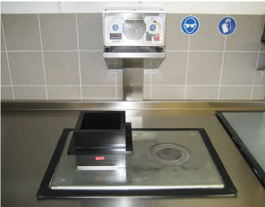
Abb. 56 magnetischer Rütteltisch – reduziert Lärmbelastung
