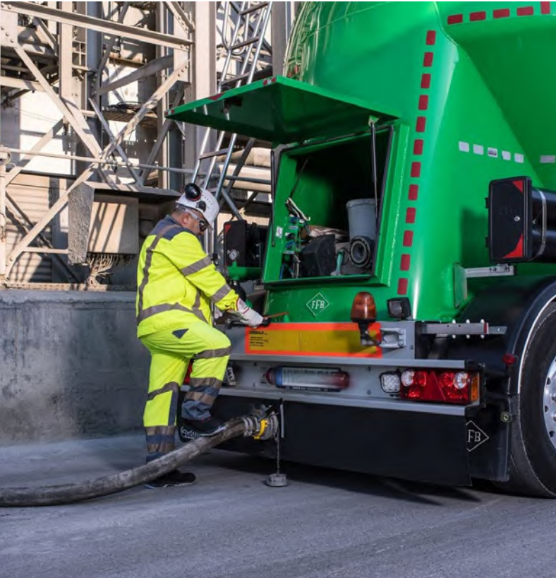
Abb. 6 Vorbereitung zur Entladung von Zement
