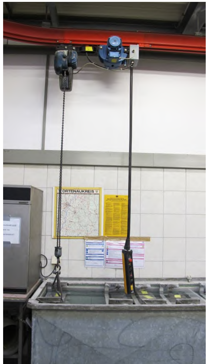
Abb. 58 Hebehilfe für schwere Probekörper
