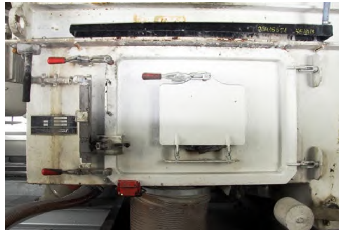
Abb. 22 Betonmischeröffnung mit elektr. Verriegelung und verschlossener Sichtklappe und dahinterliegendem Schutzgitter
