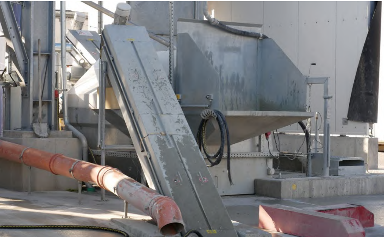
Abb. 35 Recyclinganlagen mit abgedeckten Absetzbecken
