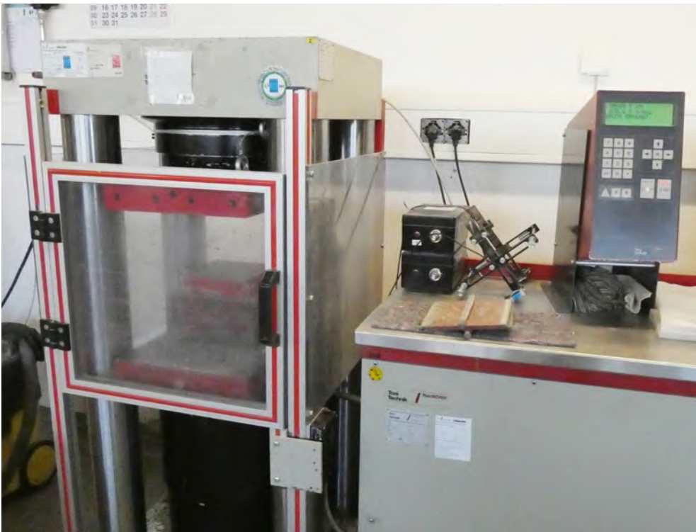
Abb. 60 Prüfpresse mit Splitterschutz
