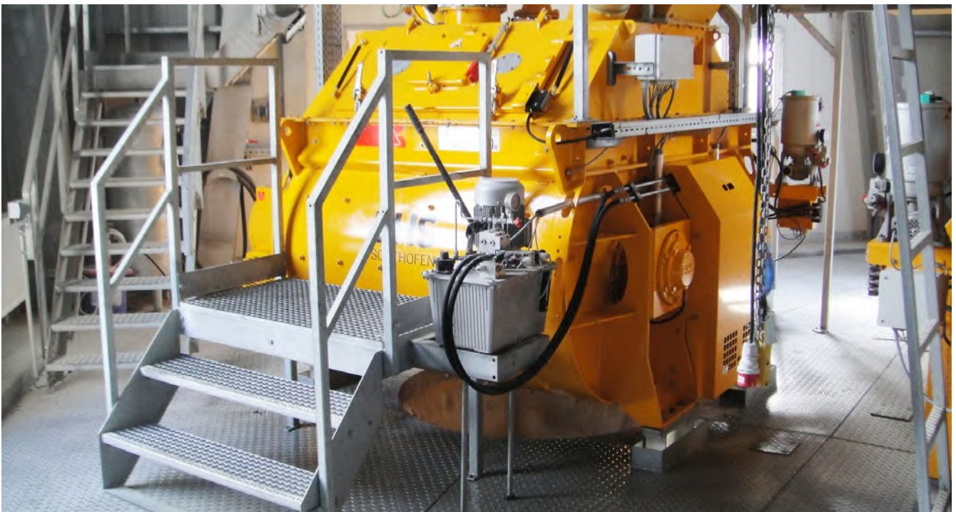
Abb. 31 Betonmischer mit Einstiegshilfe – Podest
