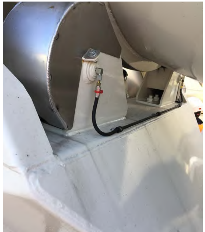
Abb. 8 Zentralschmierung Anschluss Tragrolle
