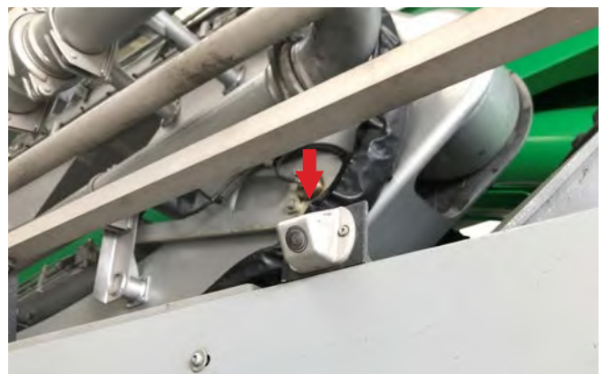
Abb. 31 Seitenkamera an der Betonpumpe
