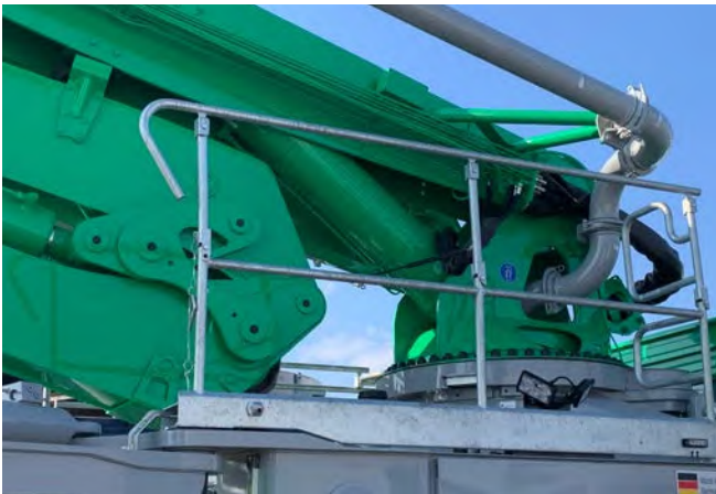
Abb. 24 Arbeitspodest und Absturzsicherung an der Betonpumpe
