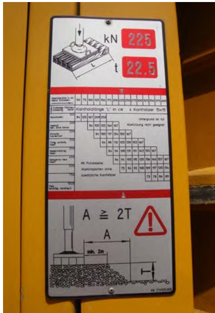
Abb. 32 Entscheidungshilfe für erforderliche lastverteilende Unterlagen
