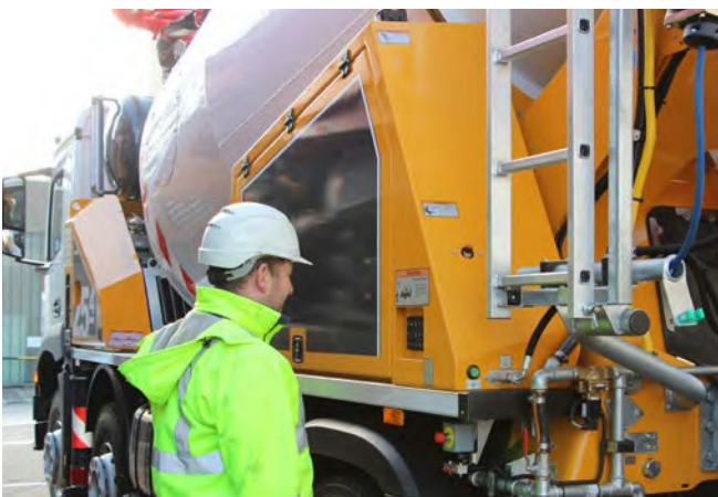
Abb. 26 Abfahrtskontrolle der Fahrmischerbetonpumpe durch den Fahrer
