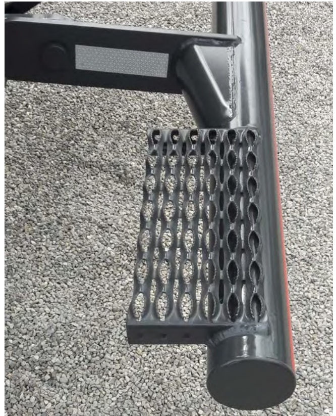
Abb. 23 Rutschhemmend gestaltete Standfläche
