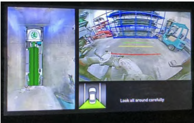
Abb. 28 Display in der Fahrerkabine für Abbiegeassistenz und „BirdView“-Kamerasystem
