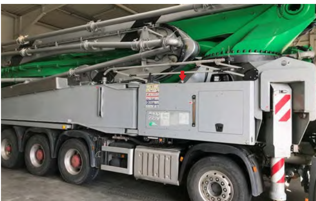
Abb. 30 Seitenkamera an der Betonpumpe
