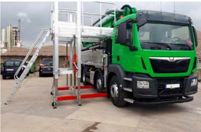
Abb. 41 Arbeitsbühne für die Instandsetzung einer Betonpumpe
