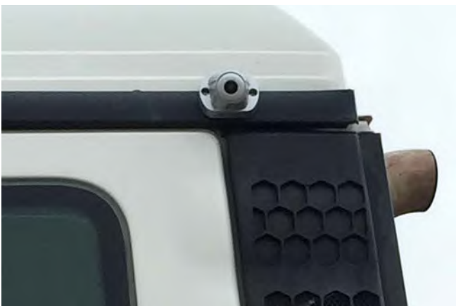
Abb. 15 Seitenkamera an der Fahrerkabine von insgesamt sechs Kameras am Fahrzeug
