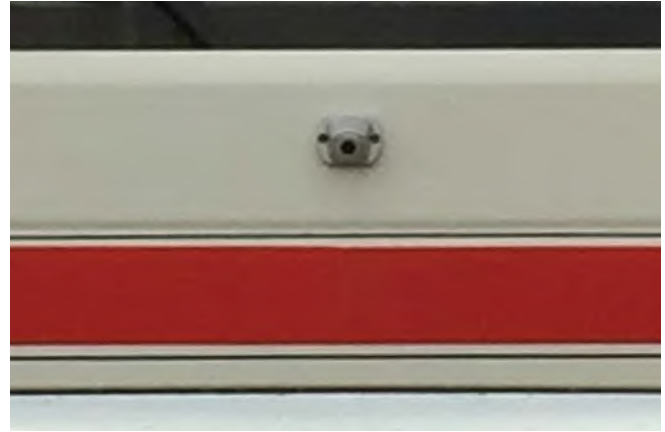
Abb. 14 Frontkamera am Fahrzeug von insgesamt sechs Kameras am Fahrzeug
