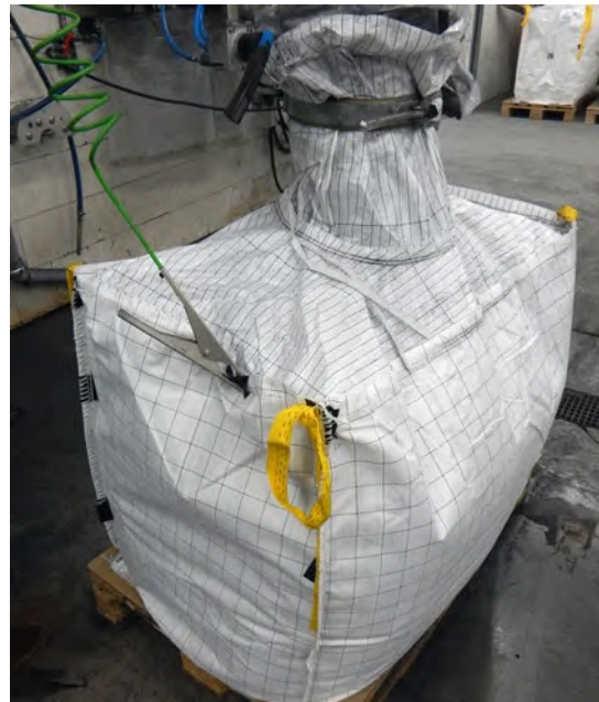
Abb. 63 Ableitfähiger FIBC, Typ C mit Erdung
