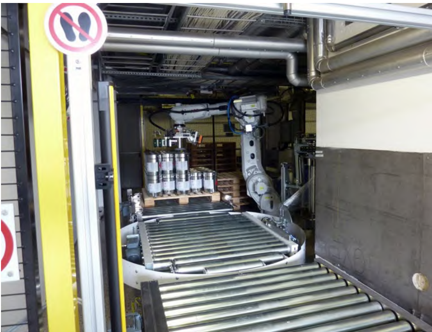
Abb. 41 Palettierroboter mit Sicherheitslichtschranke
