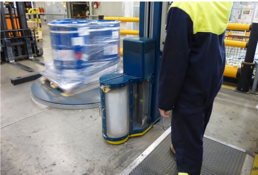
Abb. 40 Halbautomatische Wickelmaschine (Verpackungsmaschine) mit Trittmatte
