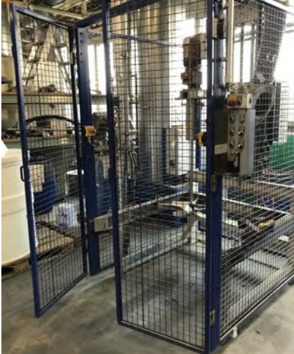
Abb. 9 Schutzgitter mit elektrischer Verriegelung als trennende Schutzeinrichtung
