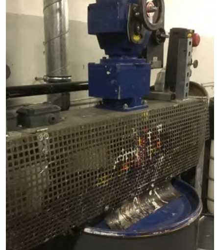
Abb. 11 Wellenschutz eines kleinen Rührwerks
