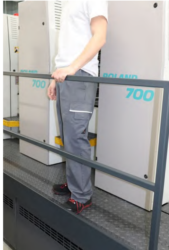
Abb. 30 Abnehmbares Geländer an der Arbeitsplattform einer Druckmaschine
