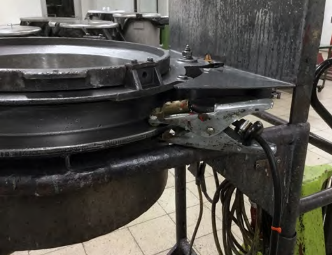
Abb. 62 Erdungszange und Überwachungseinrichtung
