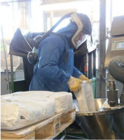
Abb. 6 Produktionsanlage mit Sackschütte
