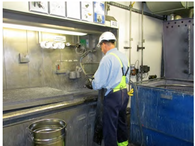
Abb. 49 Reinigungstisch mit Absaugung, Lenkdüsen und Glasspritzschuttscheibe in Gesichtshöhe
