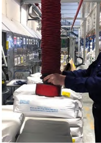
Abb. 7 Vakuümheber zum Umsetzen von Säcken
