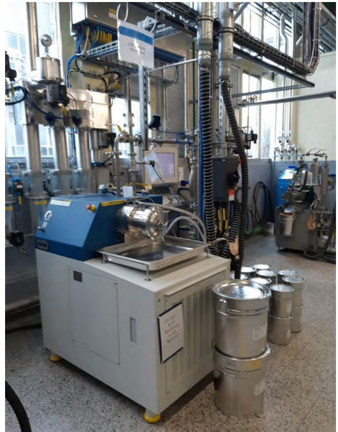
Abb. 19 Rührwerksmühle im Technikumsmaßstab
