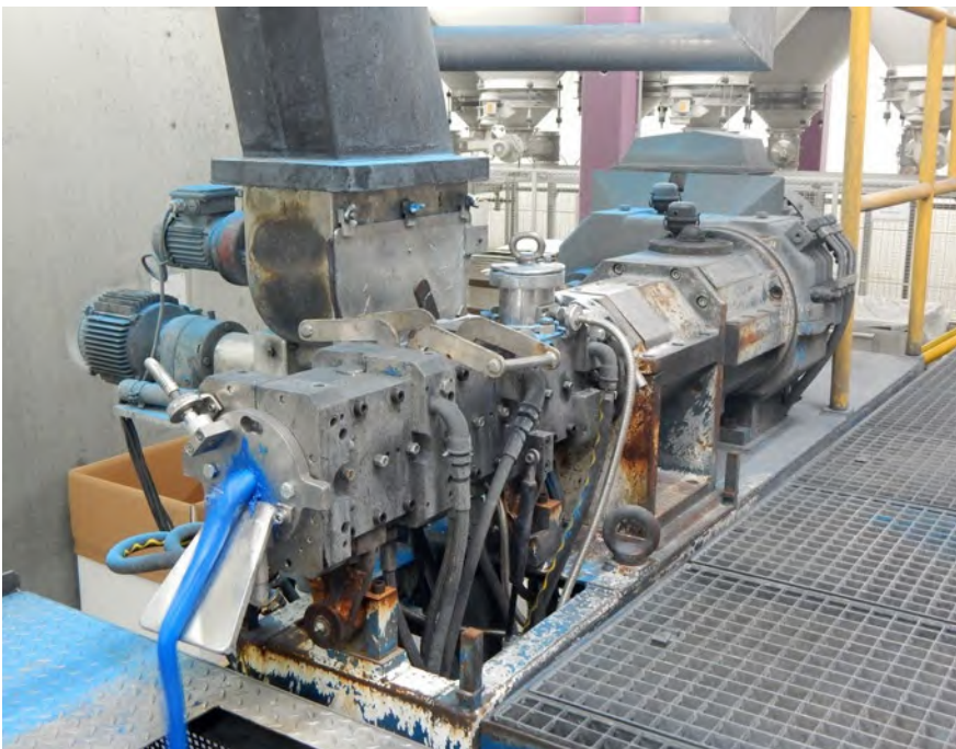
Abb. 55 Extrusionsanlage zur Herstellung von Pulverlacken
