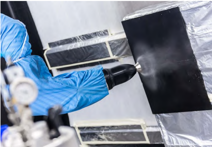
Abb. 28 Lackierroboter zur Beschichtung von Mustern
