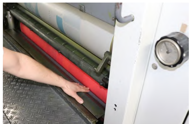
Abb. 31 Fingerschutzabdeckung an Druckwalze
