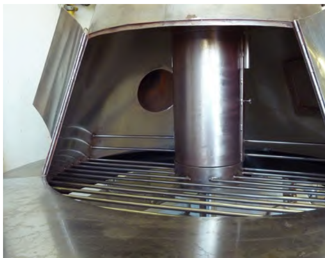
Abb. 13 Innen liegender Wellenschutz mit durch Schutzrohr schwer erreichbarer Welle
