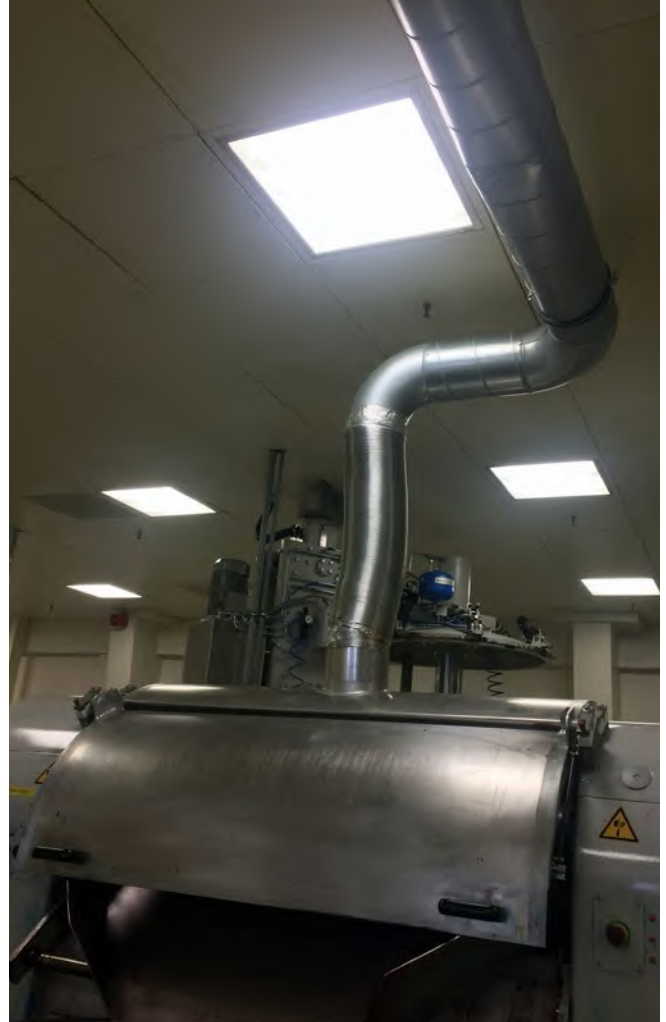
Abb. 23 Vollständig abgedeckter Dreiwalzenstuhl mit Absaugung
