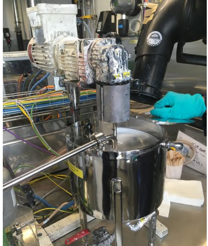
Abb. 20 Vorlagebehälter für Laborrührwerksmühle mit Absaugung
