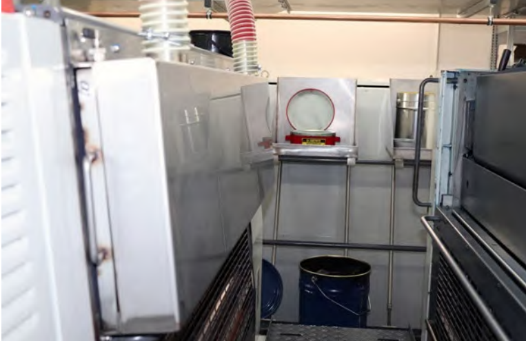
Abb. 32 Aerosolabsaugung an Druckwalze, darunter Gitter als Berührungsschutz
