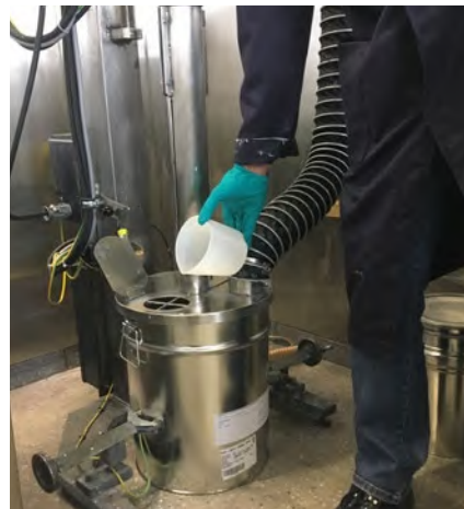
Abb. 16 Laborrührwerk mit Wellenschutzhülse, Erdung und Absaugung (Gebinde 30 Liter)
