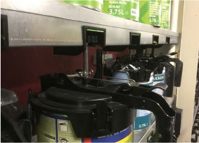
Abb. 15 Rührregale für Kleingebinde mit Wellenschutz
