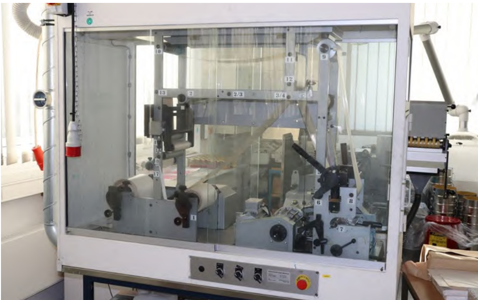
Abb. 29 Labordruckmaschine mit Einhausung und Schiebetüren
