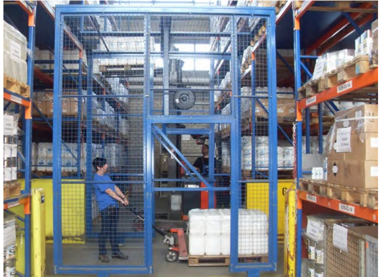
Abb. 45 Sicherung von Verkehrswegen im Lager
