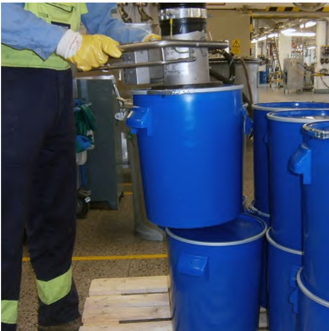
Abb. 34 Vakuümheber für die Handhabung von Hobbocks
