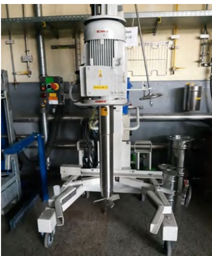
Abb. 12 Rührwerk mit teleskopartigem Rührwellenschutz
