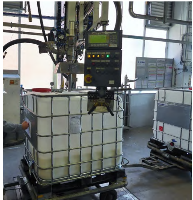
Abb. 39 Containerabfüllung mit Erdungsüberwachung
