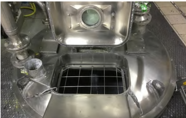
Abb. 4 Schutzgitter an der Einfüllöffnung eines Behälters
