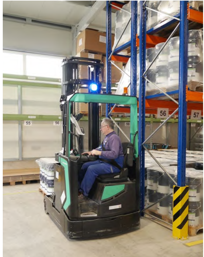
Abb. 43 Gabelstapler mit Bluespot
