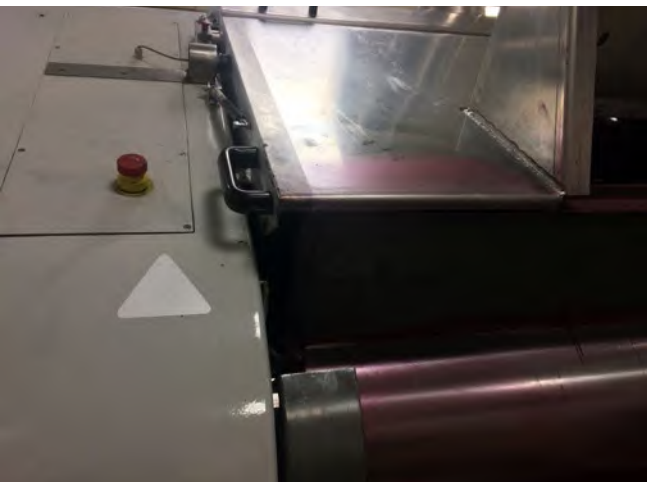
Abb. 22 Verriegelung der Schutzhaube an der Dreiwalze
