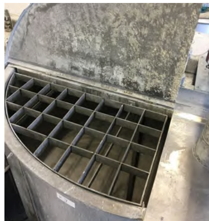
Abb. 54 Reaktionsbehälter mit Schutzgitter an Einfüllöffnung und Absaugung
