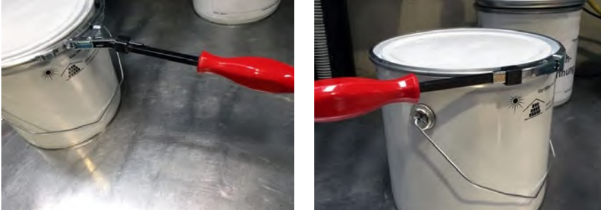
Abb. 33 Werkzeug zum Verschließen von Spannringen
