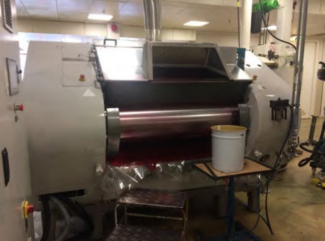
Abb. 21 Dreiwalze mit Schutzhaube und Verriegelung
