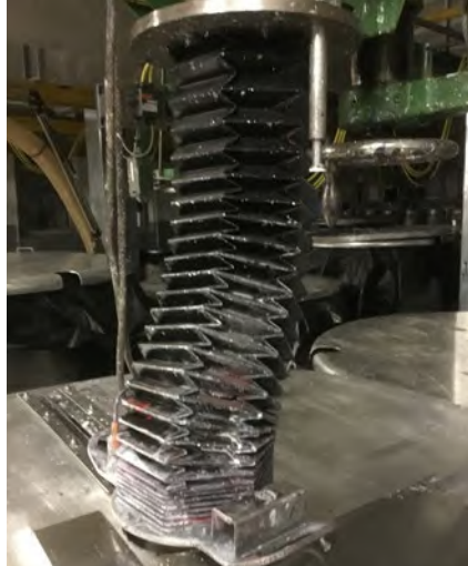
Abb. 10 Wellenschutz eines Rührwerks durch einen Faltenbalg
