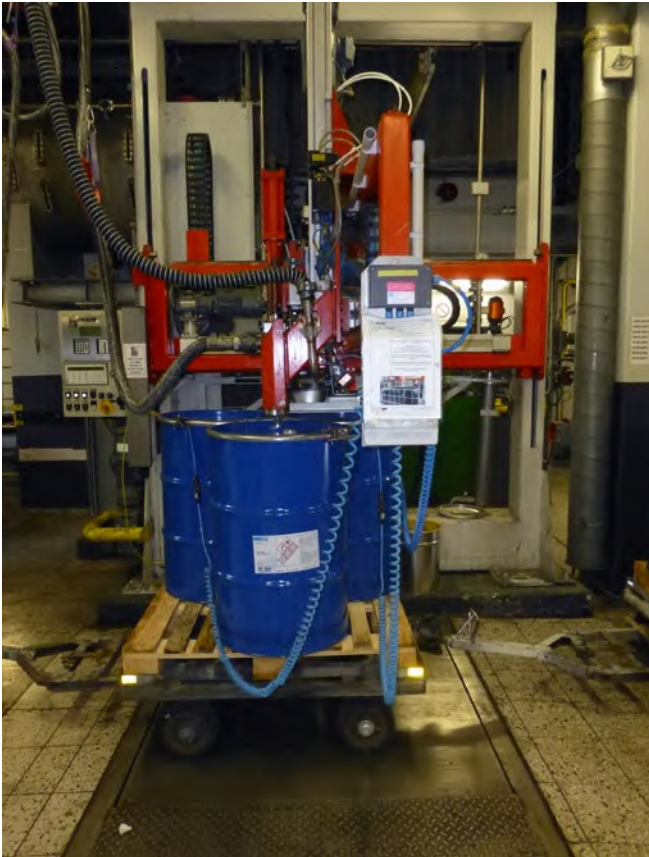
Abb. 38 Fassabfüllung mit Erdungsüberwachung
