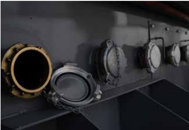
Abb. 45 Sicher verschließbare Öffnungen an einer Mineralwaage zur Entnahme von Proben aus den Mineraltaschen
