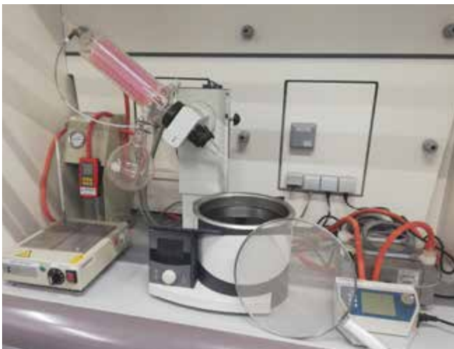
Abb. 86 Bitumenrckgewinnung durch Destillation des Extraktionsmittels am Rotationsverdampfer
