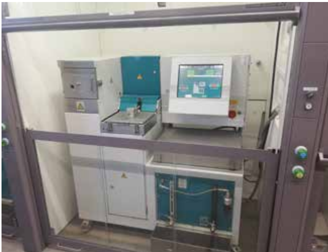
Abb. 85 Geschlossene Extraktions-Anlage nach dem Waschtrommelverfahren (geöffneter Abzug)
