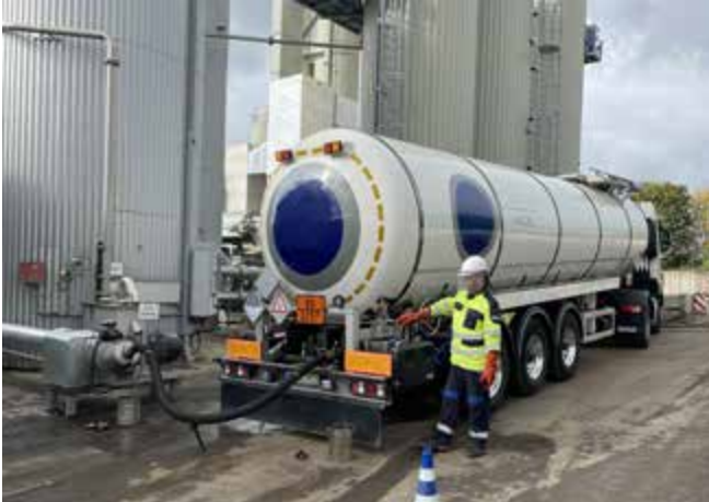
Abb. 15 Mit PSA ausgerüsteter Lieferant, Sicherheitsbereich gekennzeichnet
