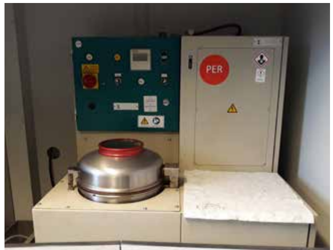
Abb. 88 Bitumensplmaschine mit Tetrachlorethen (PER) betrieben
