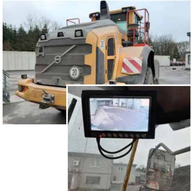
Abb. 3 Radlader mit Rückfahrkamerasystem
