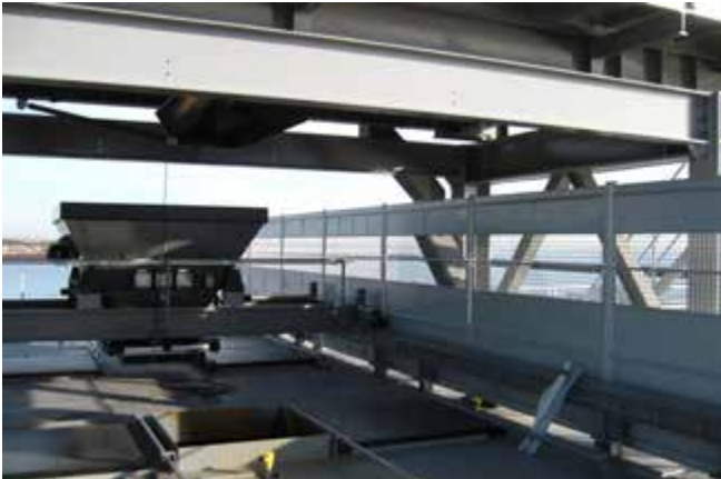
Abb. 52 Bereichssicherung für den Verfahrkübel
