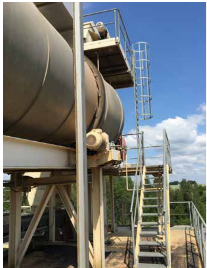
Abb. 58 Sichere Verkehrswege an hochgelegener Paralleltrommel
