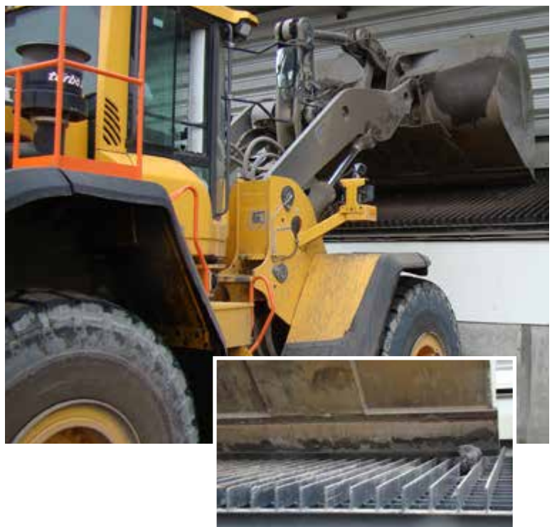
Abb. 30 Radlader reinigt Rost
