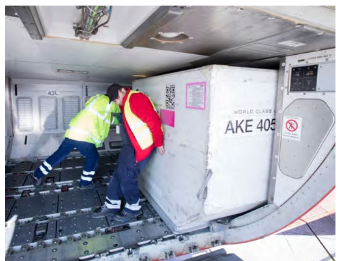
Abb. 54 Positionieren eines Frachtcontainers im Frachtraum
