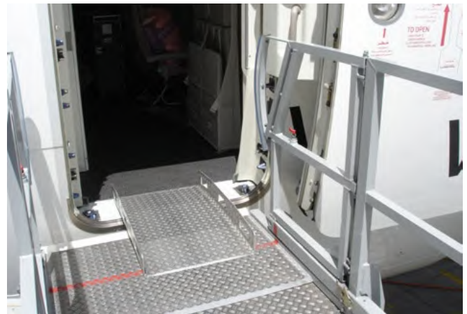
Abb. 75 Zugang zum Luftfahrzeug mit Überladeblech
