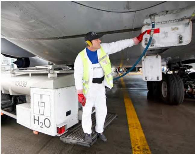
Abb. 80 Frischwasserversorgung am Luftfahrzeug
