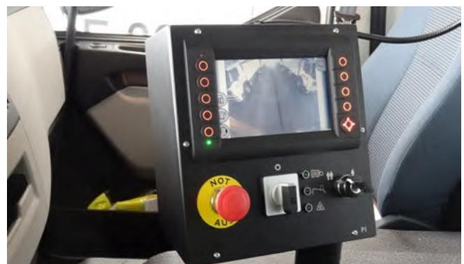
Abb. 24 Rückfahrmonitor in Fahrer cabinen
