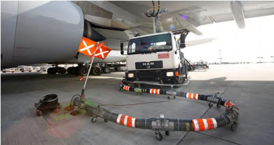
Abb. 84 Betanken eines Luftfahrzeugs mittels Dispenser
