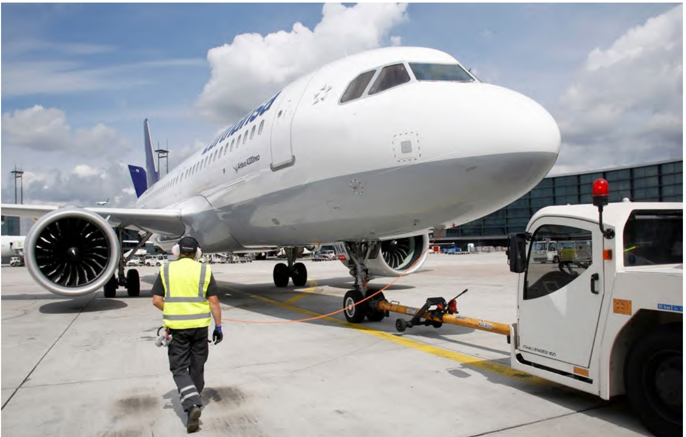
Abb. 94 Pushback (Flugzeugschleppen) mit Walk-Out-Assistent
