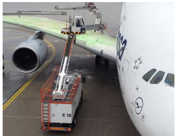
Abb. 88 a und b Enteiserverfahrzeuge im Einsatz: links mit offenem Korb, rechts mit geschlossener Kabine
