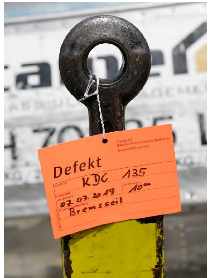
Abb. 60 Kennzeichnung von defekten Arbeitsmitteln
