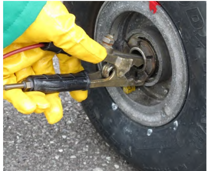
Abb. 83 Anschluss der Potentialausgleichsleitung am Luftfahrzeug
