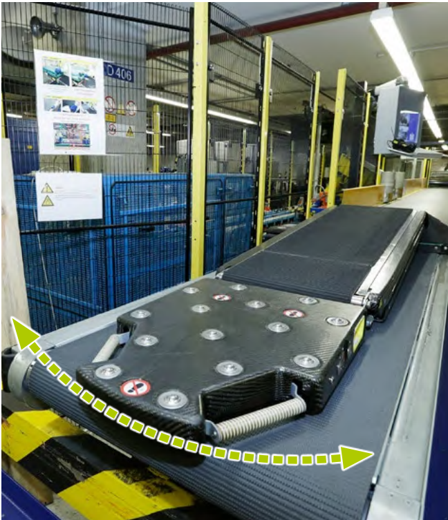
Abb. 66 Ein verstellbarer Ladetisch erleichtert die Gepäckverladung
