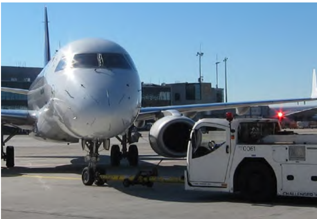
Abb. 96 Pushback mit Schleppstange
