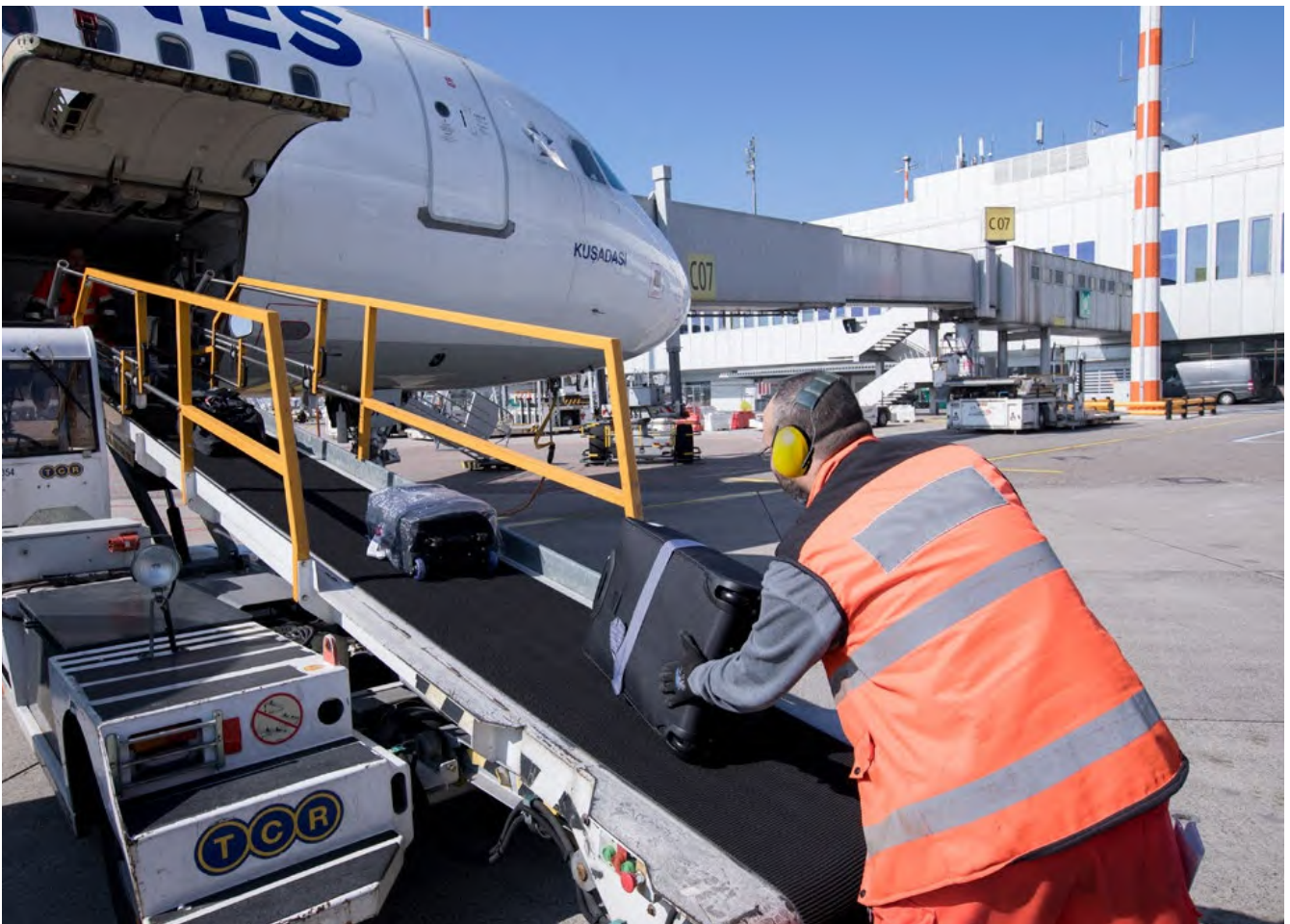
Abb. 50 Be- bzw. Entladen des Frachtraums mittels Förderbandwagen
