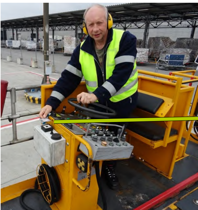
Abb. 72 Elektronische Fahrberechtigung (Easy Key)
