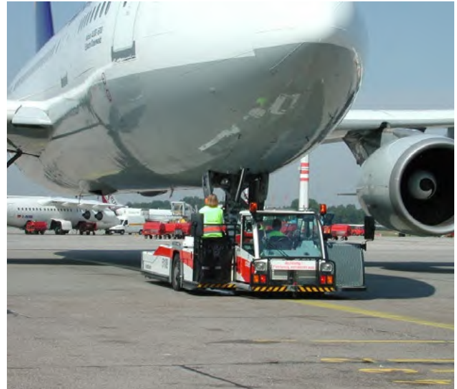
Abb. 97 Flugzeugschlepper mit Mitfahrerstehplatz
