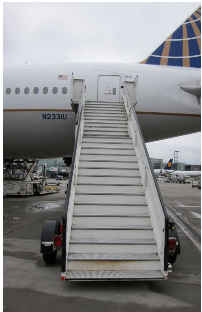
Abb. 41 Am Luftfahrzeug positionierte Fluggasttreppe
