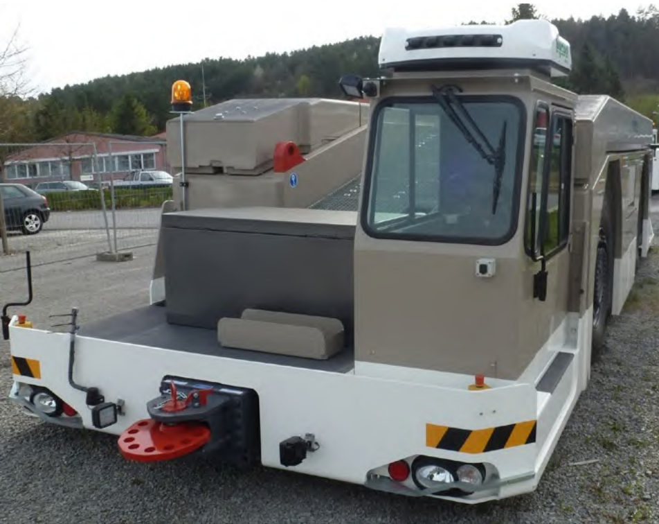
Abb. 98 Flugzeugschlepper mit Klimaanlage
