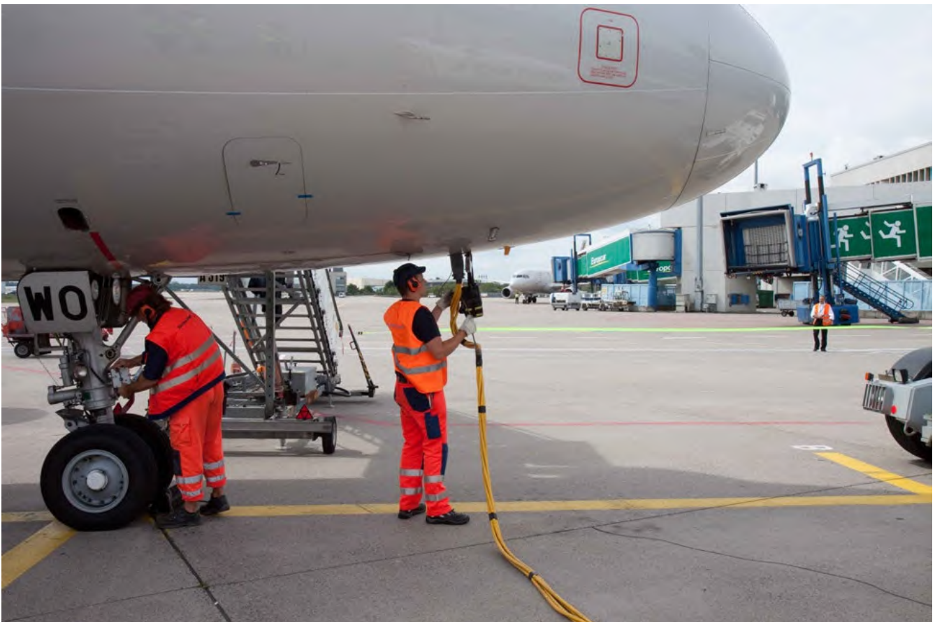
Abb. 31 Anschließen der Ground Power Unit (GPU)
