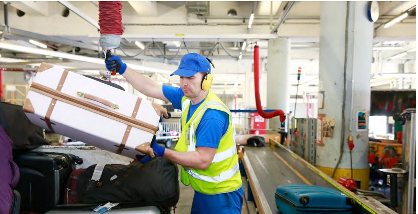
Abb. 65 Arbeiten mit Vakuum-Hebehilfe
