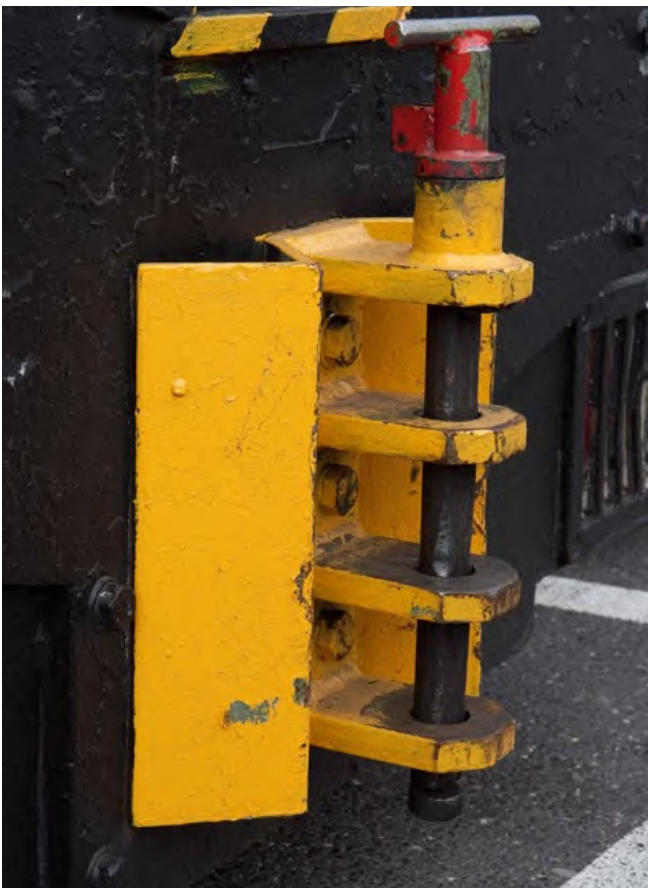
Abb. 59 Aufprallblech an Zugeinrichtung
