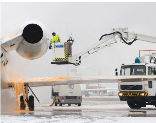
Abb. 88 a und b Enteiserverfahrzeuge im Einsatz: links mit offenem Korb, rechts mit geschlossener Kabine
