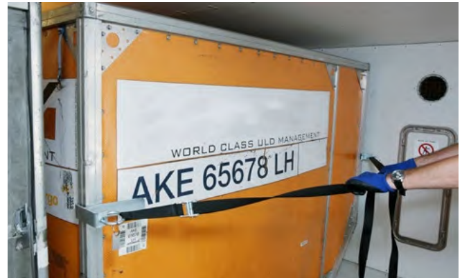
Abb. 52 Zurrgurt zum Verladen von Containern
