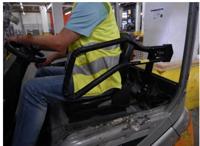
Abb. 71 Rückhalteeinrichtung am Flurförderzeug
