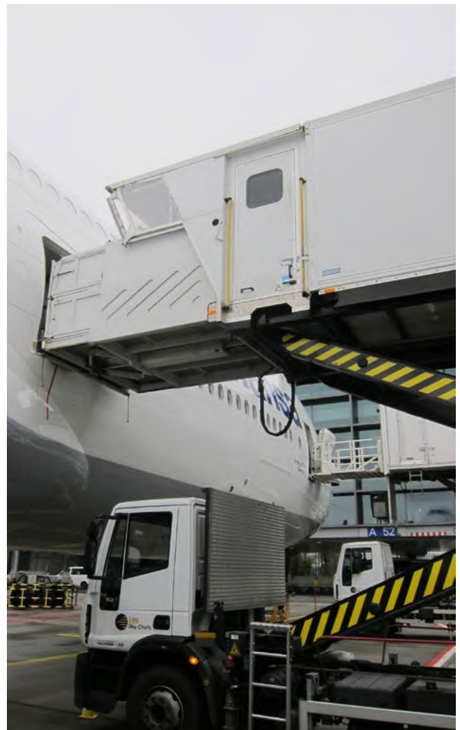
Abb. 77 Catering-Hubfahrzeug mit breiter Plattform
