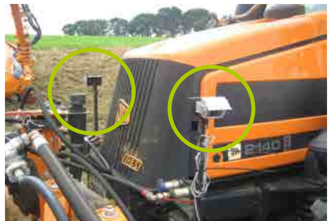
Abb. 27 Einsatz von Kameras bei Überschreitung zulässiger Vorbaumaße
