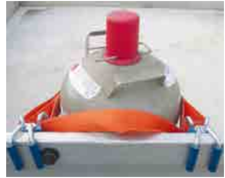
Abb. 145 Ordnungsgemäß gesicherte Flüssiggasflasche mit Ventilschutzkappe
