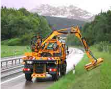
Abb. 52 Alternative am Hang: Auslegermähwerk
