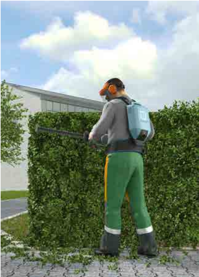
Abb. 67 Ergonomisch vorteilhaft: Heckenschere mit rückentragbarem Akku
