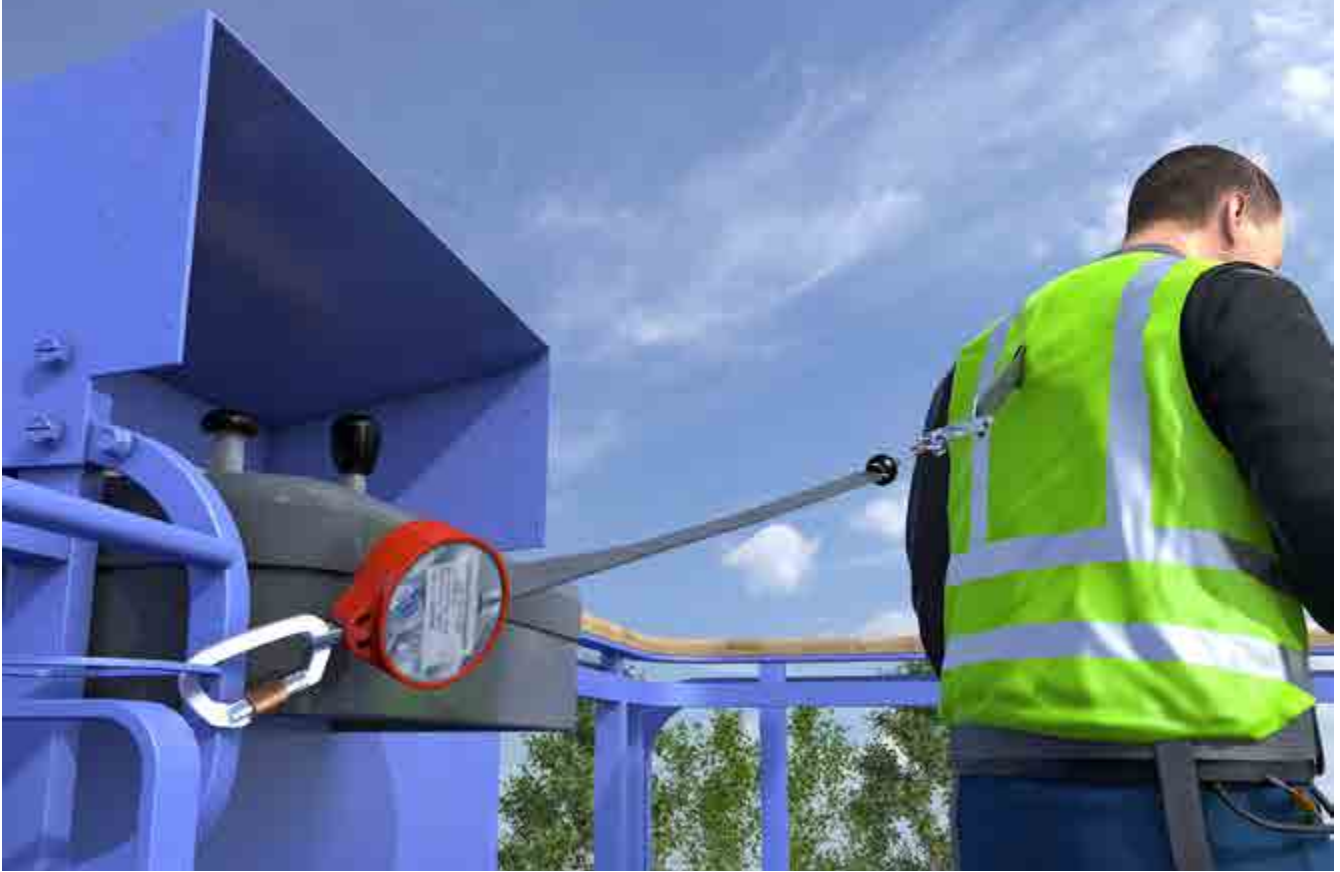
Abb. 121 PSAgA im Arbeitskorb
