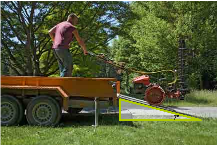
Abb. 148 Ladeschienen mit einem maximalen Ladewinkel von 17°
