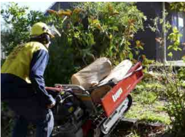
Abb. 152 Mini-Dumper/Motorschubkarre für ergonomischen Materialtransport im Gelände
