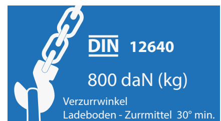
Abb. 159 Kennzeichnung eines Zurrpunktes
