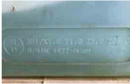
Abb. 144 UN-Zulassung für Gefahrgüter auf einem Kunststoffkanister
