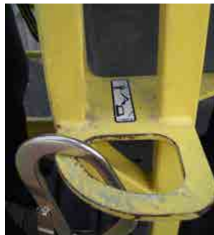
Abb. 122 Anschlagpunkt für PSAgA im Arbeitskorb
