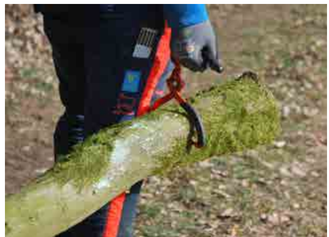
Abb. 154 spezielle Greif- oder Packzange für den ergonomischen Transport von Stammabschnitten
