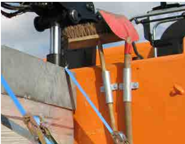
Abb. 163 Formschlüssige Sicherung von Besen und Schaufel an einer Pritschenstirnwand
