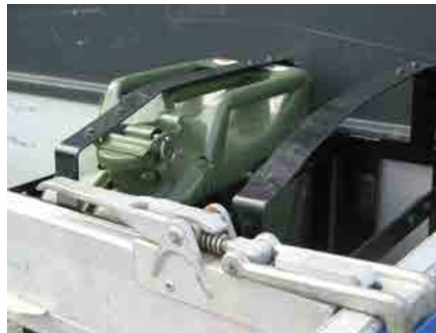
Abb. 164 Sicherung von Kraftstoffbehältnissen durch Formschluss
