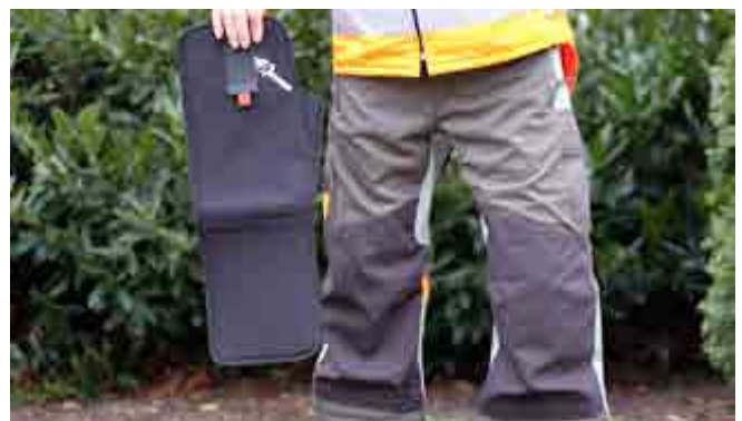
Abb. 68 Hosen mit Schnittschutzprotektoren für den Heckenschnitt
