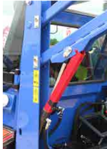
Abb. 42 Sicherungs eines ausgefahrenen Zylinders
