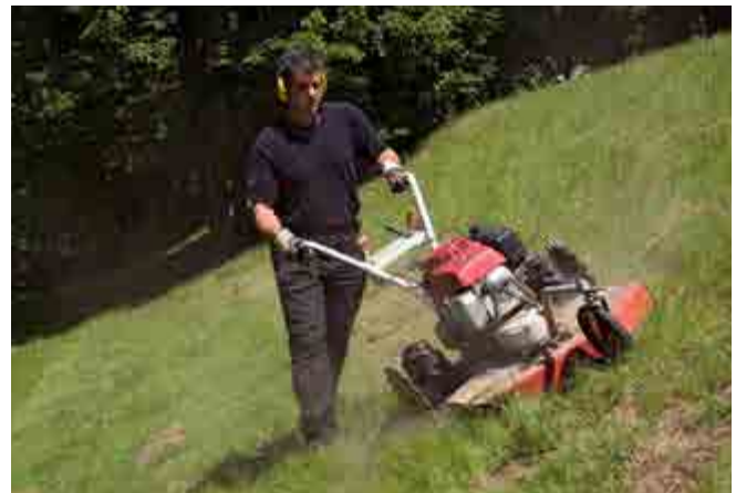
Abb. 55 Mäher mit Stachelrädern
