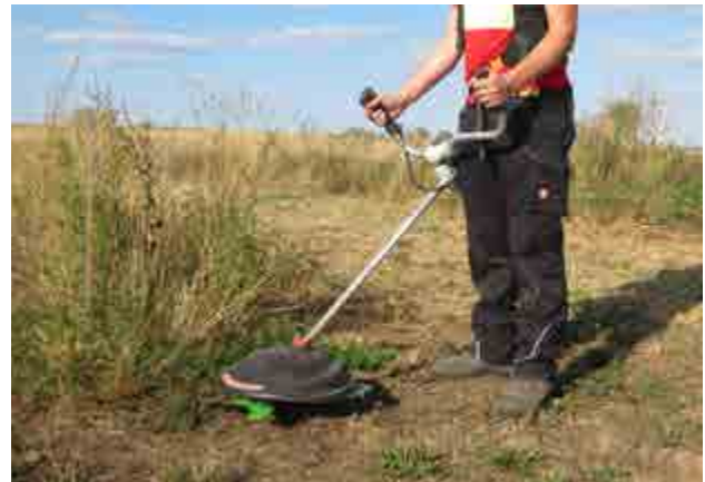
Abb. 58 Luftkissenprinzip und spezielle Schutzhaube
