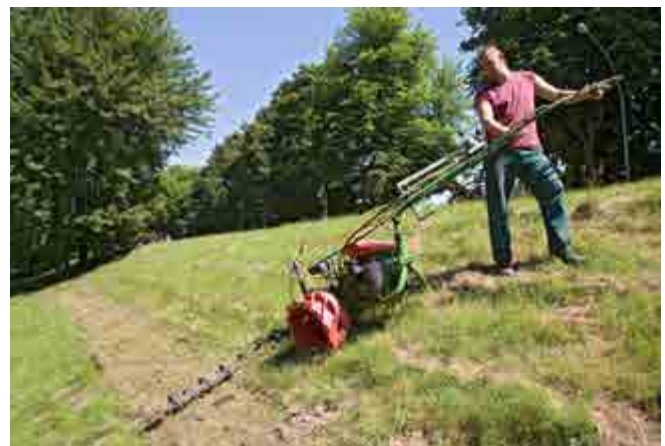
Abb. 56 Mähbalken mit Gitterrädern
