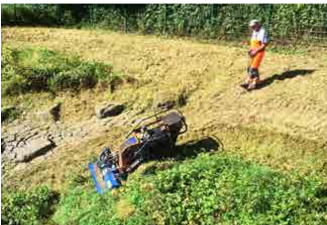
Abb. 51 Ferngesteuertes Mähgerät am Hang
