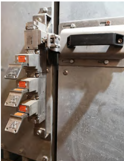
Abb. 13 Schlüsseltransfersystem, Zuhaltung an einer Gehegetür
