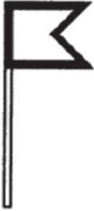
Kennzeichnung der Gleisseite, nach der beim Ertönen der Rottenwarnsignale Ro 2 und Ro 3 die Arbeitsgleise zu räumen sind.
