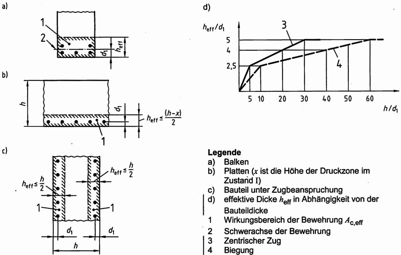
**Bild 53 — Wirkungskbereich  $A_{c,\text{eff}}$  der Bewehrung**
