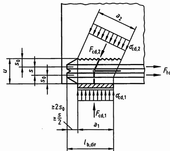
Bild 49 — Knotenbereich für den Nachweis von Druck-Zug-Knoten
