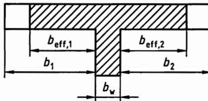
**Bild 2 — Definition der mitwirkenden Breite  $b_{\text{eff}}$**
