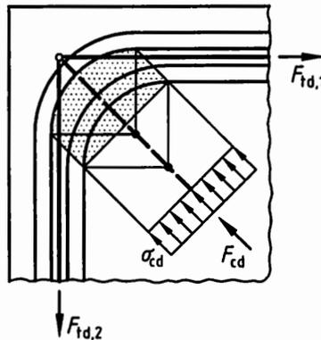
Bild 50 — Knoten mit Umlenkung von Bewehrung
