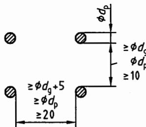
**Bild 65 — Lichter Mindestabstand für Spannglieder im sofortigen Verbund**
