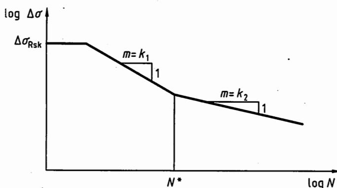
Bild 52 — Form der Wöhlerlinien für Beton- und Spannstahl
