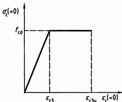
**Bild 24 — Bilineare-Spannungs-Dehnungs-Linie**
