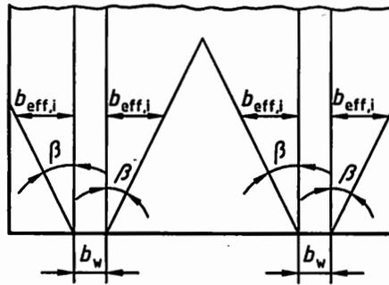
Bild 5 — Ausbreitungswinkel konzentriert eingeleiteter Längskräfte
