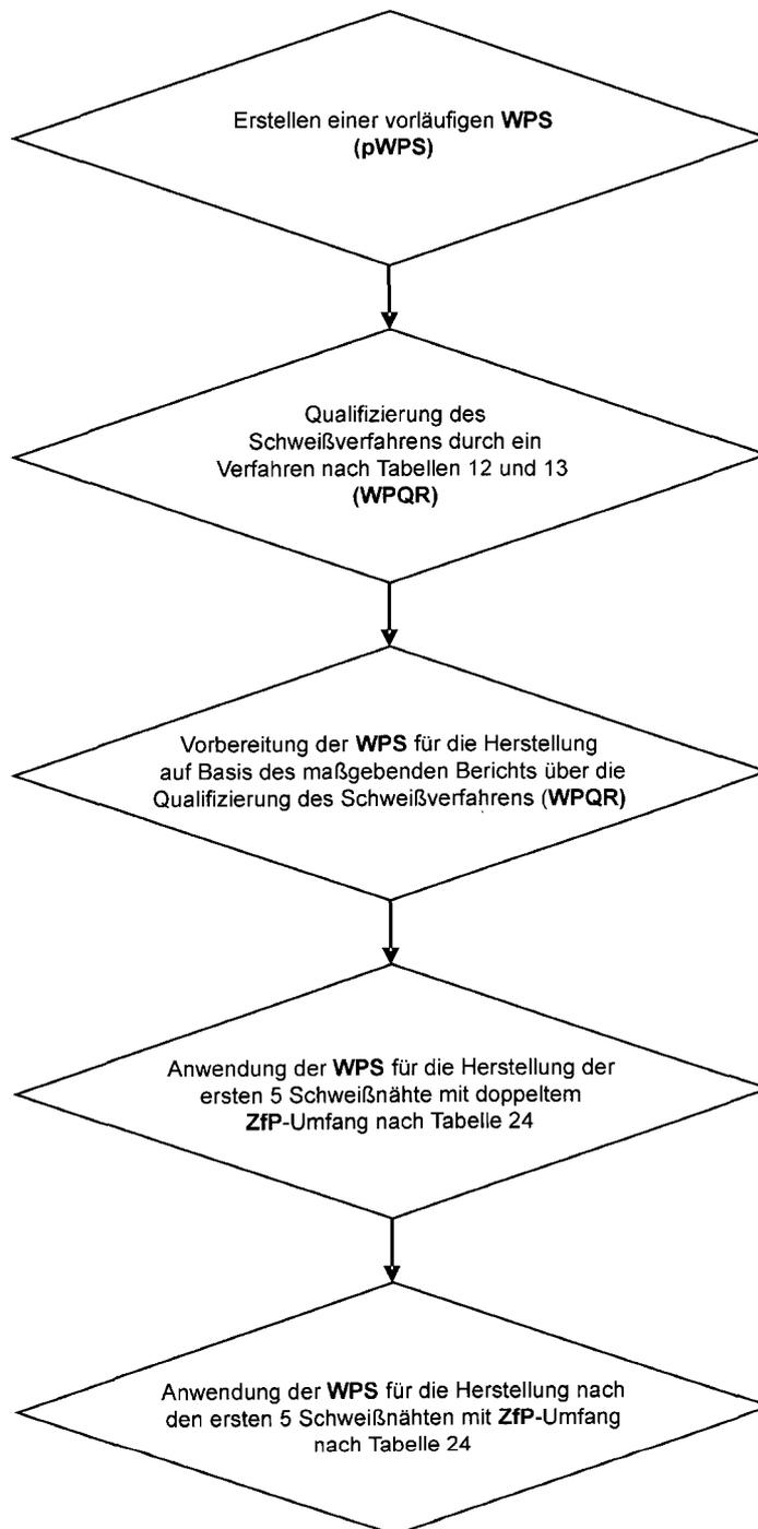
Bild L.1 — Flussdiagramm zur Erstellung und Verwendung einer WPS
