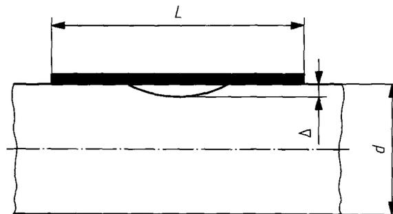
Charakteristische Querschnittsabmessung des Profils ist  $d$
