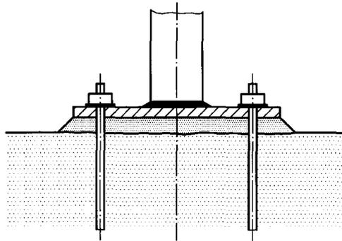
**Bild 6 — Vergießen unter einer Fußplatte**
