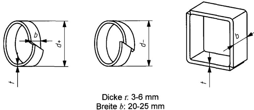
**Bild E.9 — Geeignete ring- oder bandförmige Schweißbadsicherungen**
