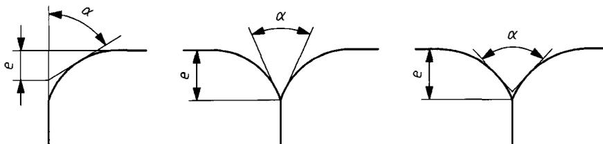
Bestimmung der maximalen effektiven Tiefe der Naht,  $\alpha$ , ohne Einbrand für einen eingeschlossenen Winkel  $\alpha$ , von  $60^\circ$ .
