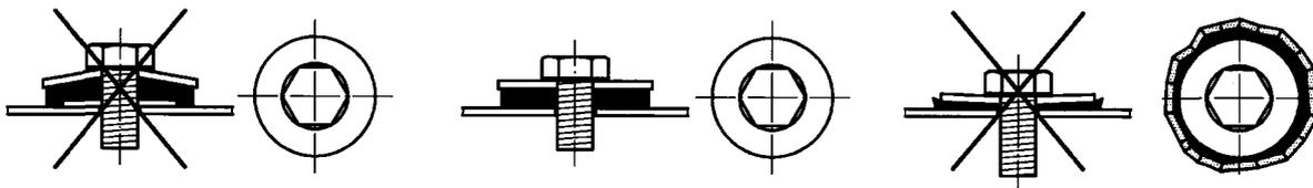
**Bild 5 — Anleitung für die Eindrückung von Dichtscheiben**
