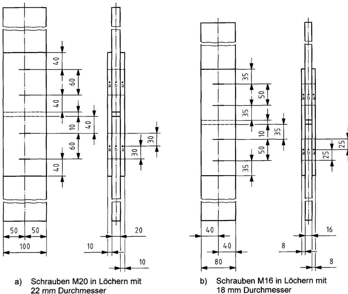
**Bild G.1 — Standardprüfkörper zur Prüfung der Haftreibungszahl**
