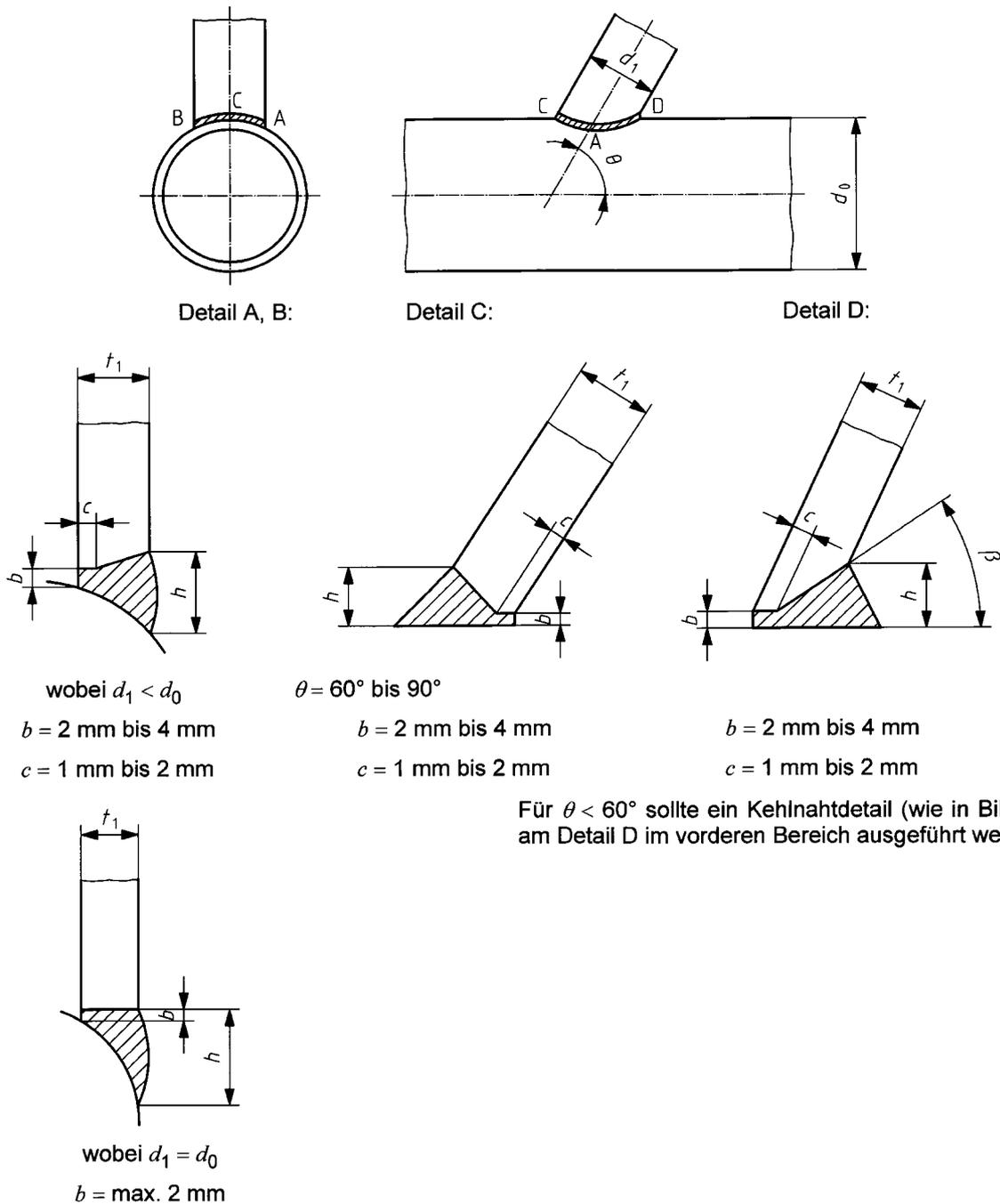
Für  $\theta < 60^\circ$  sollte ein Kehlnahtdetail (wie in Bild E.3) am Detail D im vorderen Bereich ausgeführt werden.
