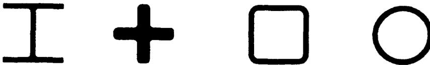
d) Beispiele für Querschnitte von Stahlpfählen
