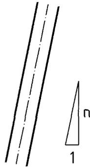
Bild 2 — Definition der Neigung von Mikropfählen
