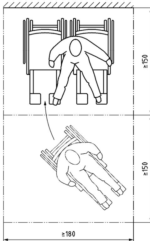
**Bild 9 — Platzbedarf für den Rollstuhlstellplatz einer Person, Bewegungsfläche für Rangieren und Wechsel**
