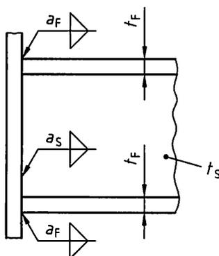
Bild 31 — Trägeranschluss oder -querstoß ohne weiteren Tragsicherheitsnachweis
