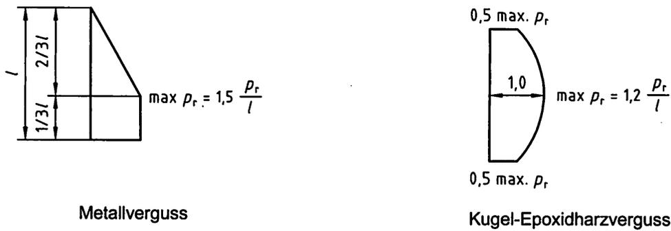
Bild 32 — Verteilung der Ringzugkraft über die Länge des Verankerungskopfes
