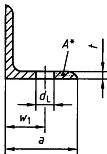
**Legende**für Gleichung (28):  $A_{\text{Netto}} = 2 A^*$ **Bild 15 — Nettoquerschnitt eines Winkelanschlusses****(744) Krafteinleitungen**
