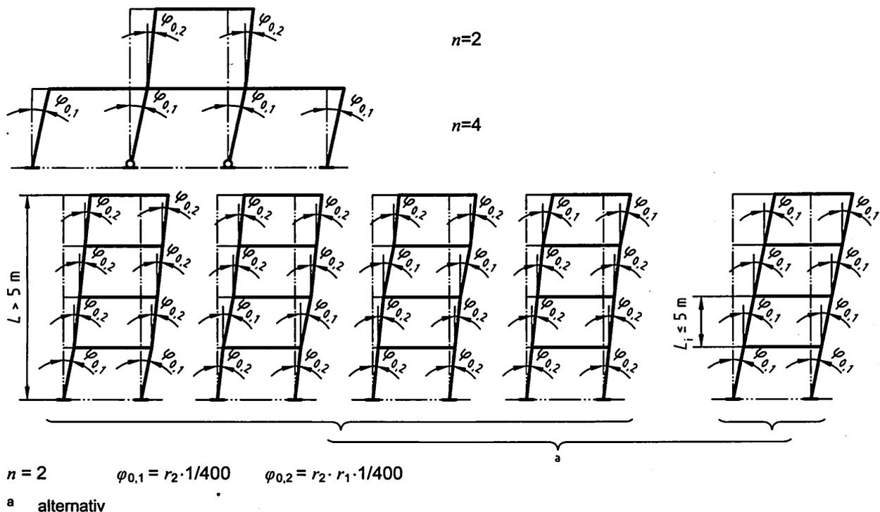
**Bild 13 — Beispiele für Vorverdrehungen in Stabwerken**
