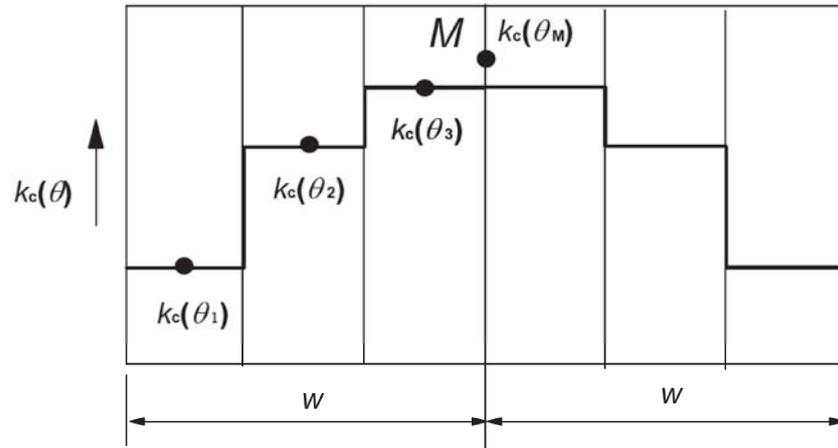
**Bild B.4 — Unterteilung einer von beiden Seiten brandbeanspruchten Wand in Zonen für die Berechnung der Festigkeitsreduktion und  $a_z$ -Werte**
