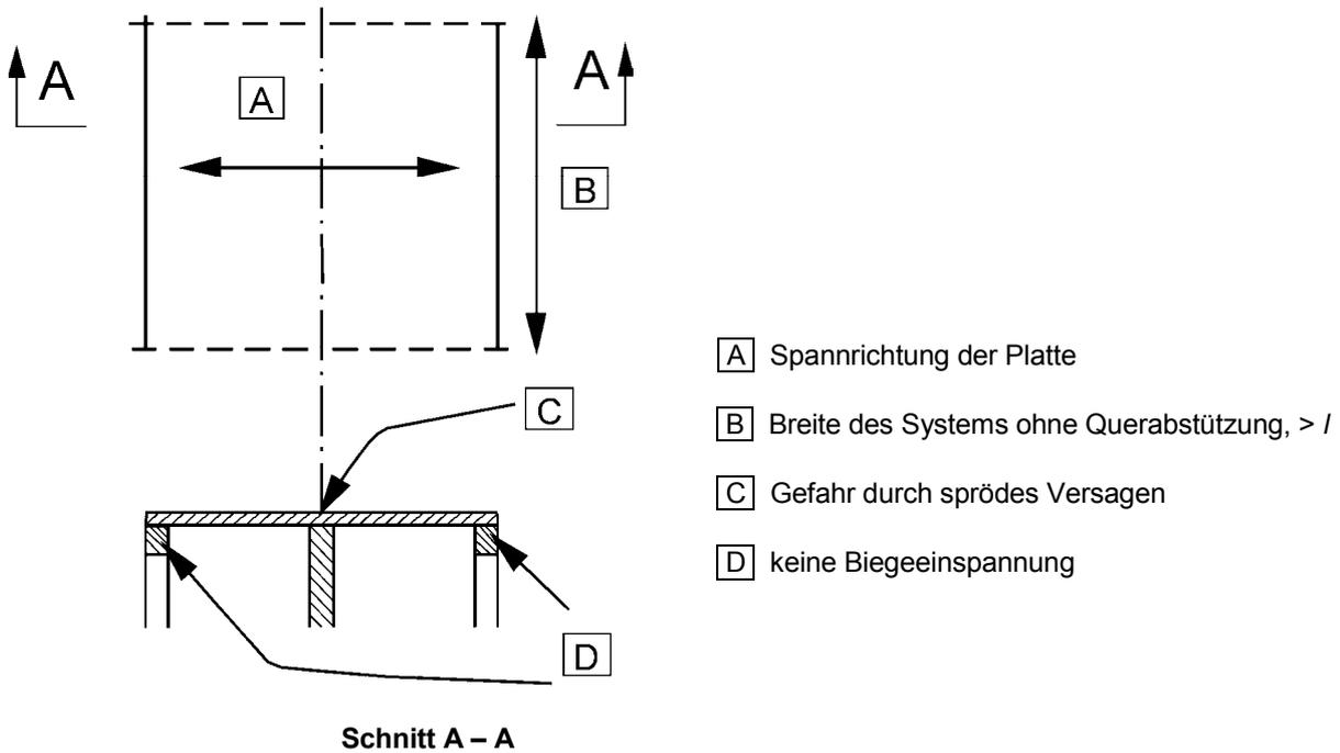
**Bild 5.8 — Plattensysteme, für die entsprechend 5.7.3 (3) ein Mindestbewehrungsquerschnitt angeordnet werden sollte**
