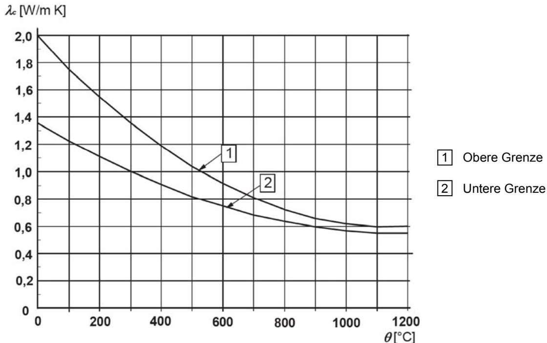
**Bild 3.7 — Thermische Leitfähigkeit von Beton**
