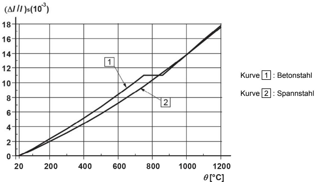
**Bild 3.8 — Gesamte thermische Verlängerung von Stahl**
