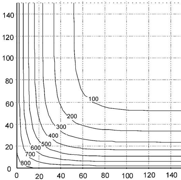
**Bild A.11 — Temperaturprofile (°C)  $\langle AC \rangle$  für mehrseitig brandbeanspruchte Bauteile  $\langle AC \rangle$ ,  $h \times b = 300 \times 300 - R 30$**
