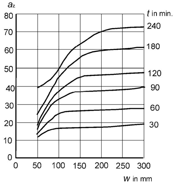
**b) Reduktion  $a_z$  des Querschnitts eines Balkens oder einer Platte mit quarzhaltigem Zuschlag**
