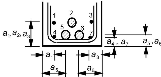
Bild 5.3 — Maße zur Berechnung des mittleren Achsabstandes  $a_m$
