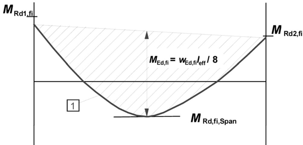
1 Freies Biegemoment unter gleichförmig verteilter Last im Brandfall
