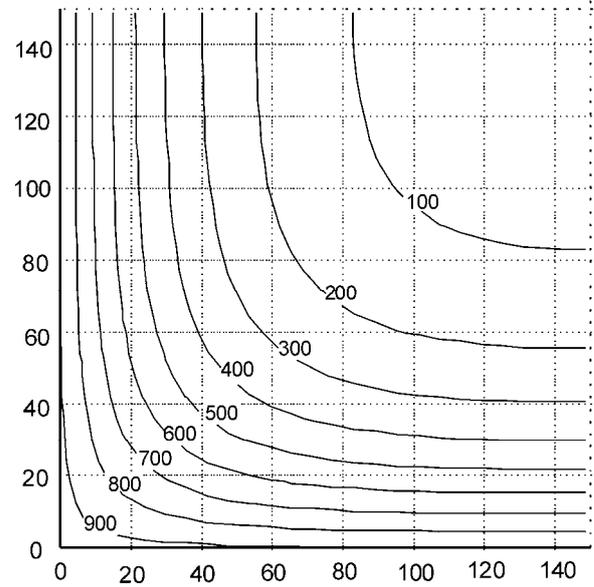
**Bild A.12 — Temperaturprofile (°C)  $\langle AC \rangle$  für mehrseitig brandbeanspruchte Bauteile  $\langle AC \rangle$ ,  $h \times b = 300 \times 300 - R 60$**
