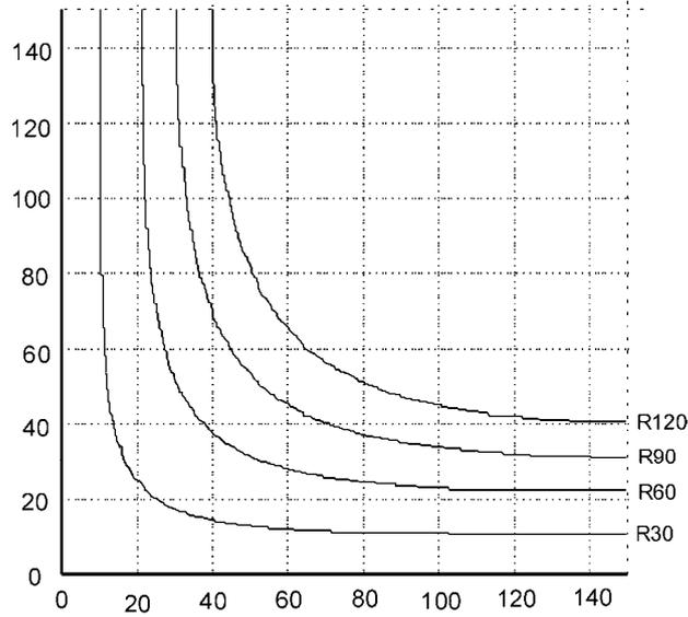
**Bild A.15 — 500 °C-Isotherme für** AC **für** AC **mehrseitig brandbeanspruchte Bauteile** AC,
