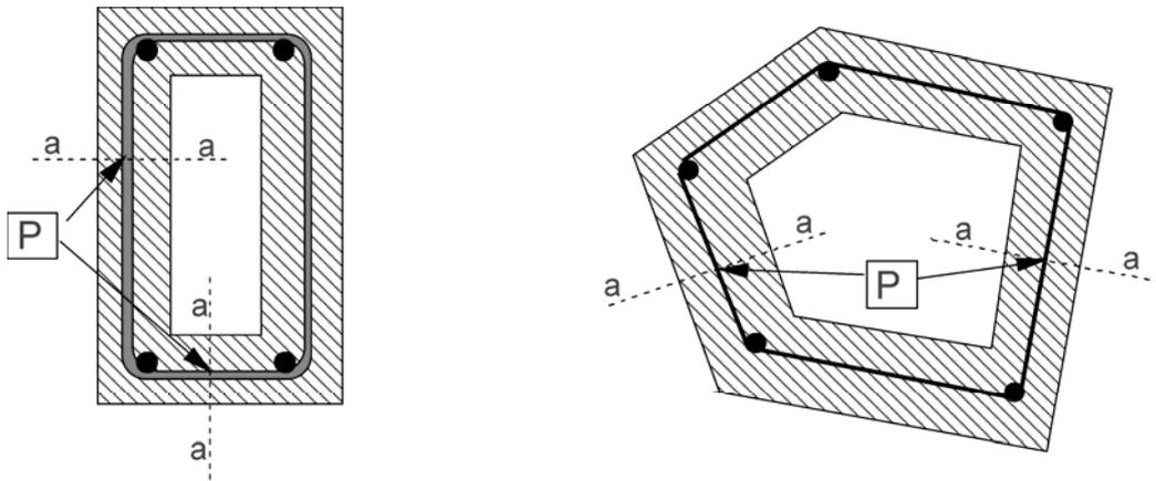
**Bild D.3 — Die Referenztemperatur  $\theta_p$  sollte an den Punkten **P** entlang der Linie a -a für die Berechnung des Torsionswiderstandes ausgewertet werden**
