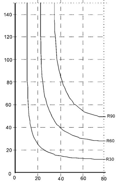
**Bild A.6 — 500°C-Isothermen für einen Balken,  $h \times b = 300 \times 160$**
