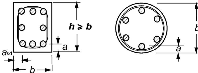
**Bild 5.2 — Bauteilquerschnitte mit Achsabstand a**
