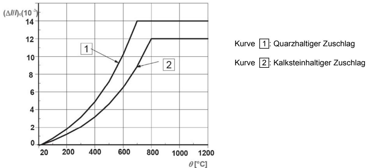
**Bild 3.5 — Gesamte thermische Verlängerung von Beton**
