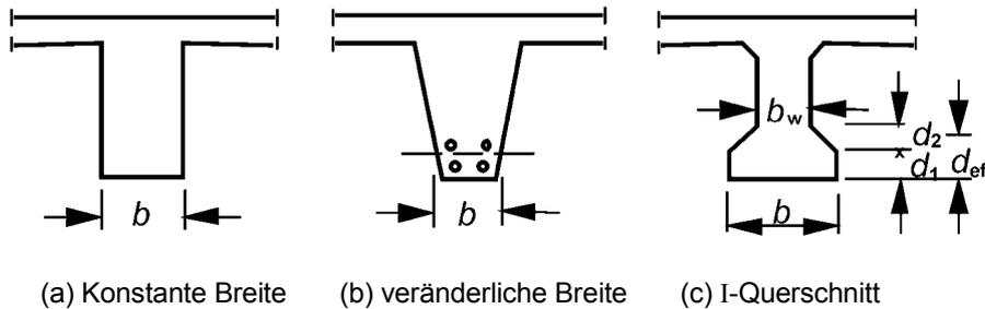
**Bild 5.4 — Definition der Maße für verschiedene Balkenquerschnitte**
