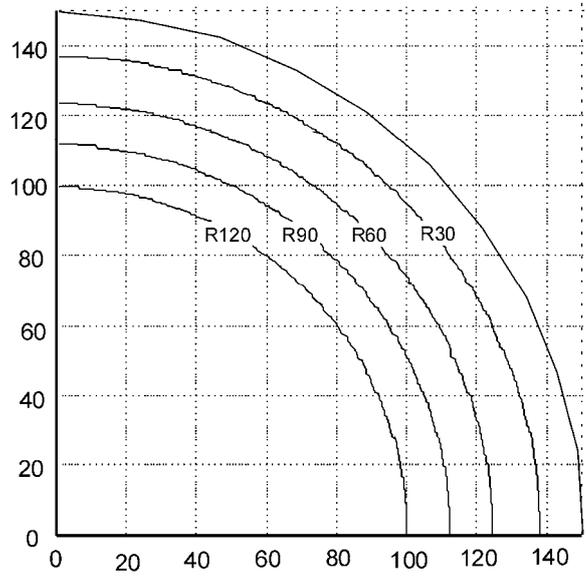
**Bild A.20 — 500 °C-Isotherme  $\square_{AC}$  für mehrseitig brandbeanspruchte Bauteile  $\square_{AC}$ ,
