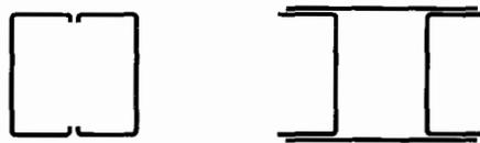
c) Geschlossene, zusammengesetzte Querschnitte
