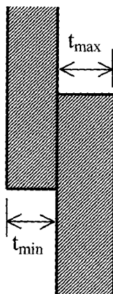
Bild D.8 — Schale mit Überlappstoß
