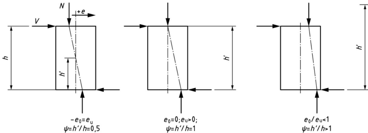
ANMERKUNG Die Lastausmittungen sind dabei vorzeichenrichtig (positiv in Richtung und Orientierung der angreifenden Horizontallast  $V$  am Wandkopf) ausgehend von der Wandlänglenmitte in Gleichung (NA.K.2 und 3) einzusetzen.
