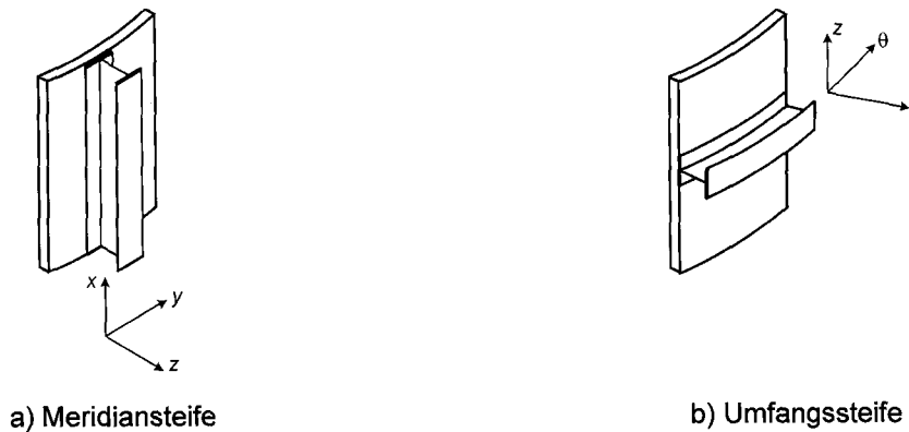
Bild 1.5 — Lokales Koordinatensystem für Meridiansteifen und Umfangssteifen bei einer Schale
