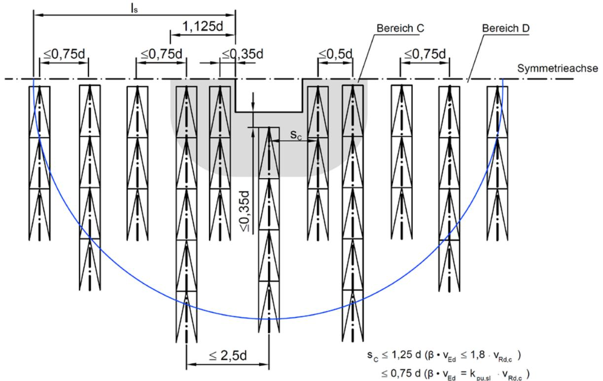
**Abbildung 3.1:** Maximale Abstände der Durchstandsbewehrungselemente in Flachdecken
