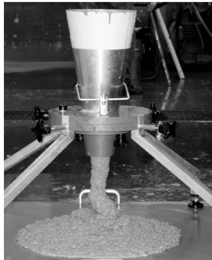
**Bild M.2 – Auslaufkegel auf einem Aufnahmeständer und Bodenplatte**
