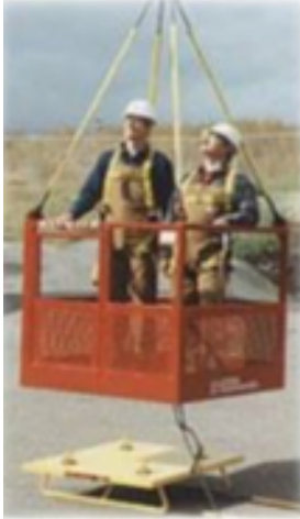
Vom Kran mittels eines Anschlagmittels (Lastaufnahmemittel) angehobener Ar- beitskorb
