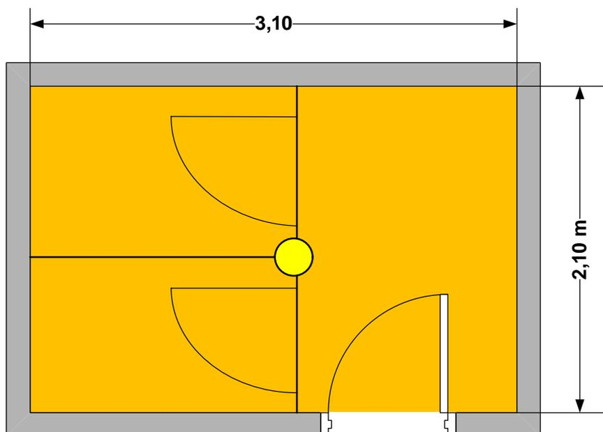
Abbildung 18: Sanitärraum1 LED-Leuchte 21,5 W / 2.600 lm
