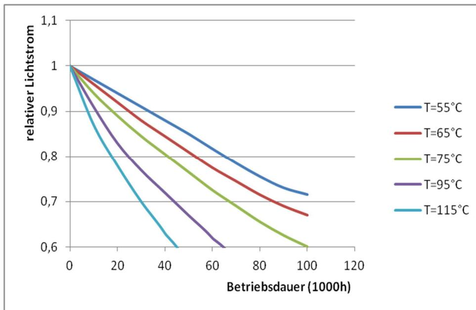
Abbildung 6: Beispielhafte relative Lichtströme in Abhängigkeit von der Junction-Temperatur und Betriebsdauer [44].
