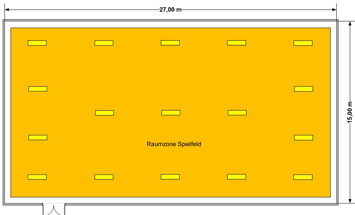
Abbildung 15: Beleuchtung einer Turnhalle 14 m x 26 m
