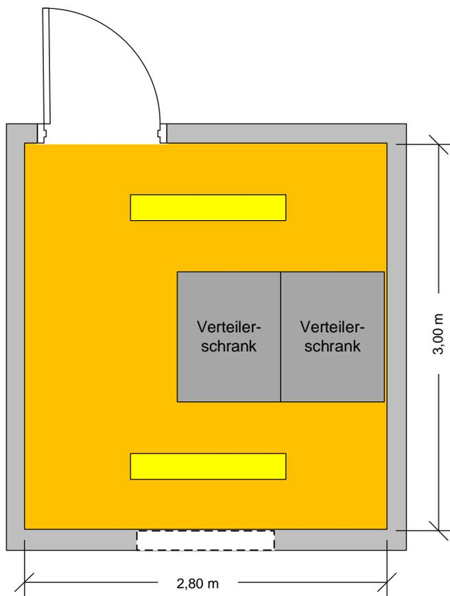
Abbildung 19: Datenverteilterraum
