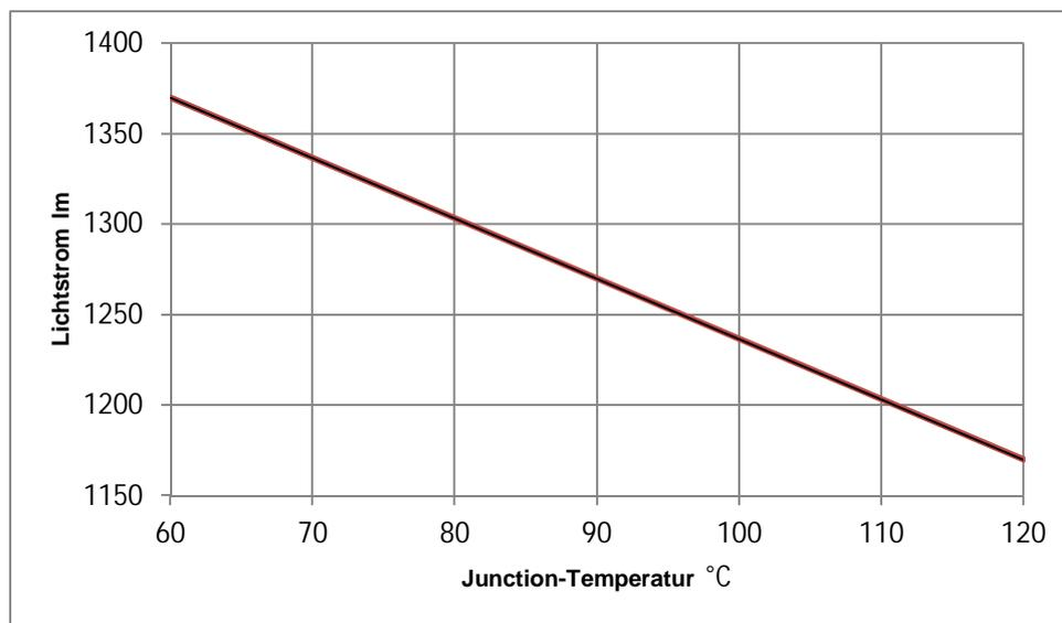
Abbildung 5: Beispielhafter Lichtstrom in Abhängigkeit von der Junction-Temperatur [44].
