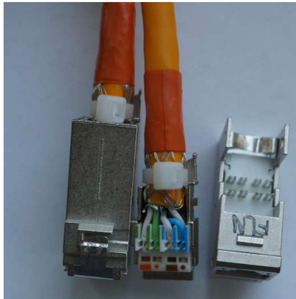
Abbildung 20: Aufgelegte Datenkabel, links geschlossene, rechts geöffnete Anschlussbuchse
