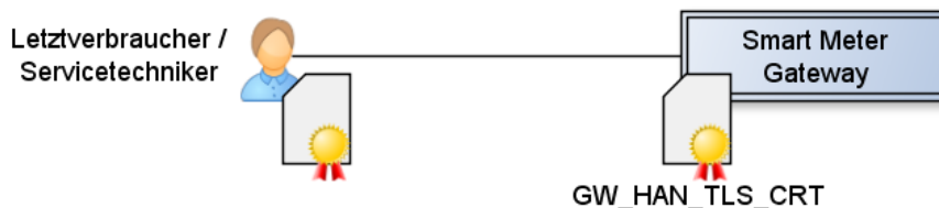
Abbildung 3.13. Authentifizierung des Anschlussnutzers/Servicetechnikers mittels HAN-TLS-Client-Zertifikat
