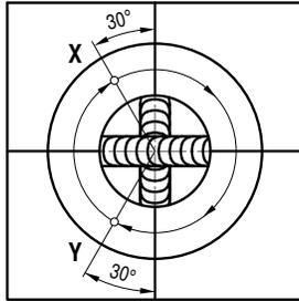
**Bild B-3:** Schweißen des Prüfstücks
