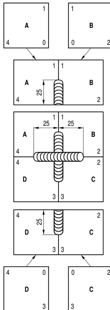
**Bild B-2:** Vorbereiten des Prüfstückes
