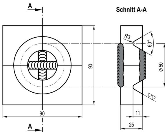
**Bild B-1:** Prüfstückform
