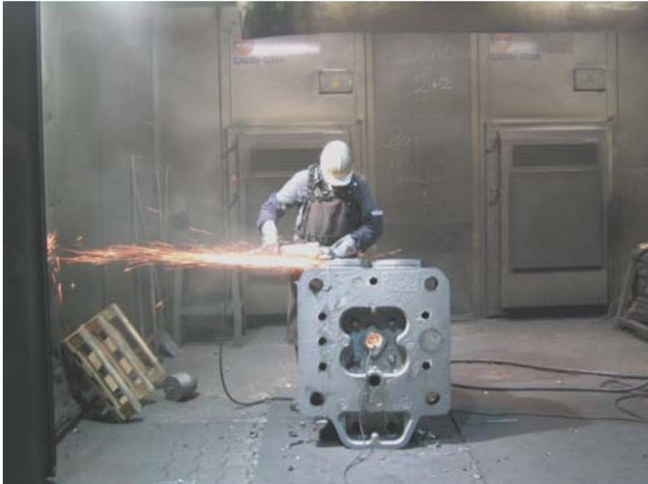
**Abbildung 3: Putzarbeiten in einer Arbeitskabinen (Quelle: Regierungspräsidium Kassel)**
