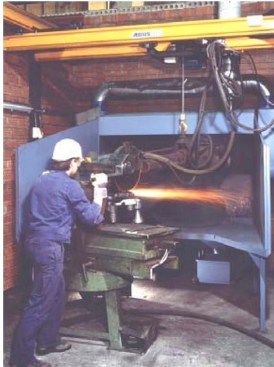
**Abbildung 7: Wirbelzylinder als Schleifplatzabsaugung an einer Pendelschleifmaschine (Quelle: Kessler + Luch Entwicklungs- und Ingenieurgesellschaft, Gießen)**
