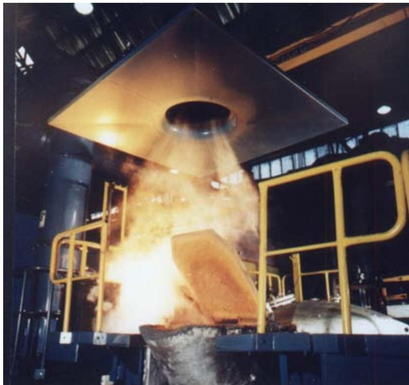
**Abbildung 5: Werksfoto Kessler+Luch – Düsenplatte an einem Schmelzofen**
